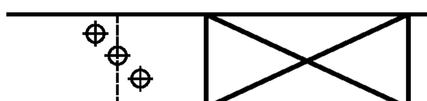
б) измерительная поверхность в форме прямоугольного параллелепипеда перед глушителем
