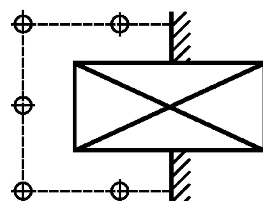
в) полусферическая измерительная поверхность перед глушителем
