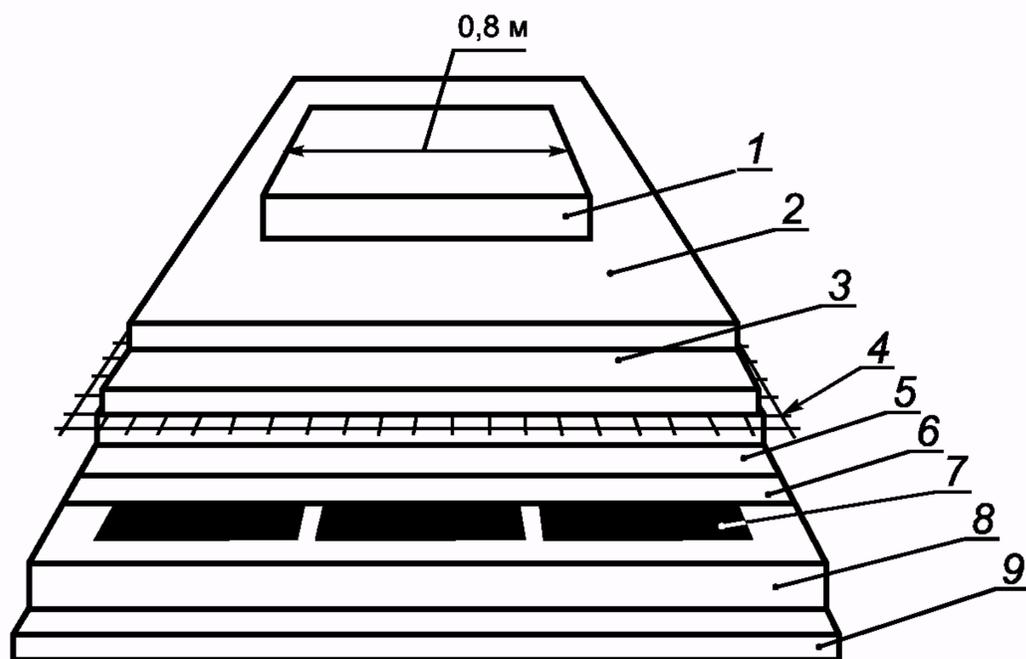
1 — кусок изоляции длиной 0,8 м; 2 — пол; 3 — бетон; 4 — сетка (если предусмотрена); 5 — дополнительный слой (если предусмотрен); 6 — дополнительная электрическая изоляция (если предусмотрена); 7 — **нагревательный блок**; 8 — термоизоляция; 9 — фанера
