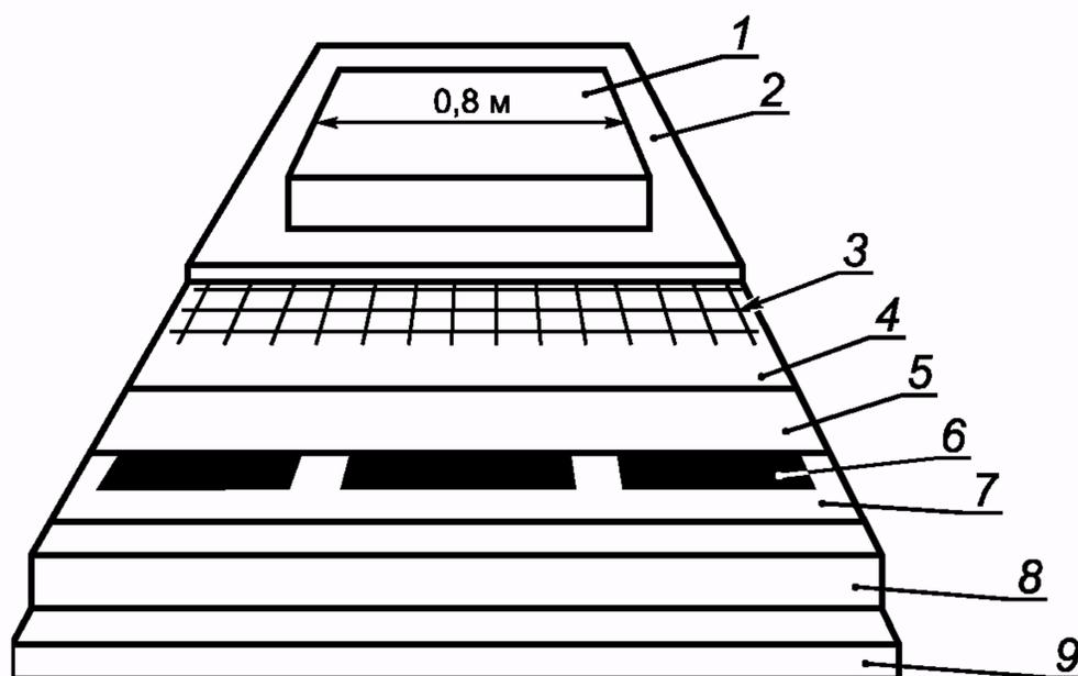
1 — кусок изоляции длиной 0,8 м; 2 — пол; 3 — сетка; 4 — дополнительный слой (если предусмотрен); 5 — дополнительная электрическая изоляция (если предусмотрена); 6 — **нагревательный блок**; 7 — дополнительный слой (если предусмотрен); 8 — термоизоляция; 9 — бетонное основание
