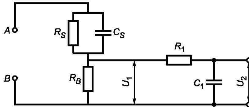
$A, B$  — испытательные зажимы;  $R_S = 1500$  Ом;  $R_B = 500$  Ом;  $R_1 = 10000$  Ом;  $C_S = 0,22$  мкФ;  $C_1 = 0,022$  мкФ
