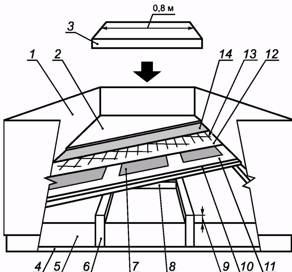
1 — деревянная доска; 2 — пол; 3 — кусок изоляции длиной 0,8 м; 4 — опора для термоизоляции; 5 — термоизоляция; 6 — каркас из бруса размерами 50 · 200 мм; 7 — **нагревательный блок**; 8 — поперечный элемент; 9 — воздушный зазор (если предусмотрен); 10 — фанера; 11 — дополнительный материал (если предусмотрен); 12 — дополнительная электрическая изоляция (если предусмотрена); 13 — сетка; 14 — дополнительный слой (если предусмотрен)
