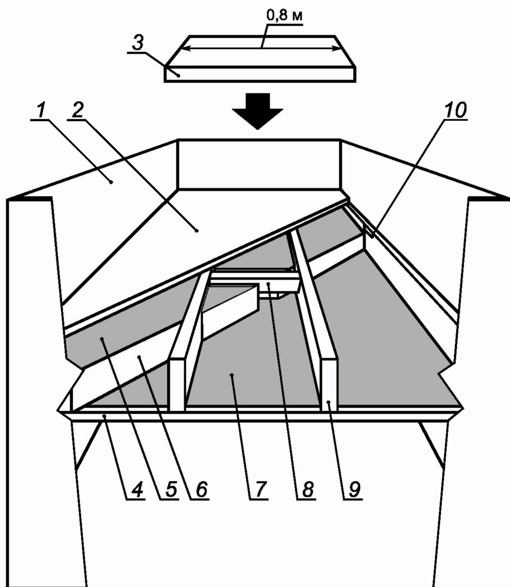
1 — деревянная доска; 2 — пол; 3 — кусок изоляции длиной 0,8 м; 4 — покрытие; 5 — **нагревательный блок** для пола; 6 — термоизоляция; 7 — **нагревательный блок** для потолка; 8 — поперечный элемент; 9 — каркас из бруса размерами 50 · 200 мм; 10 — воздушный зазор
