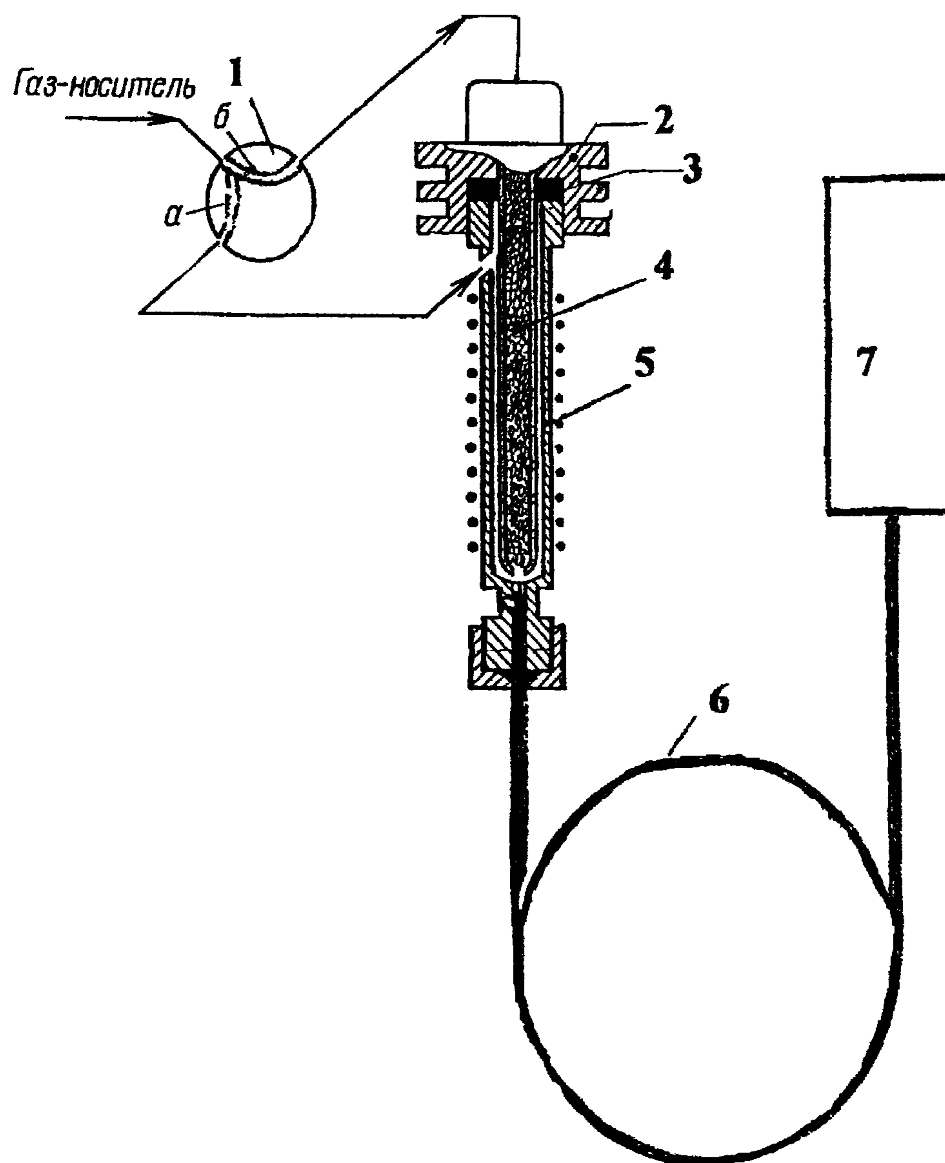
**Рис.** Схема устройства для проведения термодесорбции
