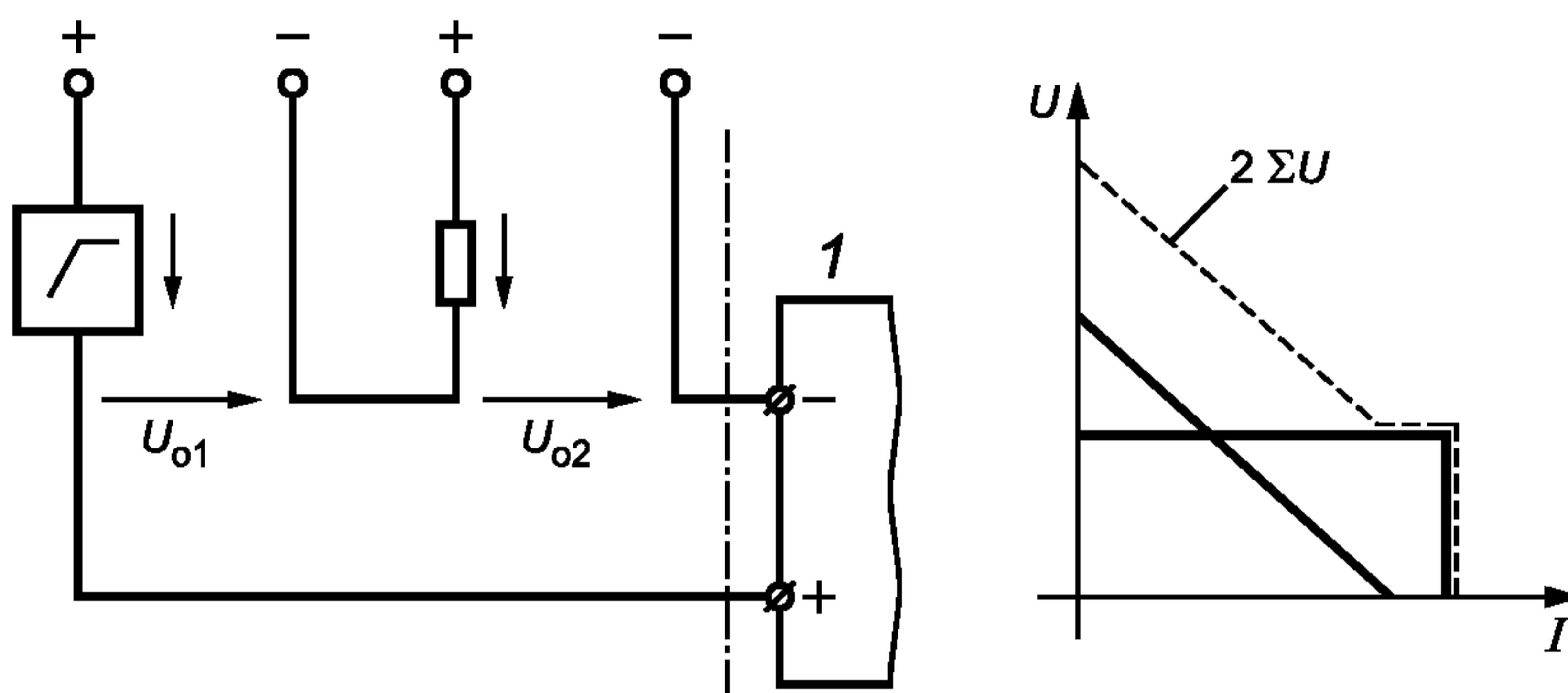
а — Последовательное подключение со сложением значений напряжения
