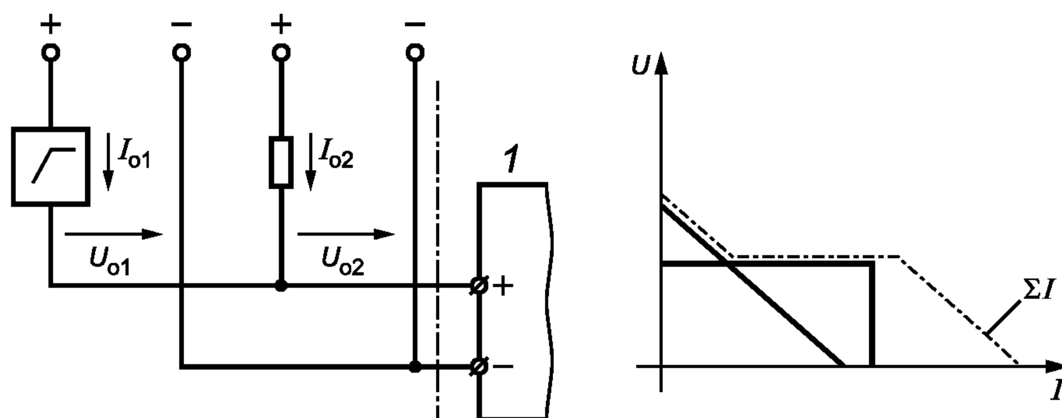
с — Параллельное подключение со сложением значений тока
