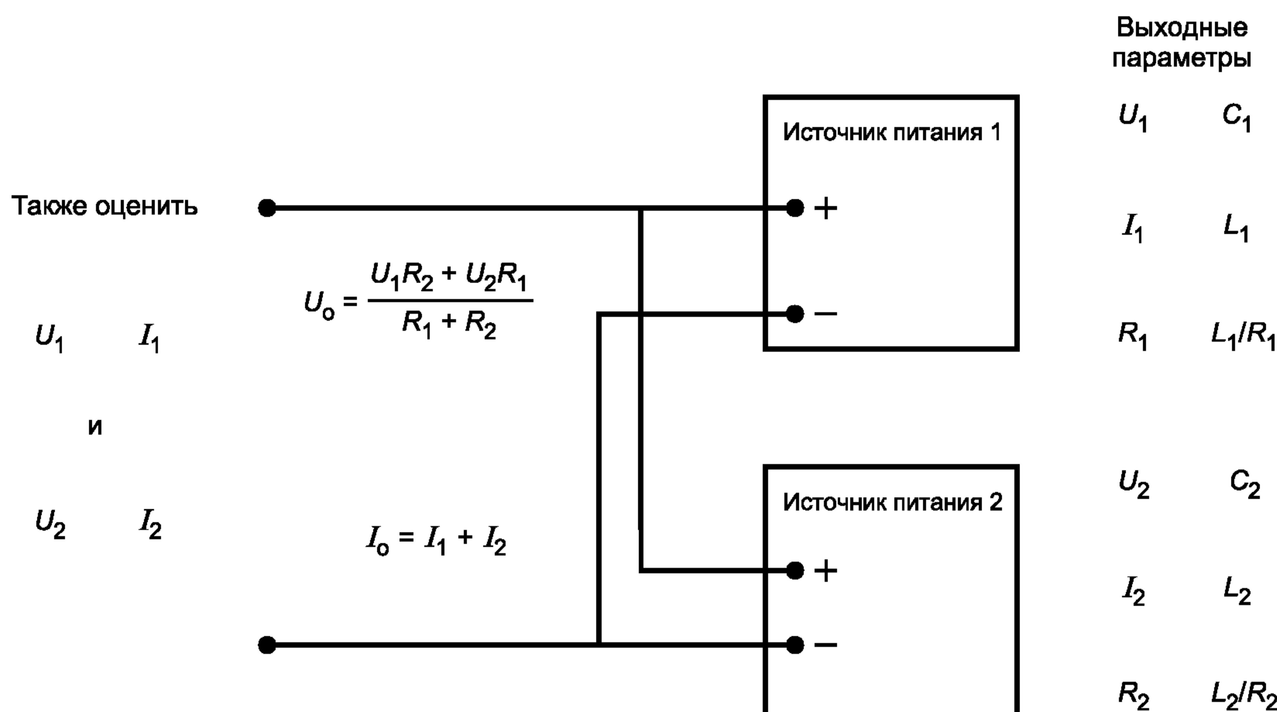
Рисунок В.2 — Параллельно подключенные источники питания
