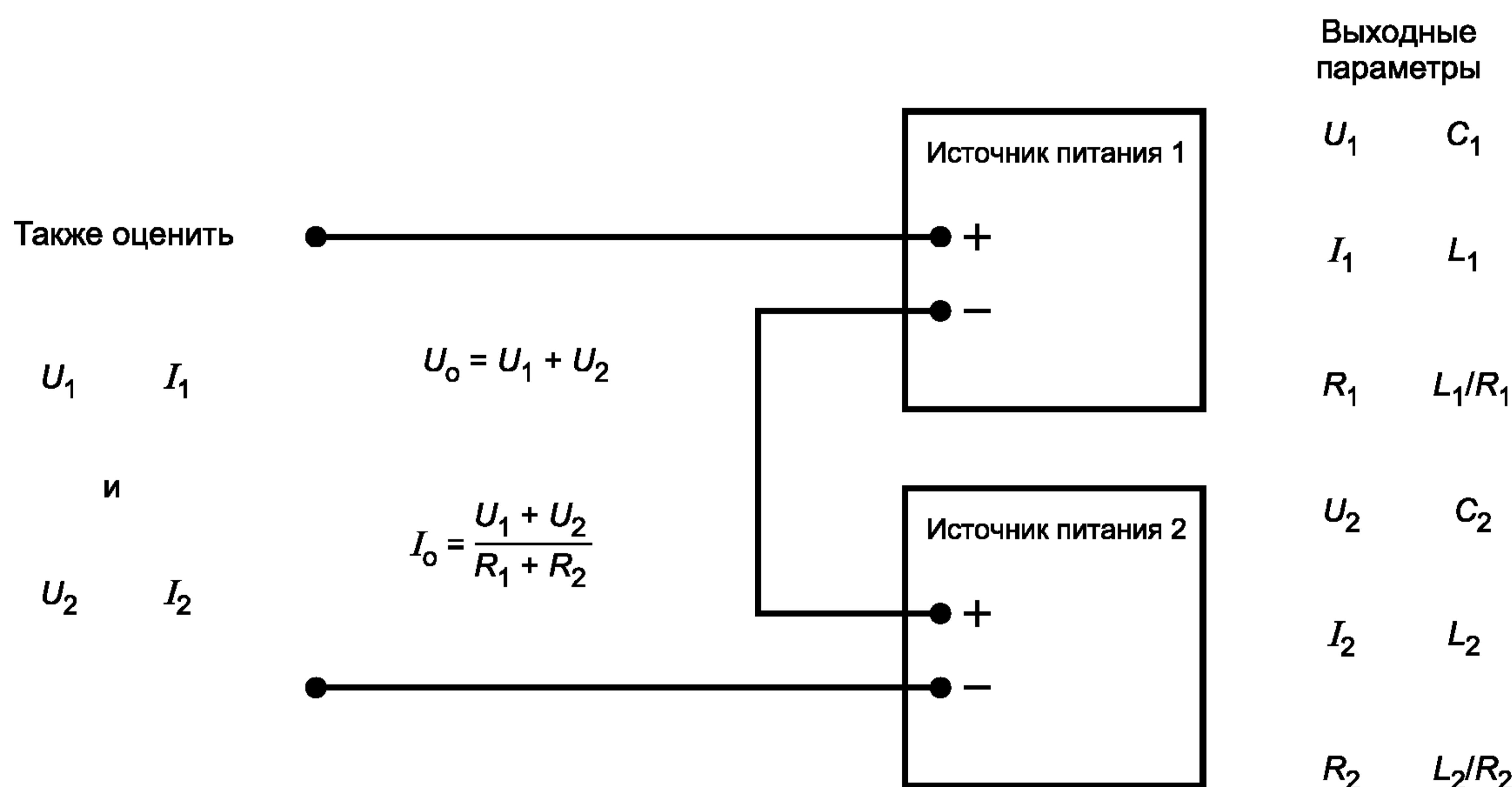
Рисунок В.1 — Последовательно подключенные источники питания
