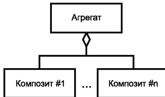
Рисунок А.4 — Отношение агрегирования между UML-классами
