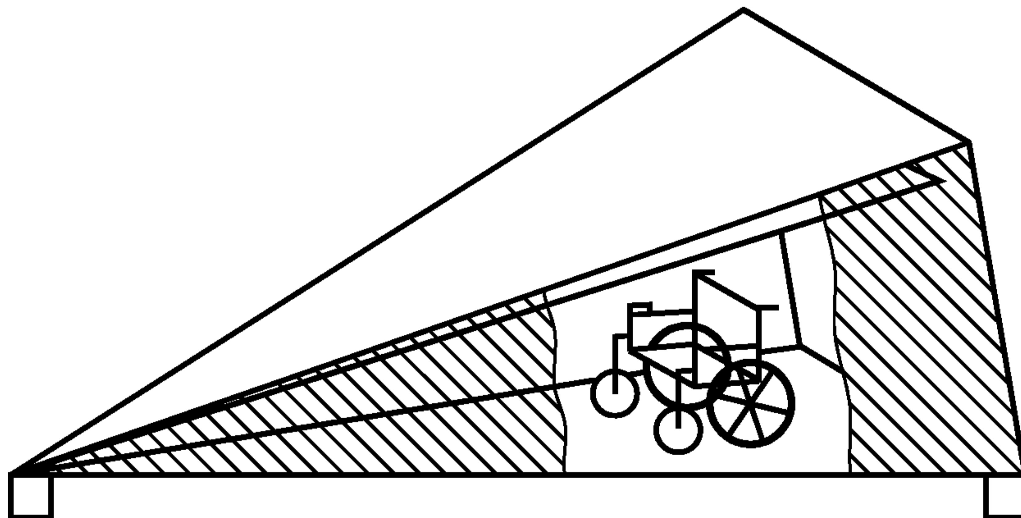
Рисунок 2 — Вертикальная поляризация в GTEM-камере
