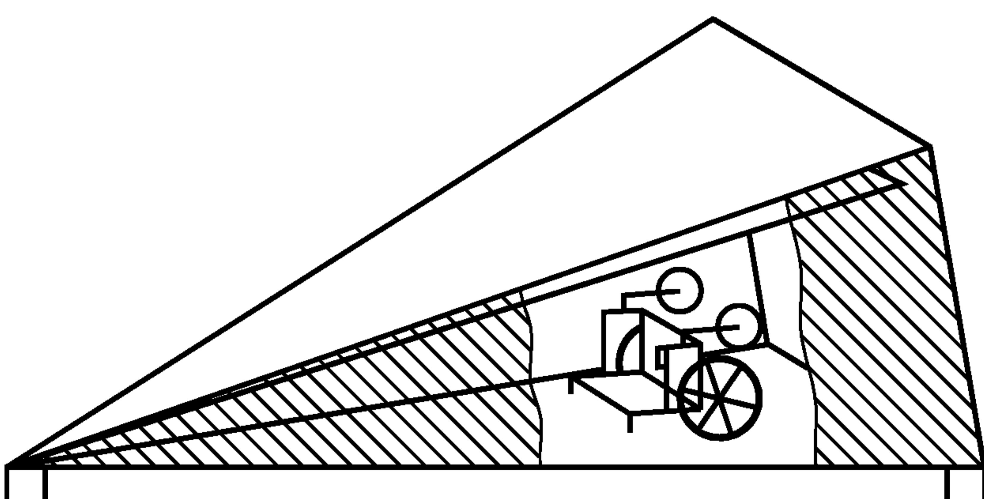
Рисунок 3 — Горизонтальная поляризация в GTEM-камере
