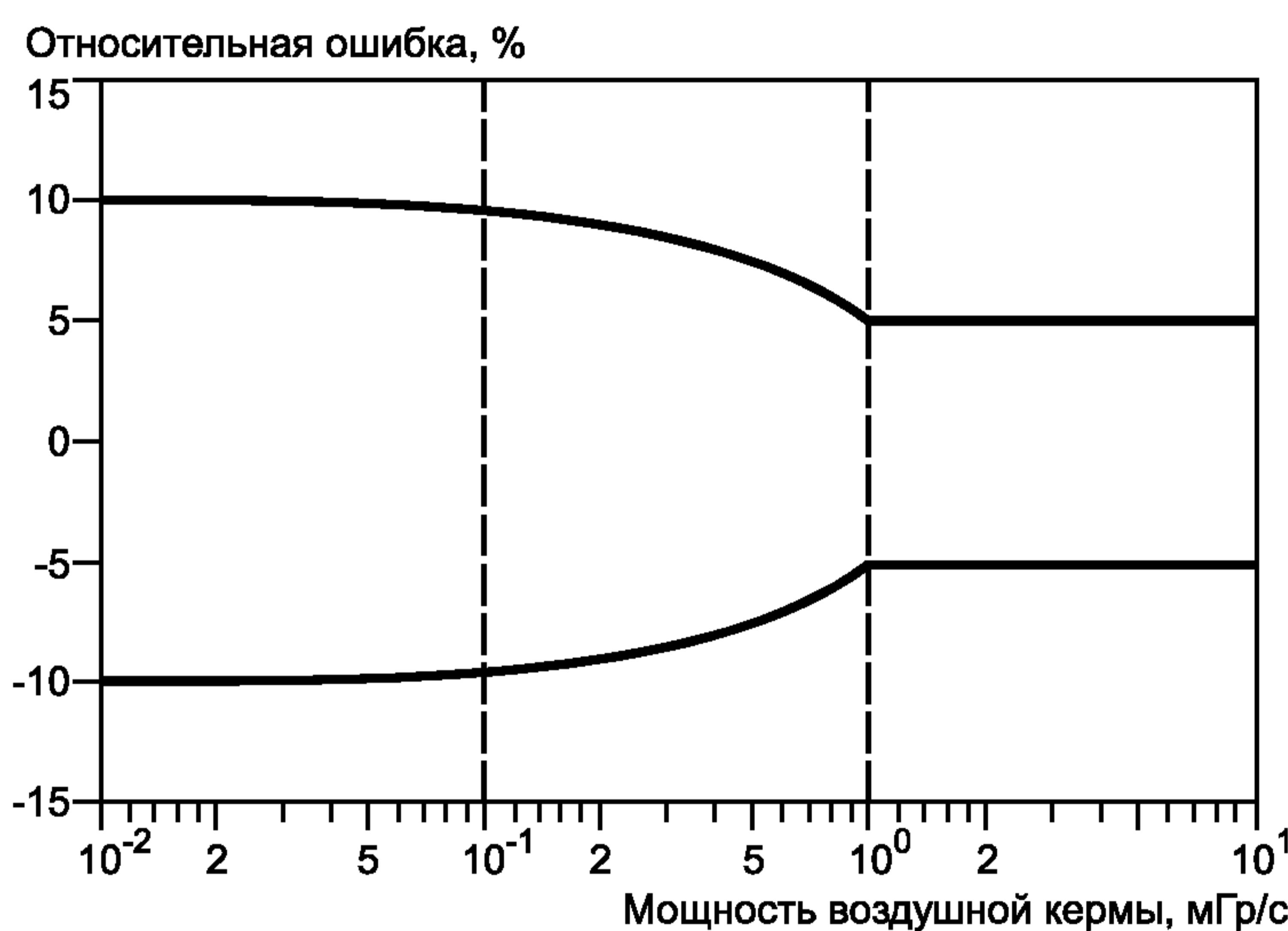
Рисунок 1 — Пределы относительной ошибки измерения для МОЩНОСТИ ВОЗДУШНОЙ КЕРМЫ при ОСЛАБЛЕННОМ ИЗЛУЧЕНИИ
