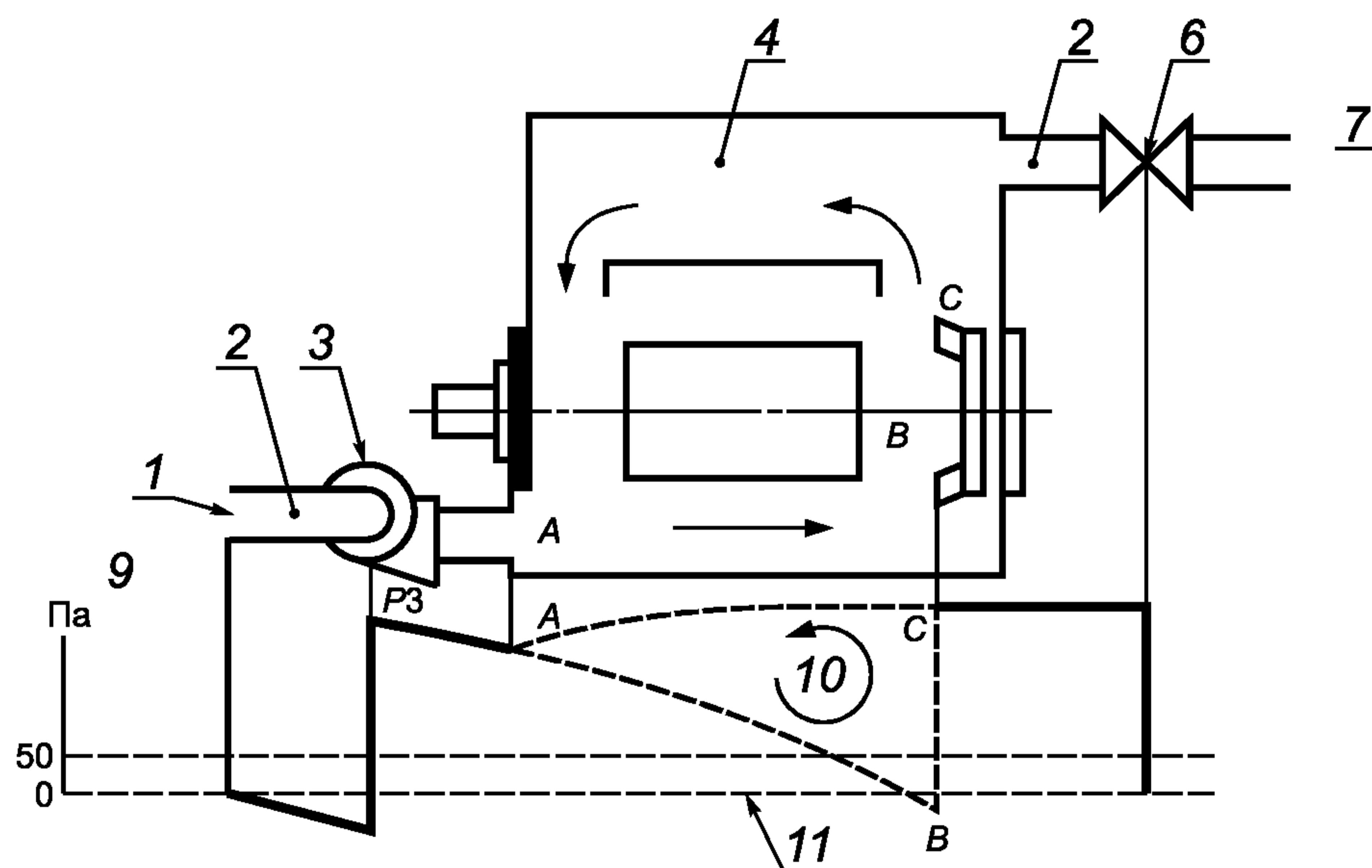
$P_3$  — давление защитного газа (определяется по сопротивлению внутренних частей потоку и подтверждается по воздействию внутреннего вентилятора, используемого для охлаждения, на участках А, В и С); 1 — вход защитного газа (в безопасной зоне); 2 — газопровод; 3 — вентилятор; 4 — оболочка; 5 — (не используется на этом рисунке); 6 — выходной клапан; 7 — выход защитного газа; 8 — (не используется на этом рисунке); 9 — избыточное давление, Па; 10 — внутреннее давление; 11 — внешнее давление
