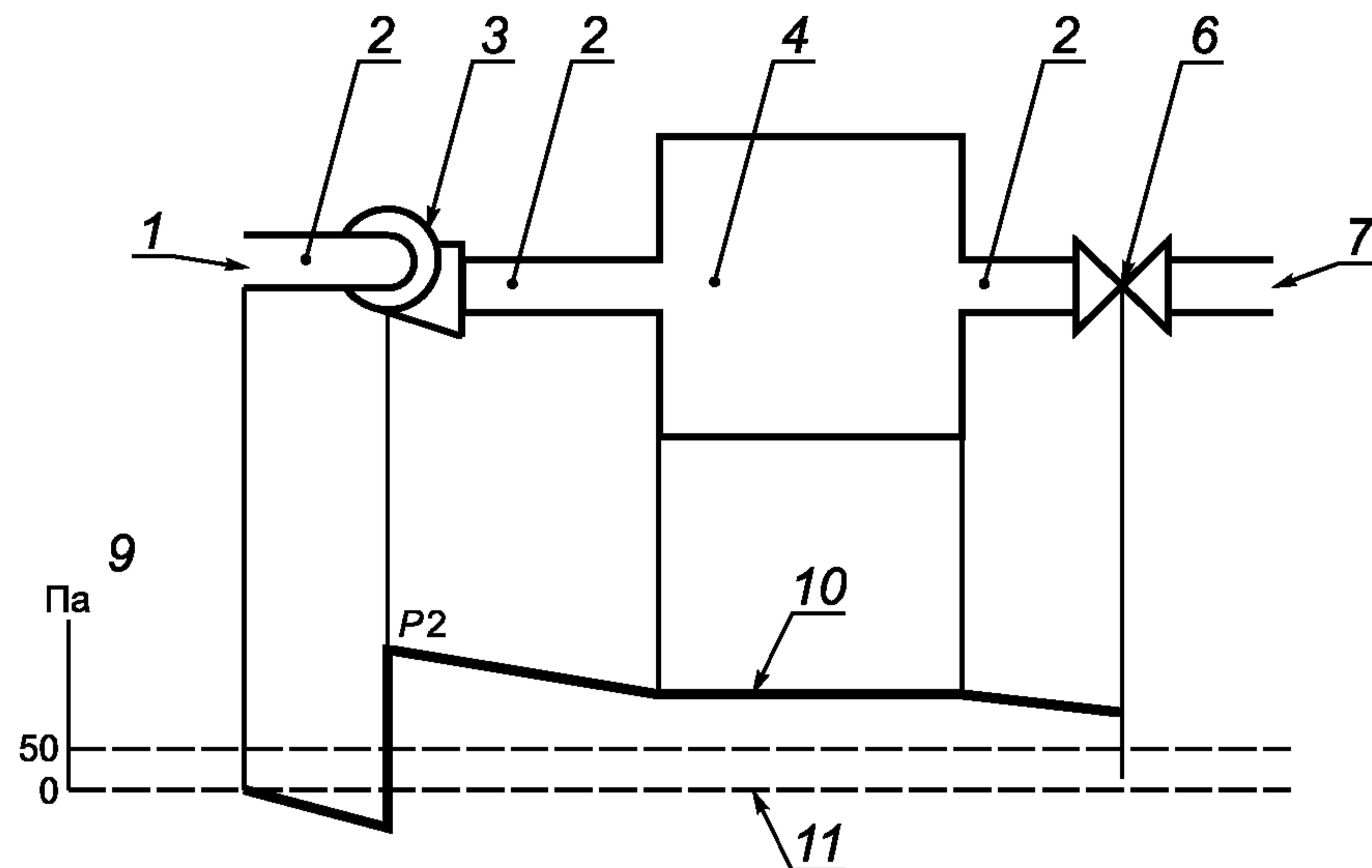
$P_2$  — давление защитного газа (практически постоянное); 1 — вход защитного газа (в безопасной зоне); 2 — газопровод; 3 — вентилятор; 4 — оболочка; 5 — (не используется на этом рисунке); 6 — выходной клапан; 7 — выход защитного газа; 8 — (не используется на этом рисунке); 9 — избыточное давление, Па; 10 — внутреннее давление; 11 — внешнее давление
