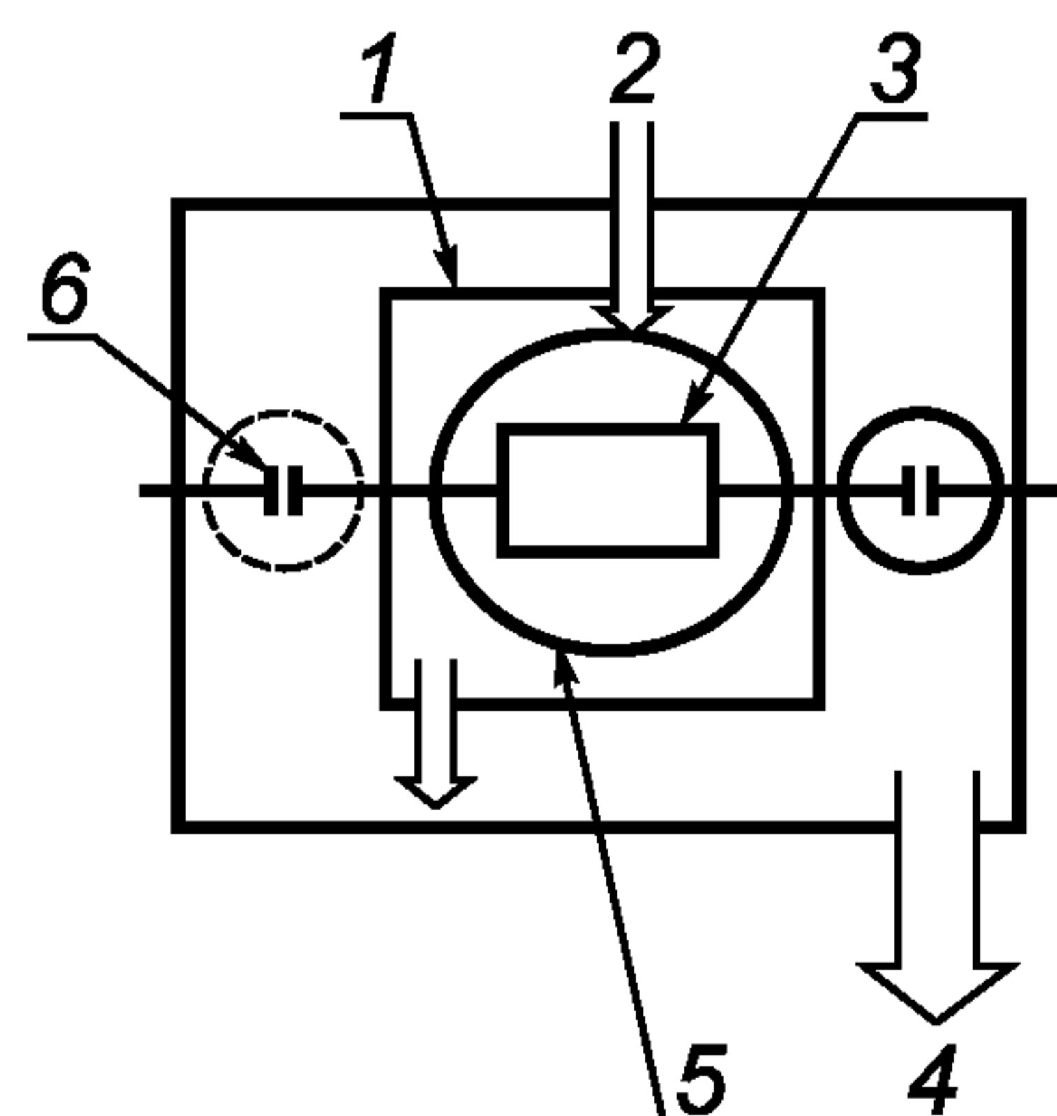
1 — внутренняя перегородка; 2 — вход продувочного газа; 3 — неповреждаемые части встроенной системы; 4 — выход продувочного газа; 5 — расположение ВУ; 6 — потенциальный источник утечки с номинальной зоной разбавления
