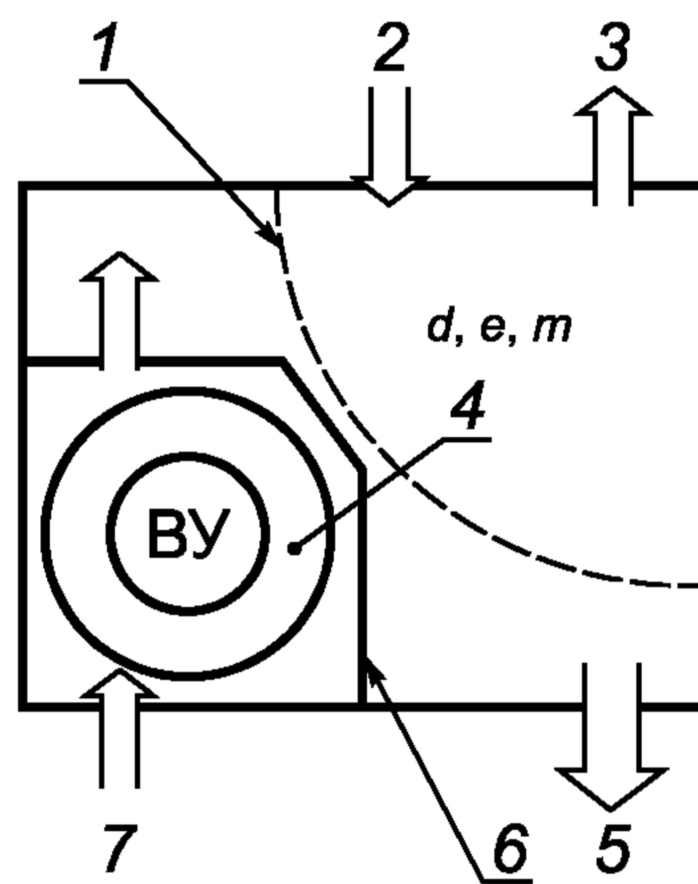
1 — номинальная граница зоны разбавления; 2 — вход воспламеняющегося вещества; 3 — выход воспламеняющегося вещества; 4 — зона, в которой проводят испытание разбавления; 5 — выход продувочного газа ; 6 — перегородка оболочки воспламеняющегося устройства; 7 — вход продувочного газа
