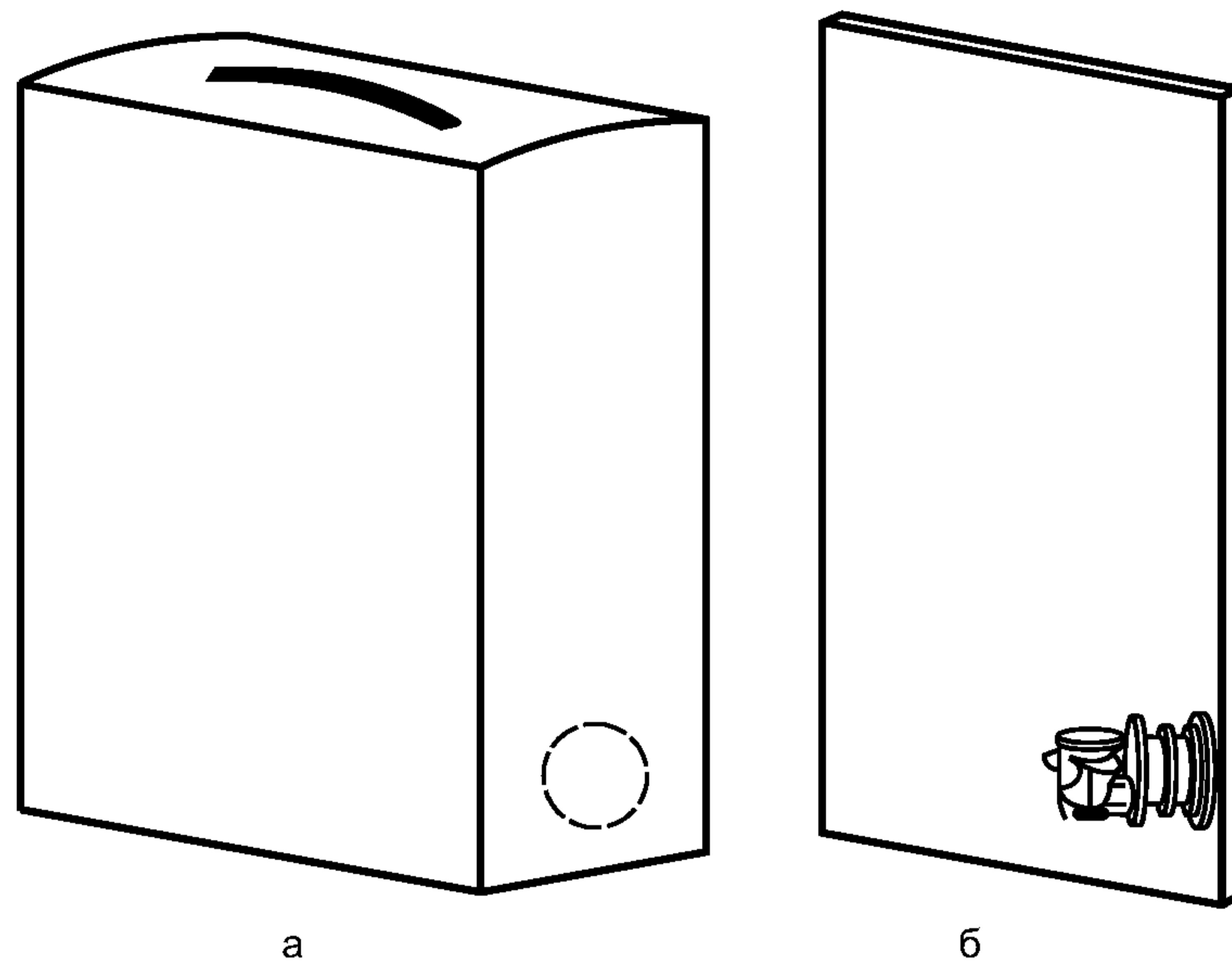
Рисунок А.6 — Комплексная тара: коробка прямоугольного сечения, закрываемая клапанами (а),
