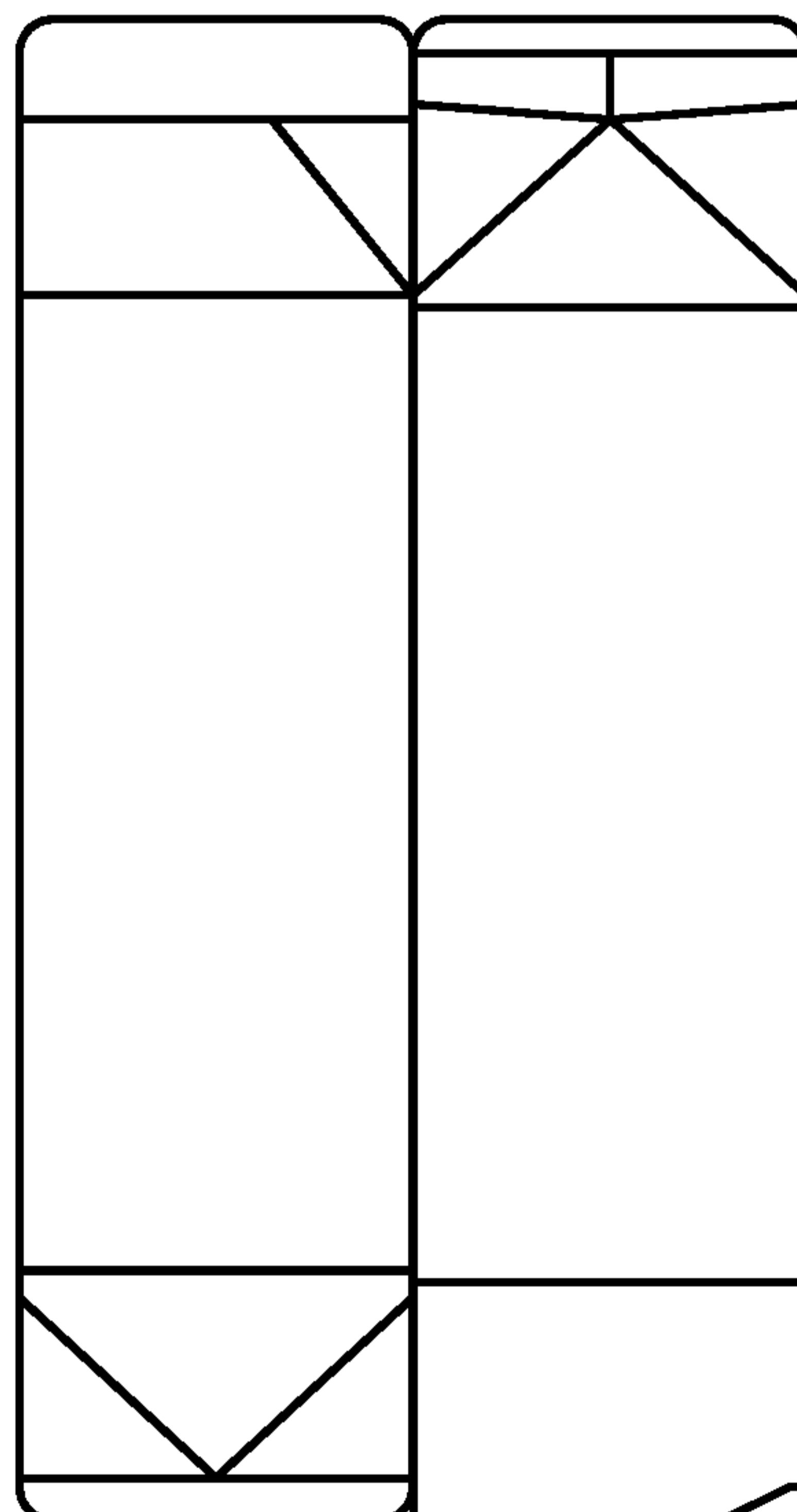
Рисунок А.5 — Заготовка коробки — высечка с нанесенными линиями сгиба (биговкой)
