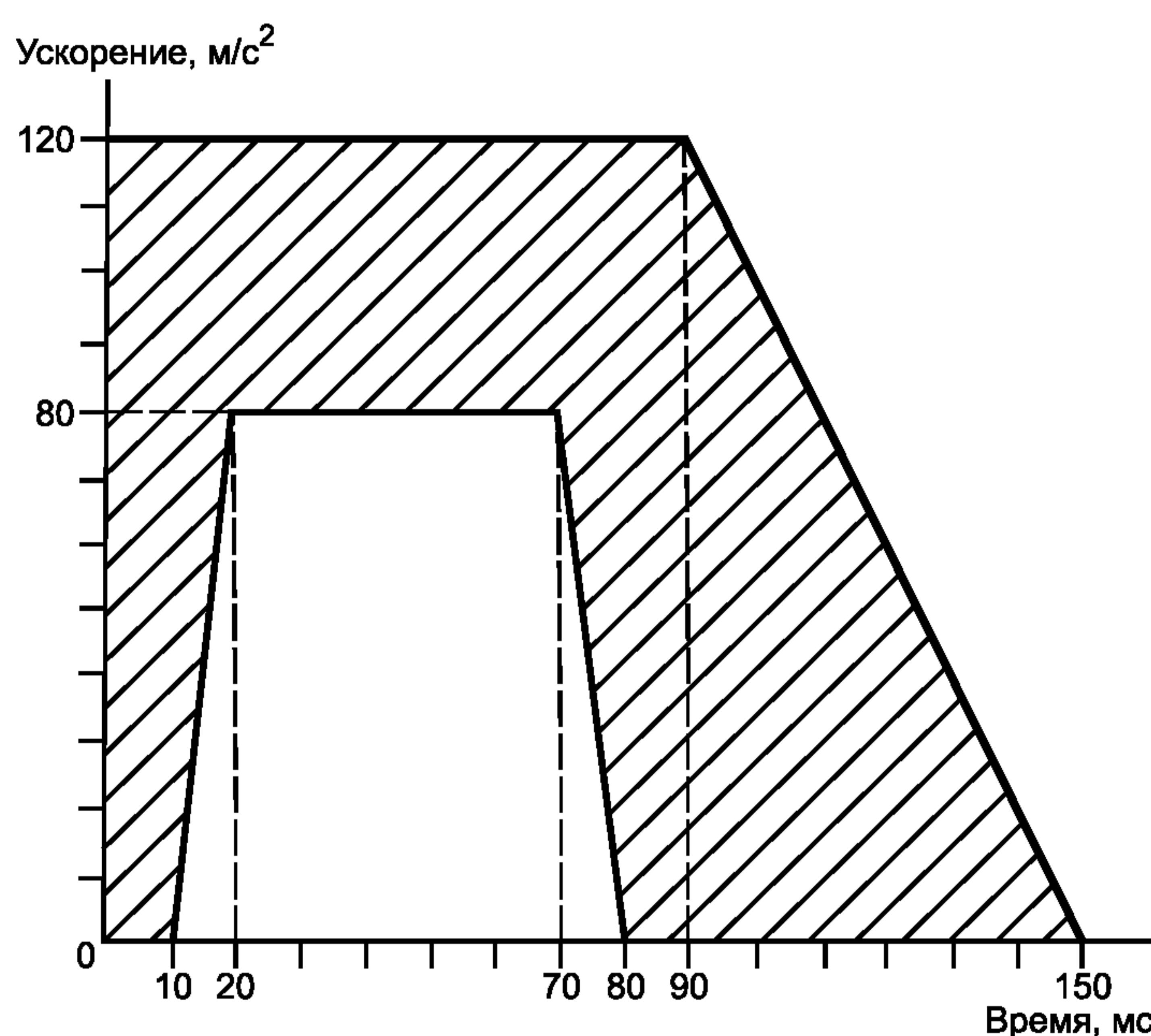
Рисунок 7.1 — Импульс ускорения
