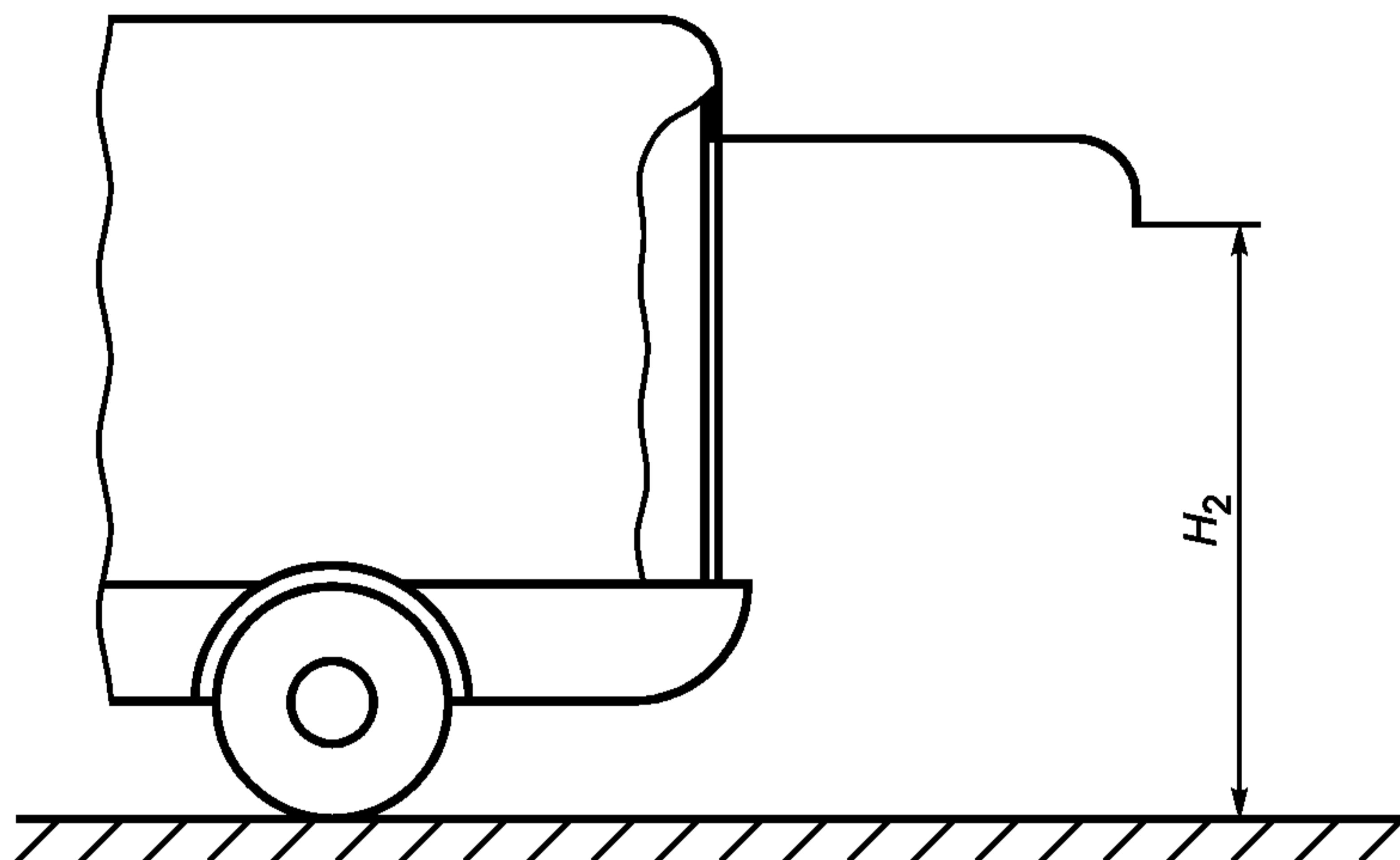
Рисунок 6.2 — Высота задней двери в открытом положении
