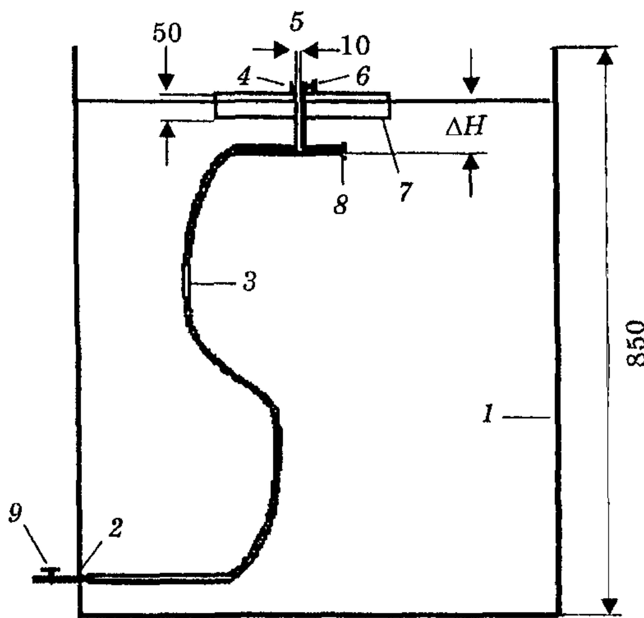
1 — смкость вместимостью 0,2 м<sup>3</sup>; 2 — патрубок; 3 — резиновый шланг длиной 1,5 м; 4 — втулка для регулирования напора воды; 5 — воздушная трубка для выравнивания давления в системе введения; 6 — фиксатор; 7 — поплавок из пенопласта; 8 — сменная шайба с калиброванным отверстием; 9 — запорный кран
