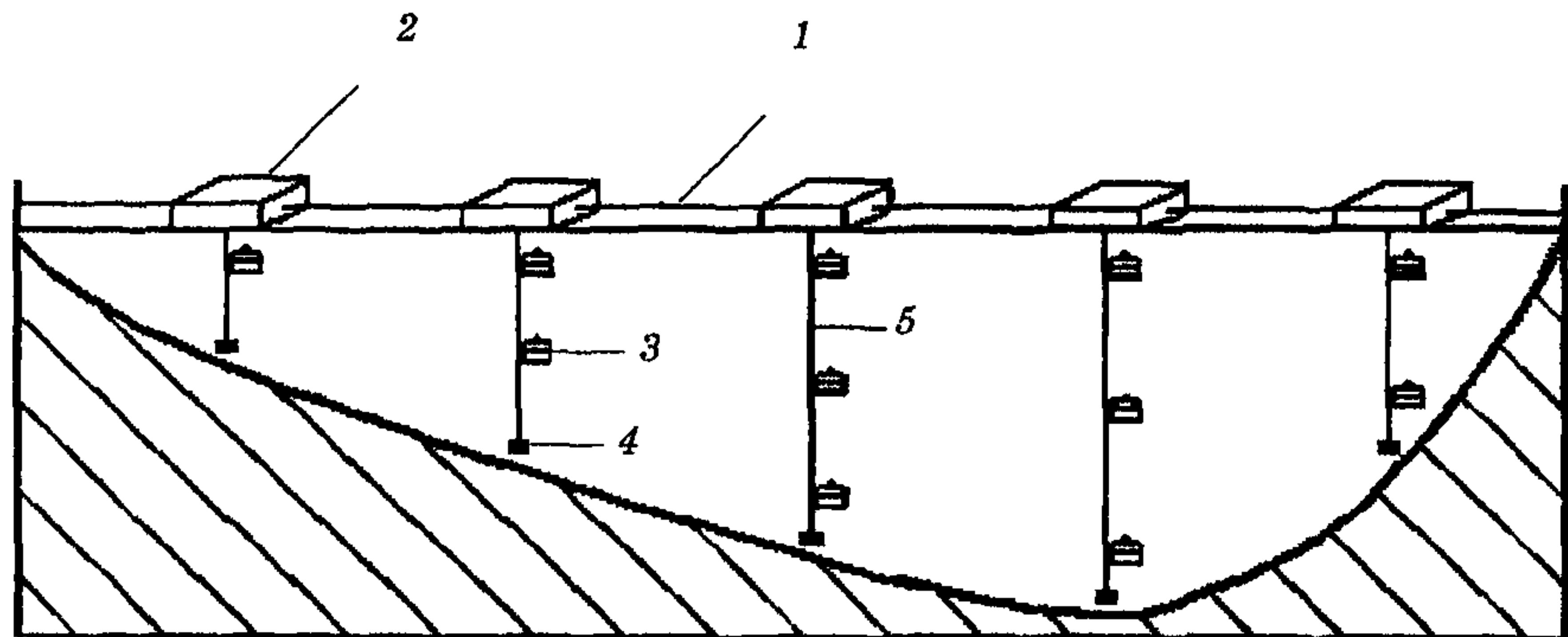
1 — капроновый трос; 2 — пенопластовый плотик; 3 — емкость (бутыль) для отбора проб;
