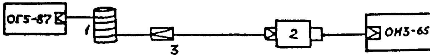
Рис. 40 Измерение средней мощности на выходе смесителя мод.
