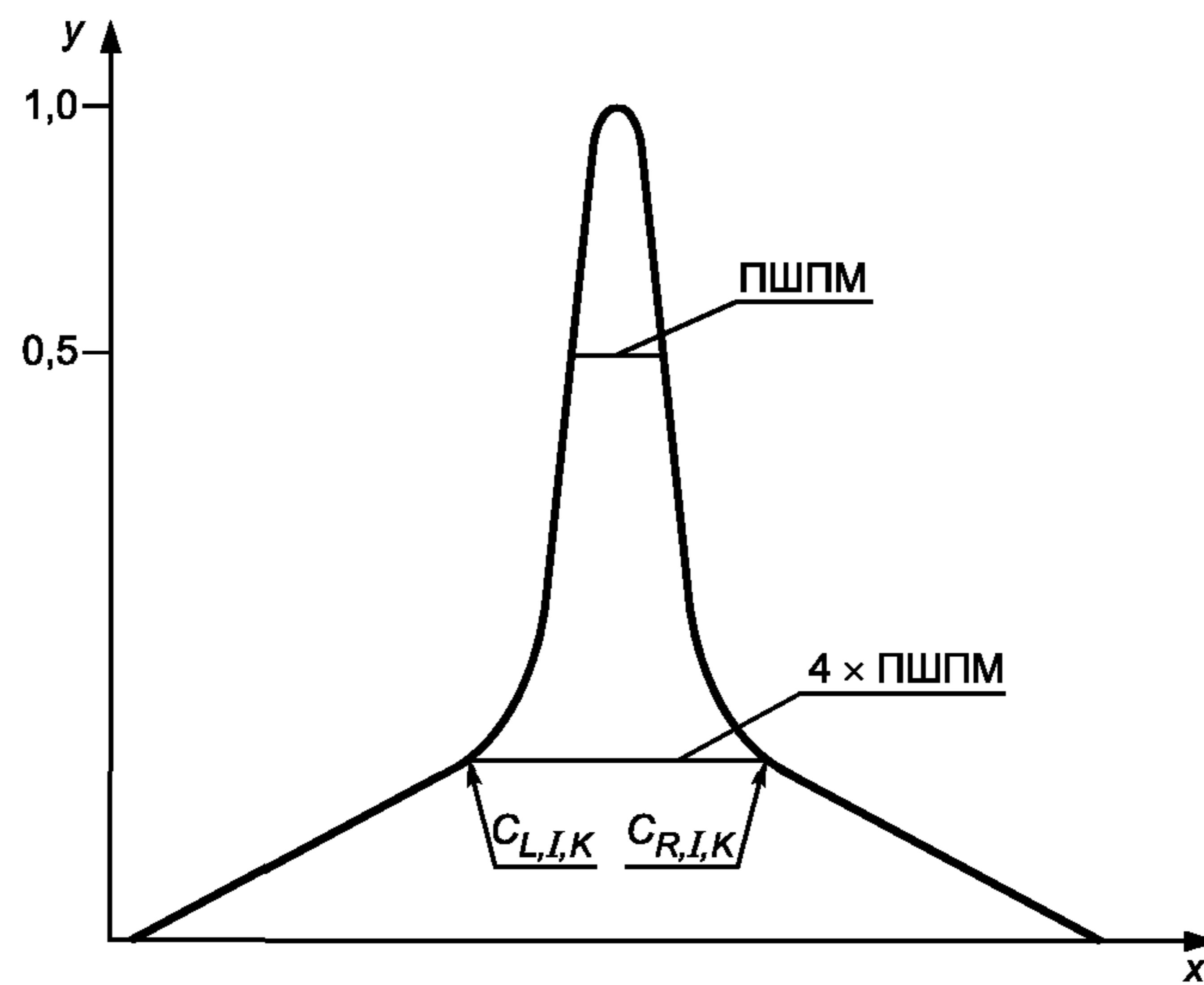
П р и м е ч а н и е — В суммарной ПРОЕКЦИИ рассеяние оценивают счетом вне полосы шириной  $2 \times \text{ПШПМ}$  плюс счет в область ниже линии  $C_{L,I,K} — C_{R,I,K}$ .
