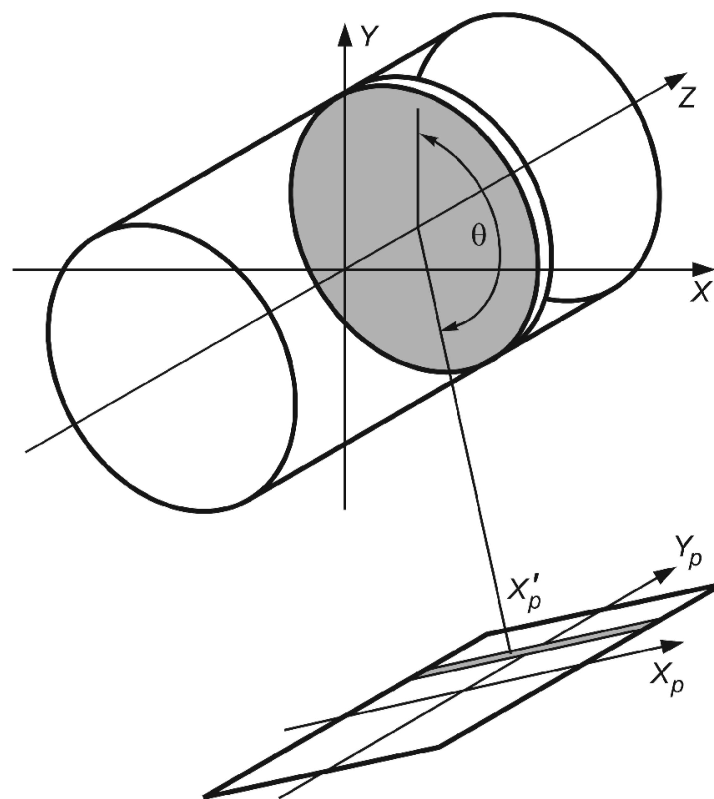
П р и м е ч а н и е — СИСТЕМА КООРДИНАТ  $X$ ,  $Y$ ,  $Z$  — в центре ТОМОГРАФИЧЕСКОГО ОБЪЕМА (в виде цилиндра);  $Z$  — СИСТЕМНАЯ ОСЬ. СИСТЕМА КООРДИНАТ ПРОЕКЦИИ  $X_p$ ,  $Y_p$  показана для проекционного угла  $\Theta$ . Для угла  $\Theta$  одномерная ПРОЕКЦИЯ отмеченного на рисунке среза имеет зону в координатах  $X_p$ ,  $Y_p$ , отмеченную штриховкой. В пределах этой зоны ЦЕНТР ВРАЩЕНИЯ проектируется на координату  $X_p$ .
