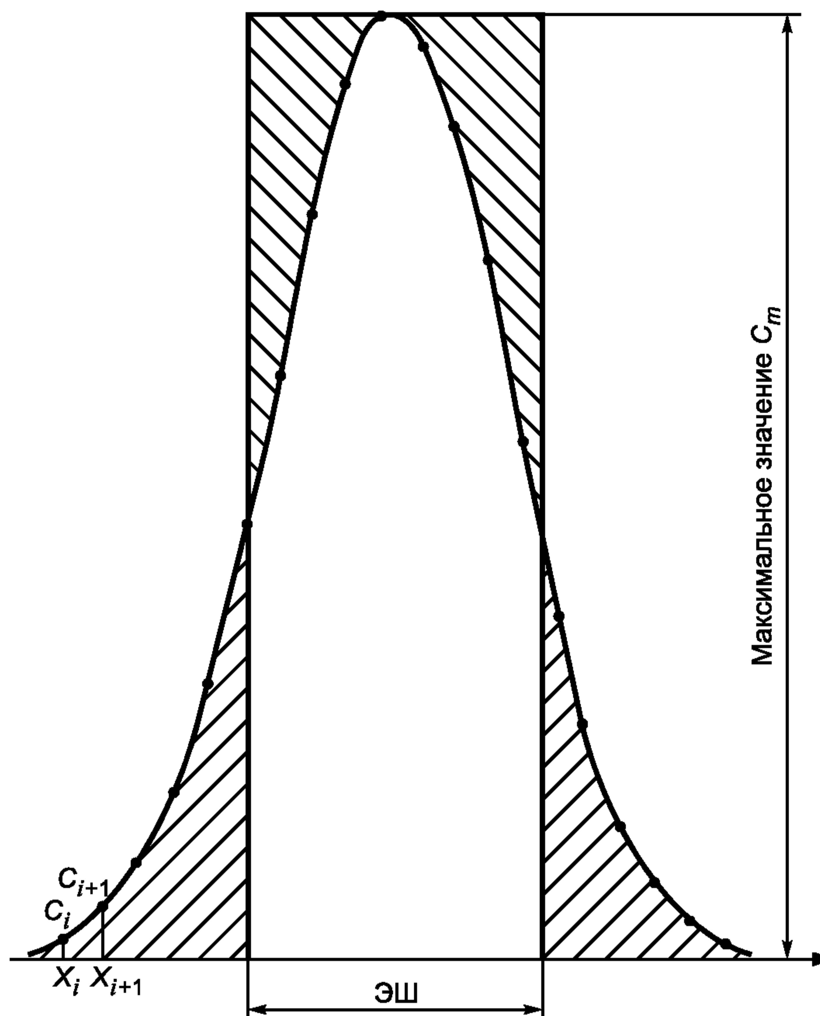
**П р и м е ч а н и е —** Эквивалент ширины ЭШ задан шириной прямоугольника, площадь которого равна площади внутри функции линейного распределения, и максимальным значением  $C_m$ .
