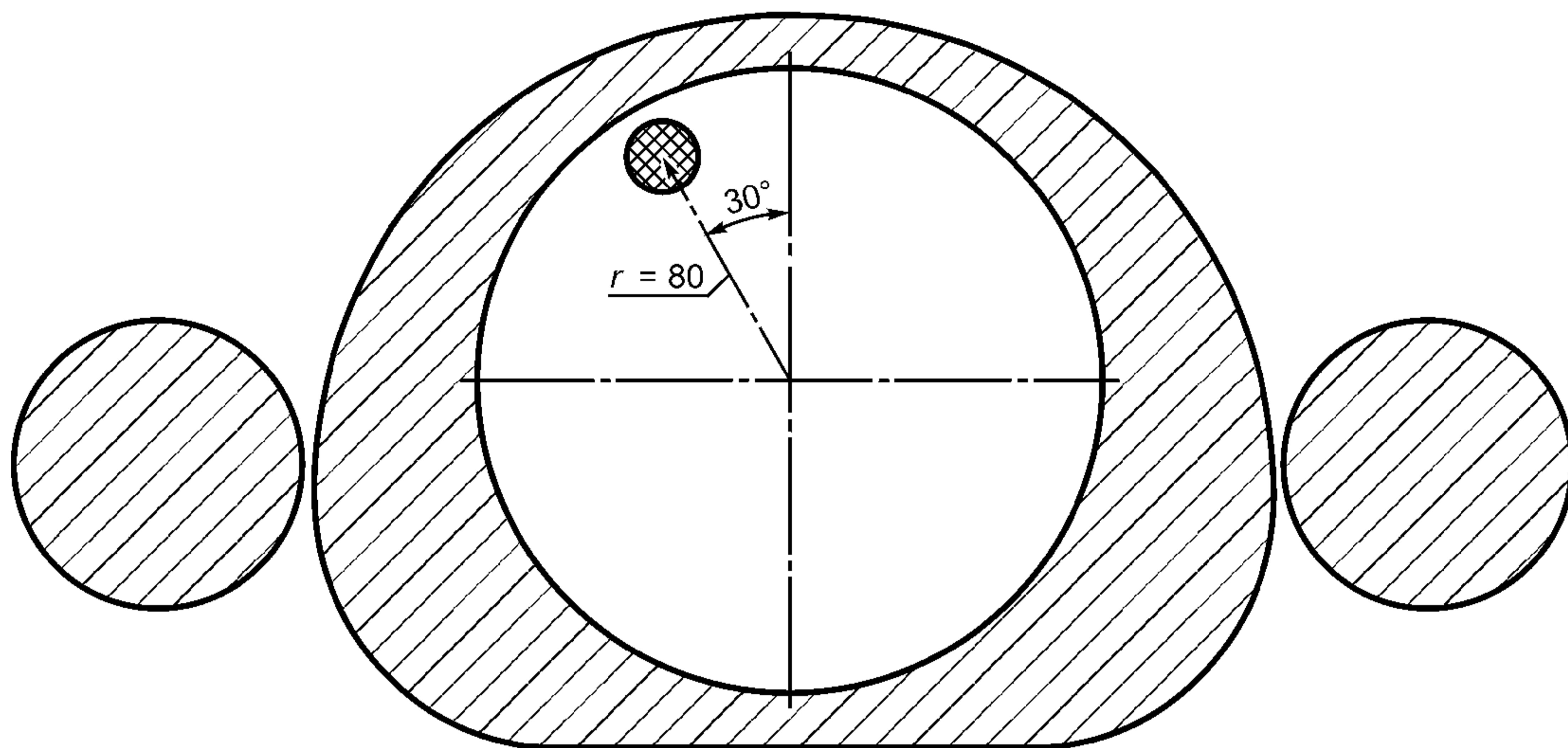
**П р и м е ч а н и е —** Фантом тела, включающий руки, наполнен водой. Фантом головы наполнен воздухом. РАДИОАКТИВНЫЙ ИСТОЧНИК представляет собой стержень с внутренним диаметром 21 × 130 мм (внутренняя длина) в том положении, которое показано на рисунке.
