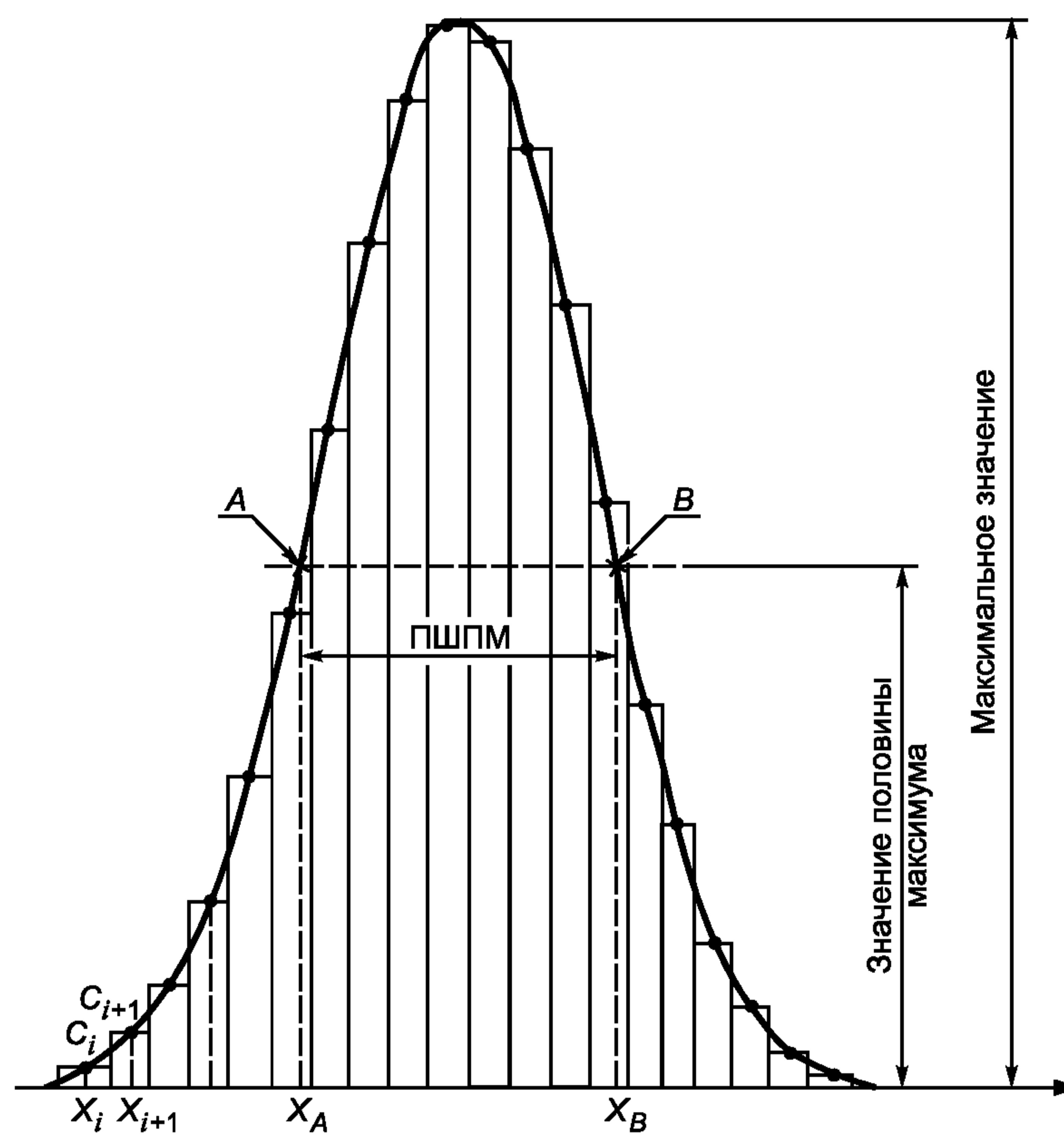
П р и м е ч а н и е —  $A$  и  $B$  — точки пересечения кривой интерполяции счета линии значения полумаксимума. ПШПМ равна  $X_B - X_A$ .
