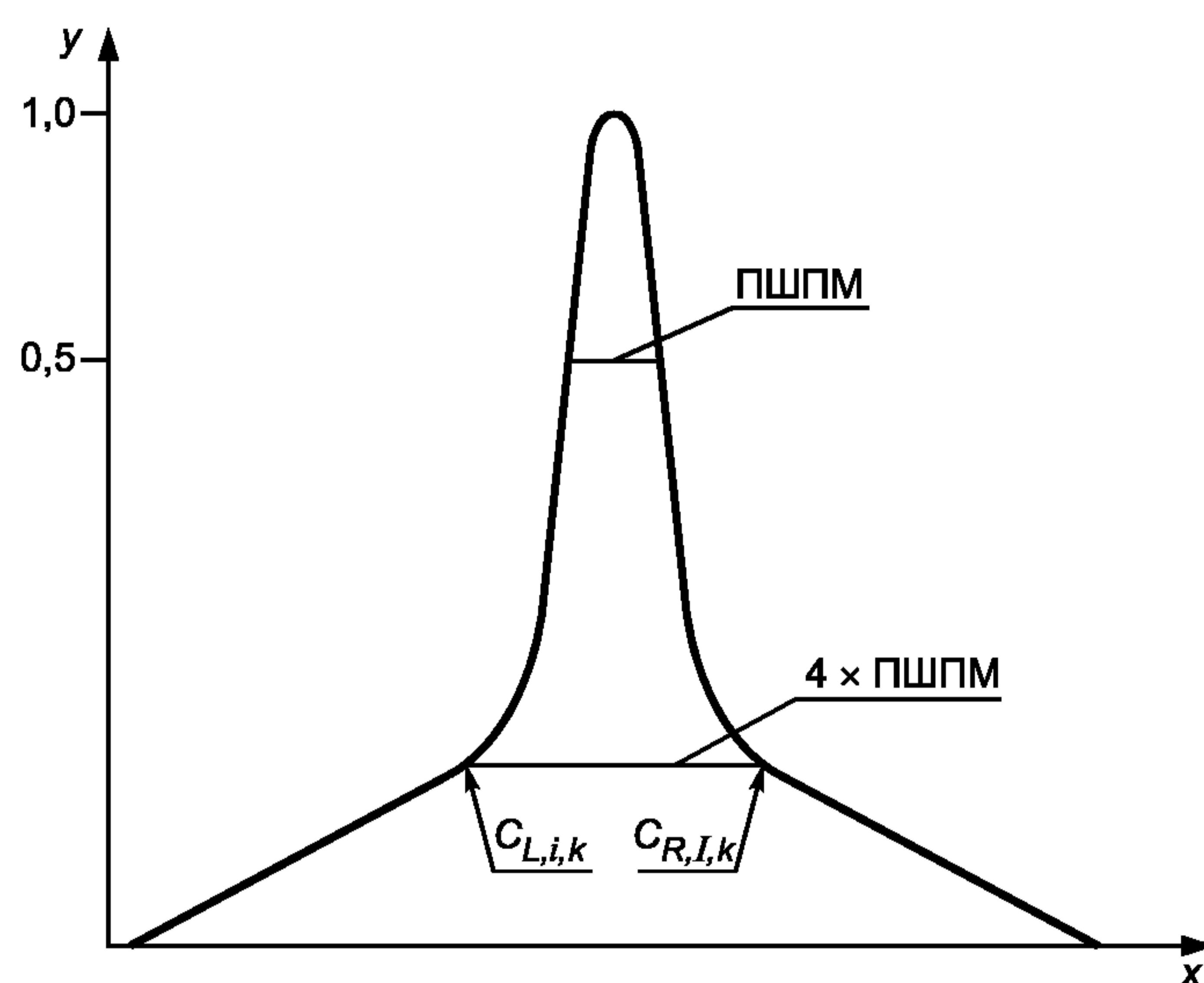
**П р и м е ч а н и е —** На суммарной проекции рассеяние оценивают суммой вне полосы  $4 \times \text{ПШПМ}$  и счетов ниже линии  $C_{L,i,k} — C_{R,i,k}$ .
