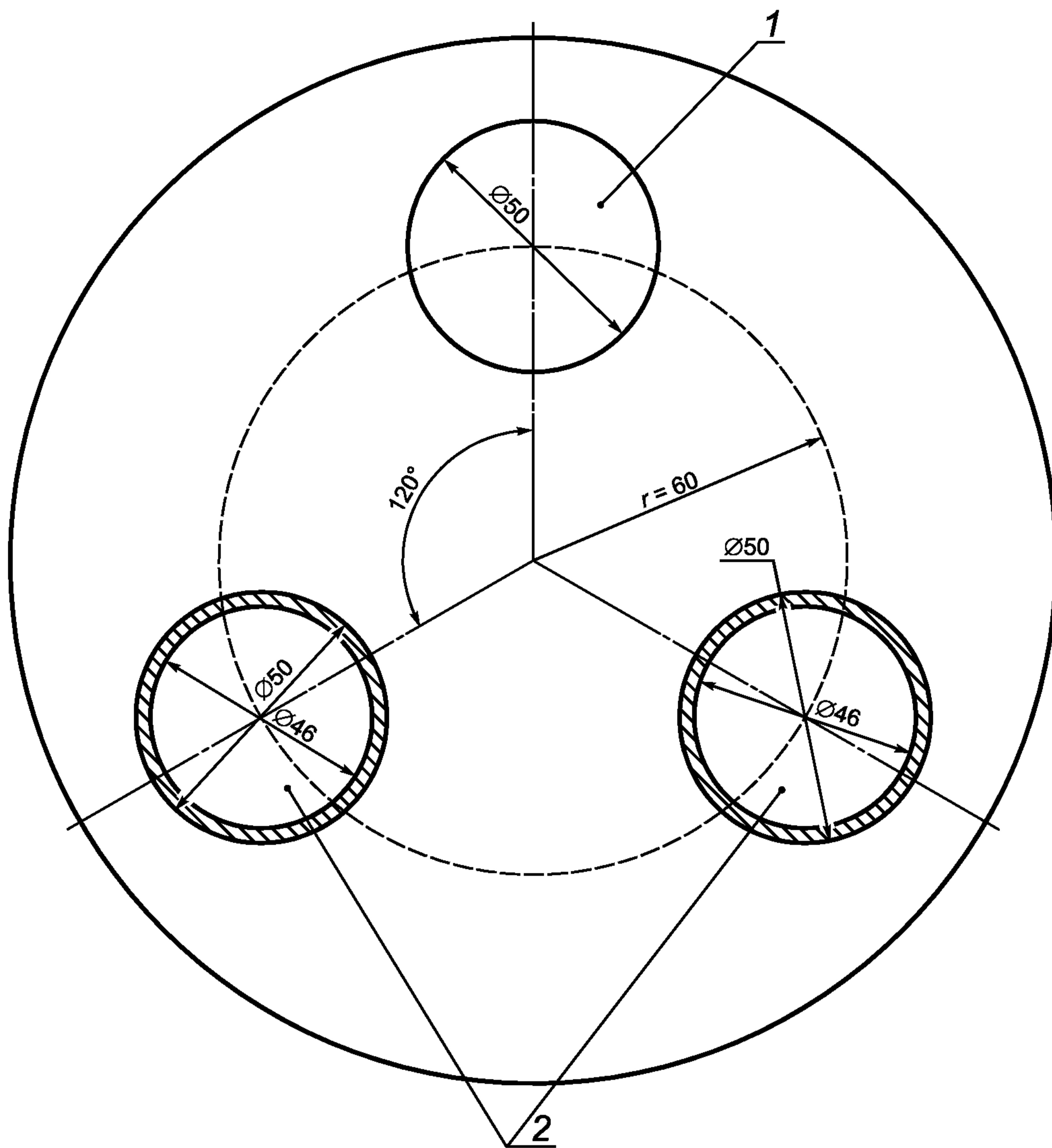
1 — твердый политетрафлюороэтилен; 2 — наполненные цилиндры
