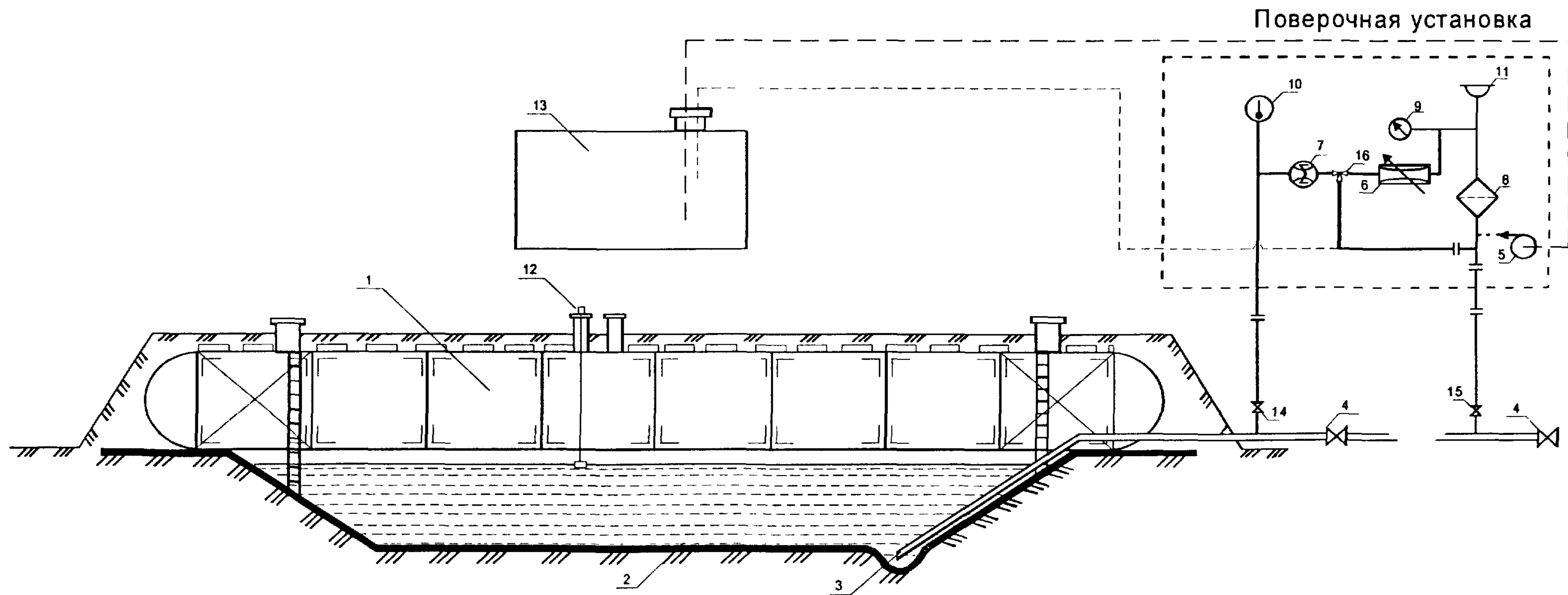
1 – резервуар; 2 – днище  $h_{М.П}$ ; 3 – приемо-раздаточный патрубок; 4 – задвижка; 5 – насос; 6 – дроссель; 7 – счетчик жидкости; 8 – фильтр; 9 – измеритель давления (манометр); 10 – измеритель температуры; 11 – парогазоотделитель; 12 – уровнемер; 13 – расходный резервуар; 14, 15 – задвижки поверочной установки; 16 – трехходовой кран.
