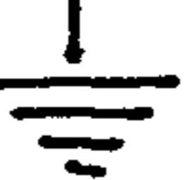
. Эти болты и клеммы необходимо подсоединить к контуру заземления в помещении, где эксплуатируется ГБЛ.
