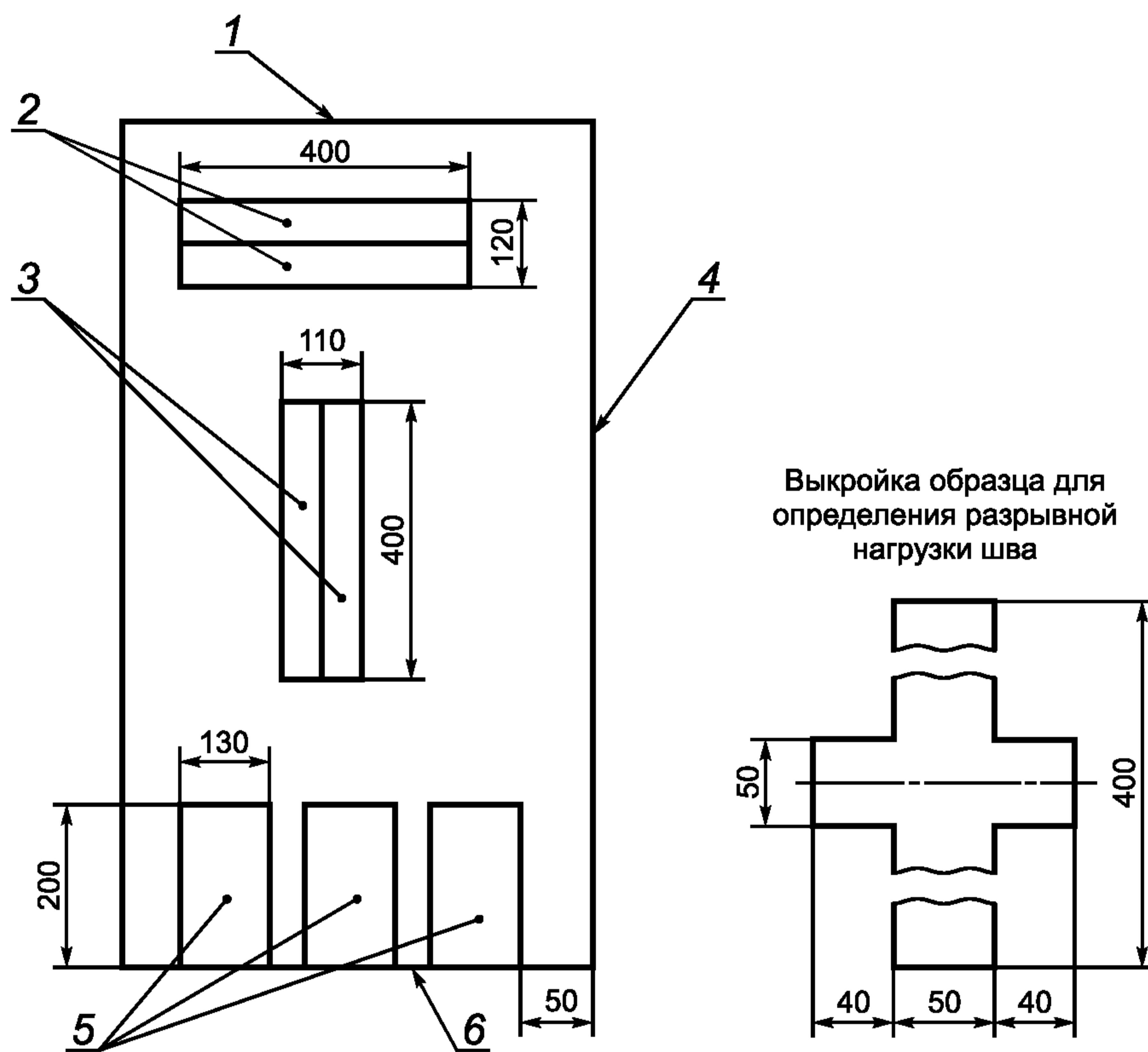
1 — горловина; 2 — образцы для определения разрывной нагрузки ткани по утку и числа нитей на 10 см; 3 — образцы для определения разрывной нагрузки ткани по основе и числа нитей на 10 см; 4 — бок; 5 — образцы для определения разрывной нагрузки донного шва; 6 — дно
