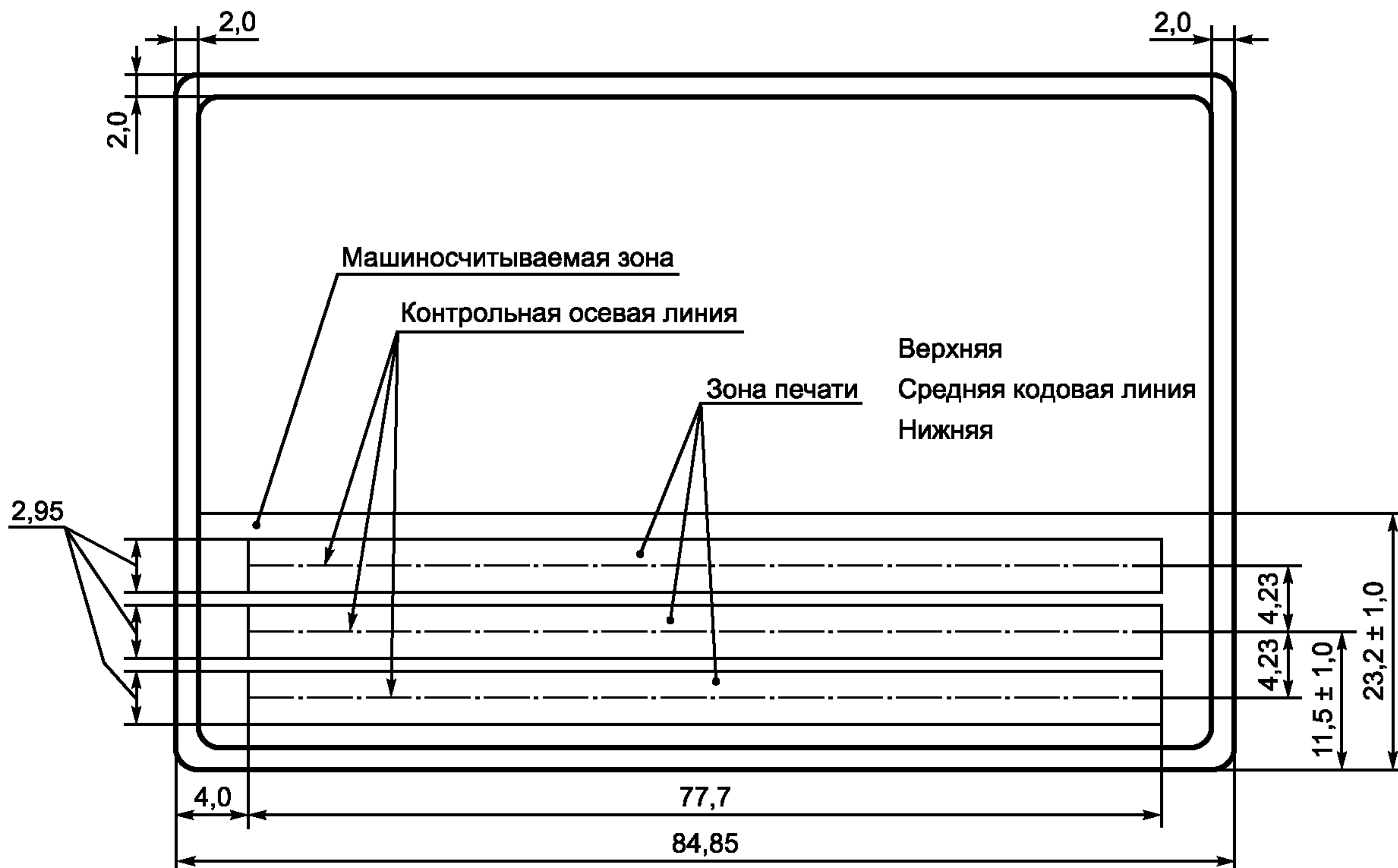
Рисунок 7 — Расположение и размеры МСЗ для документов типа ПД-1
