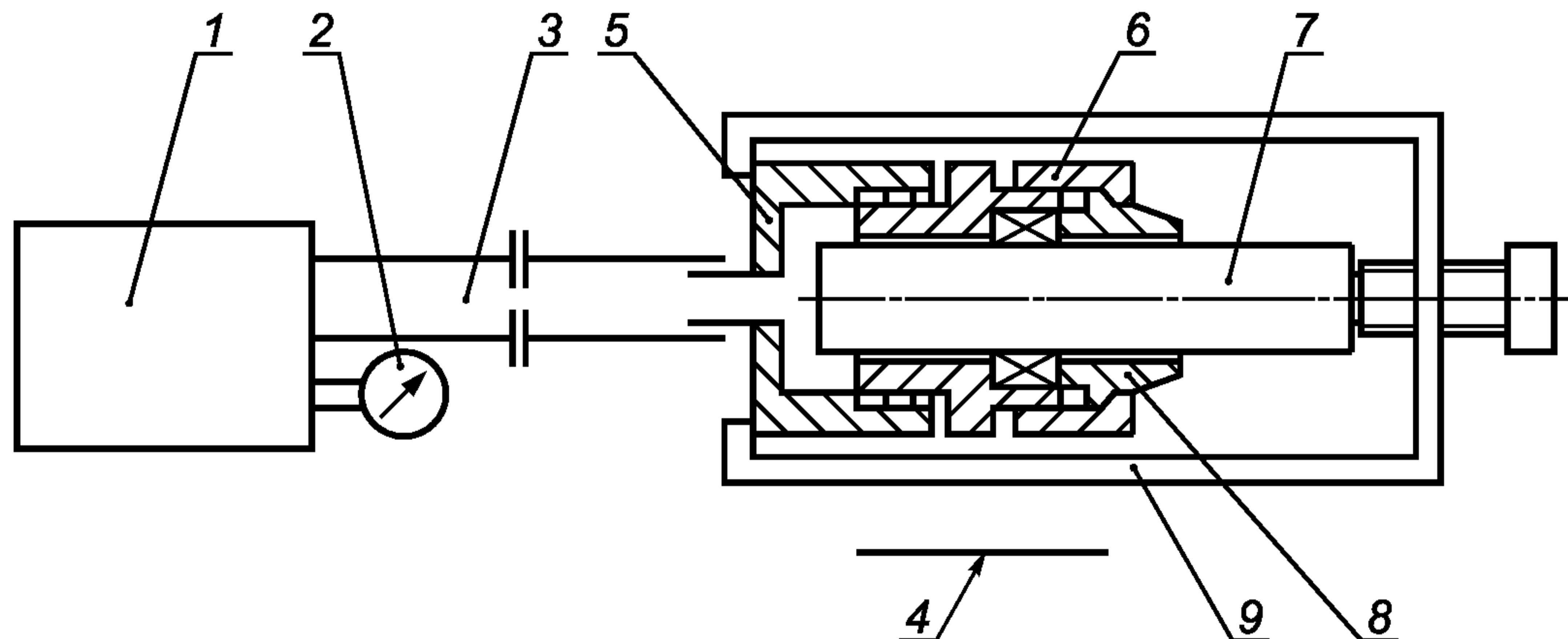
1 — гидравлический насос; 2 — манометр; 3 — рукав; 4 — промокательная бумага; 5 — переходник; 6 — уплотнительное кольцо; 7 — оправка/кабель с металлической оплёткой; 8 — нажимной элемент; 9 — прижимное устройство
