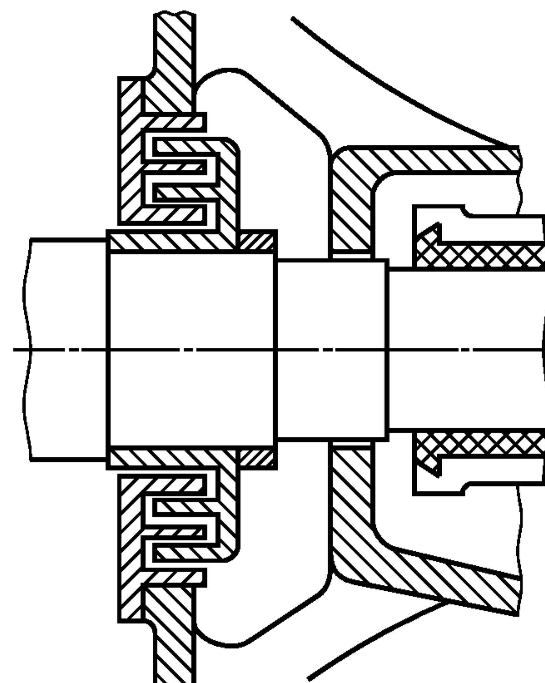
1 — зазор; 2 — стопор для предотвращения проворачивания втулки
