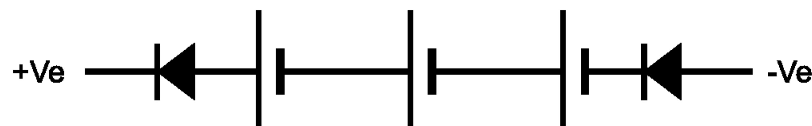
Рисунок Е.2 — Схема подключения блокирующих диодов
