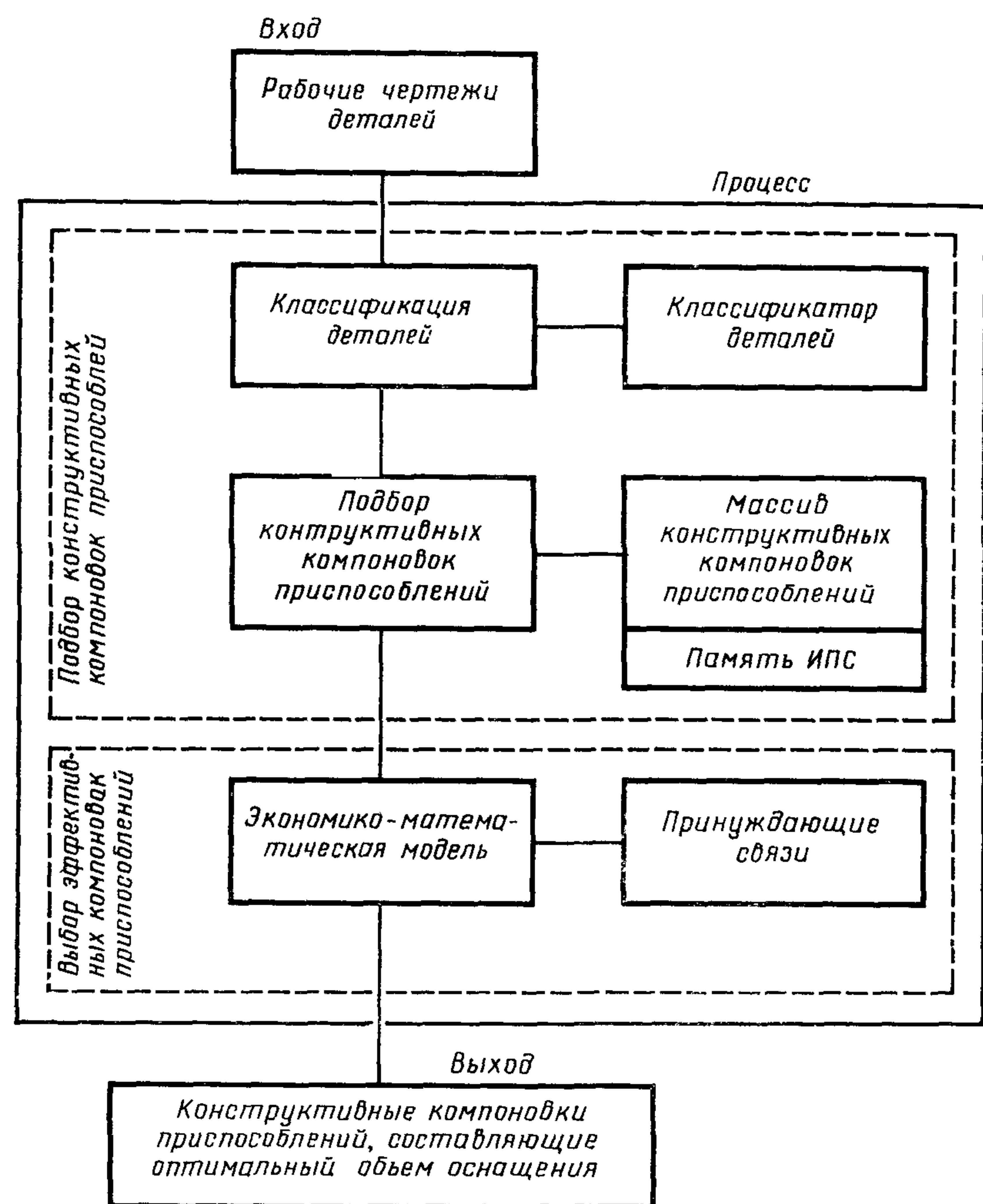
Рис. 1. Схема функционирования ИПС
