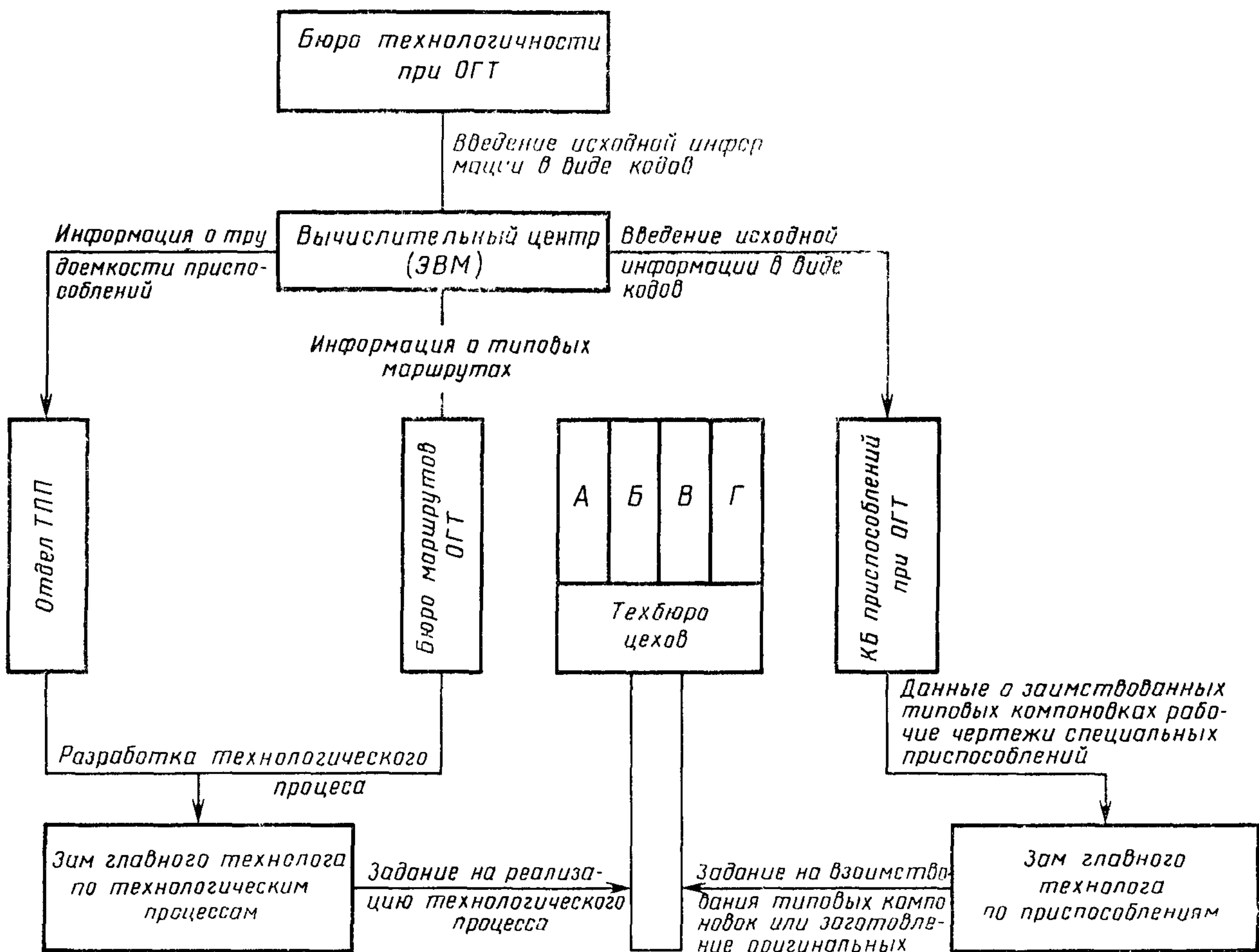
Рис. 1. Вариант схемы получения и распространения информации о приспособлениях при использовании ИПС-І
