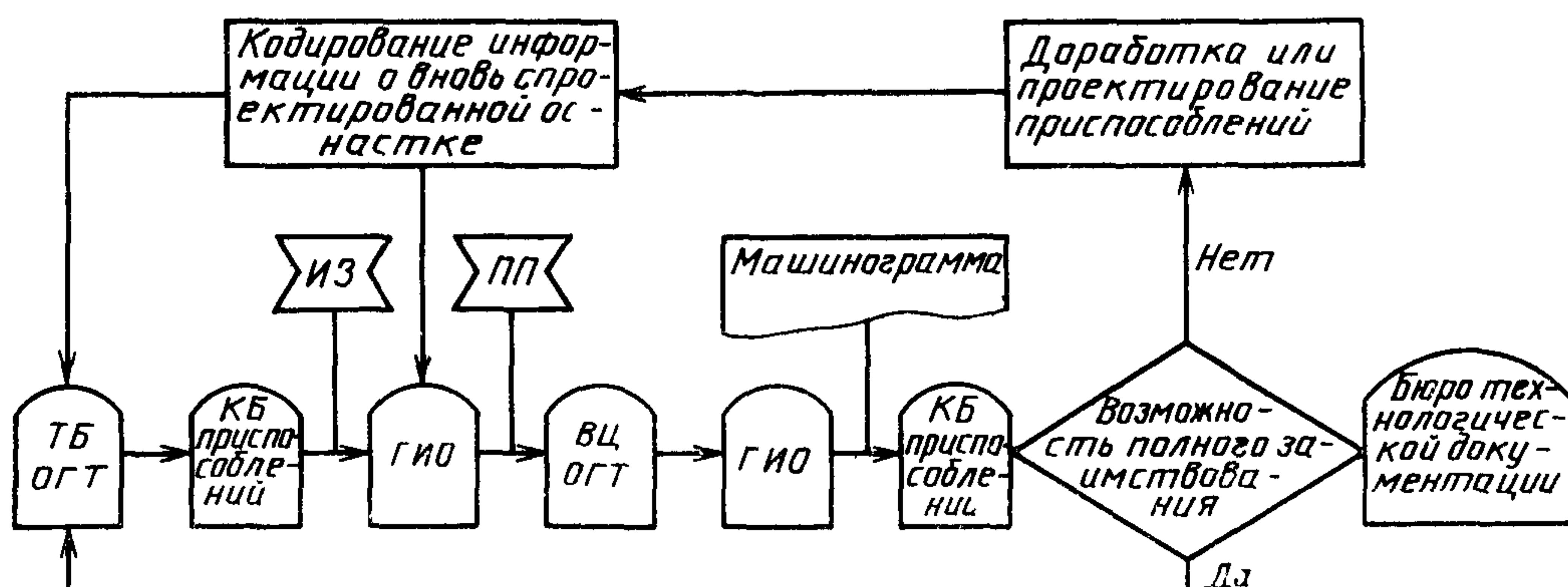
Рис. 2. Типовая блок-схема взаимосвязи между службами предприятия в режиме заимствования
