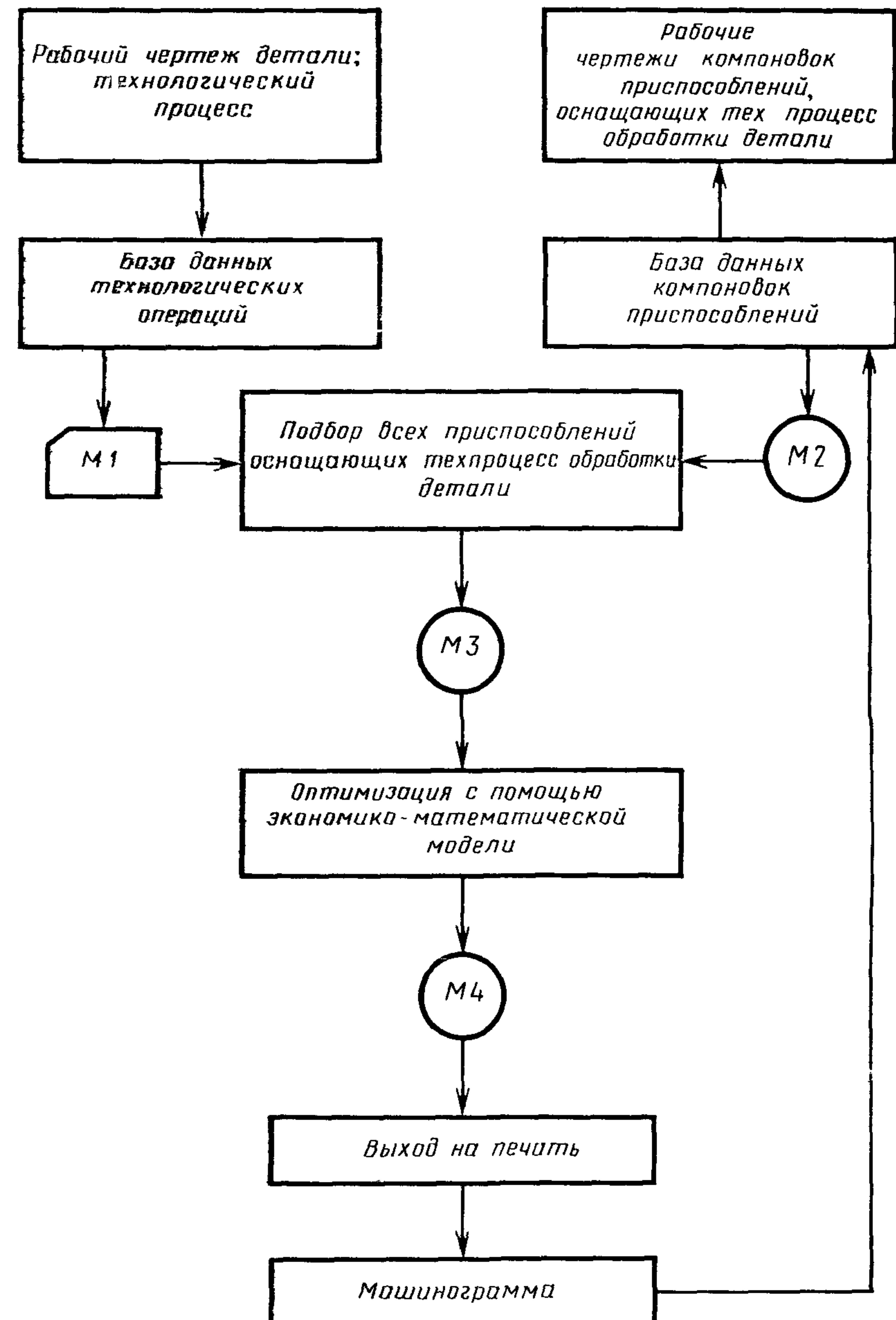
Рис. 2. Схема алгоритма выбора оснащения технологического процесса обработки детали
