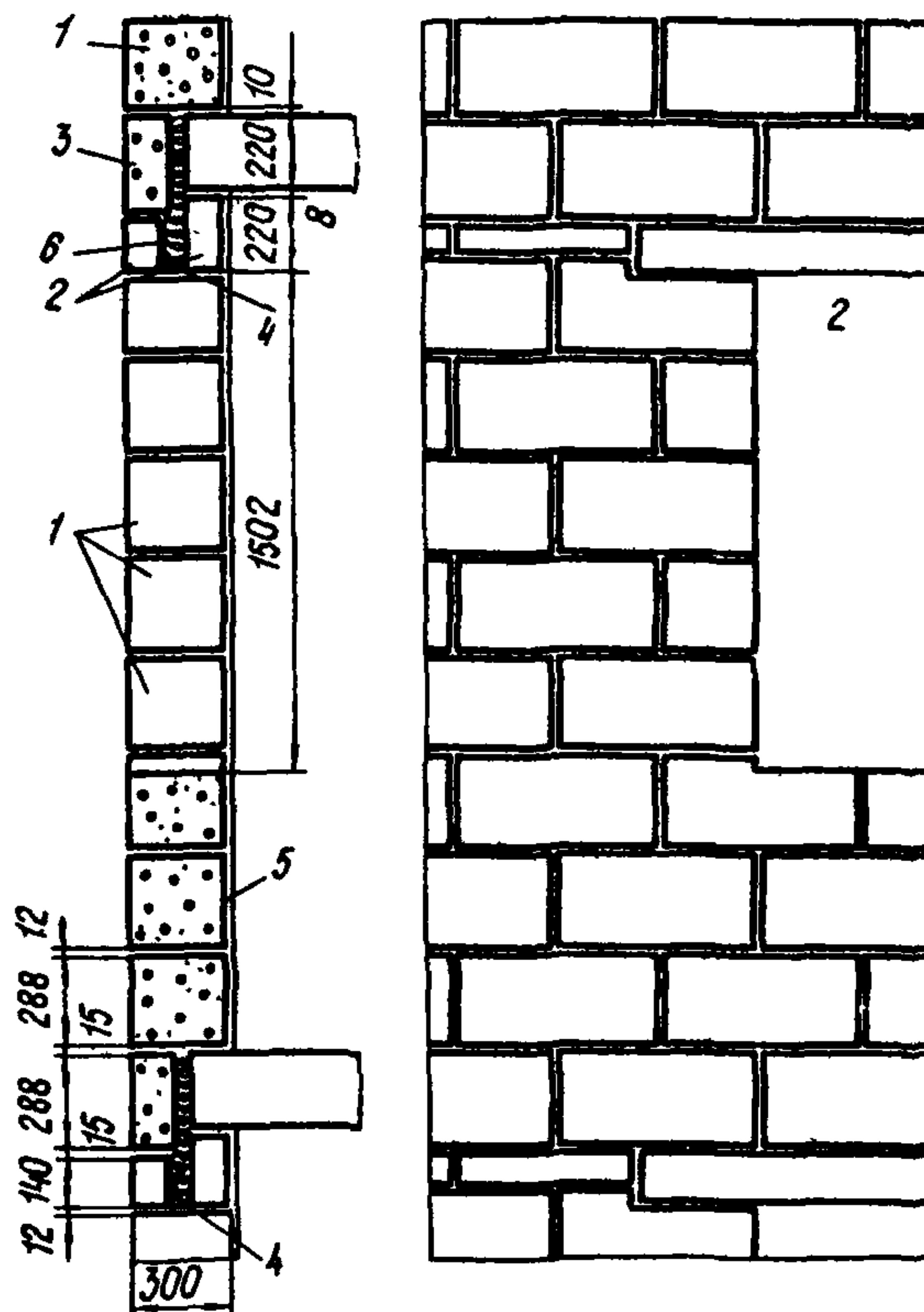
**Рис.2.** Схема кладки стен из мелких ячеистобетонных блоков толщиной в один блок с выполнением проема
