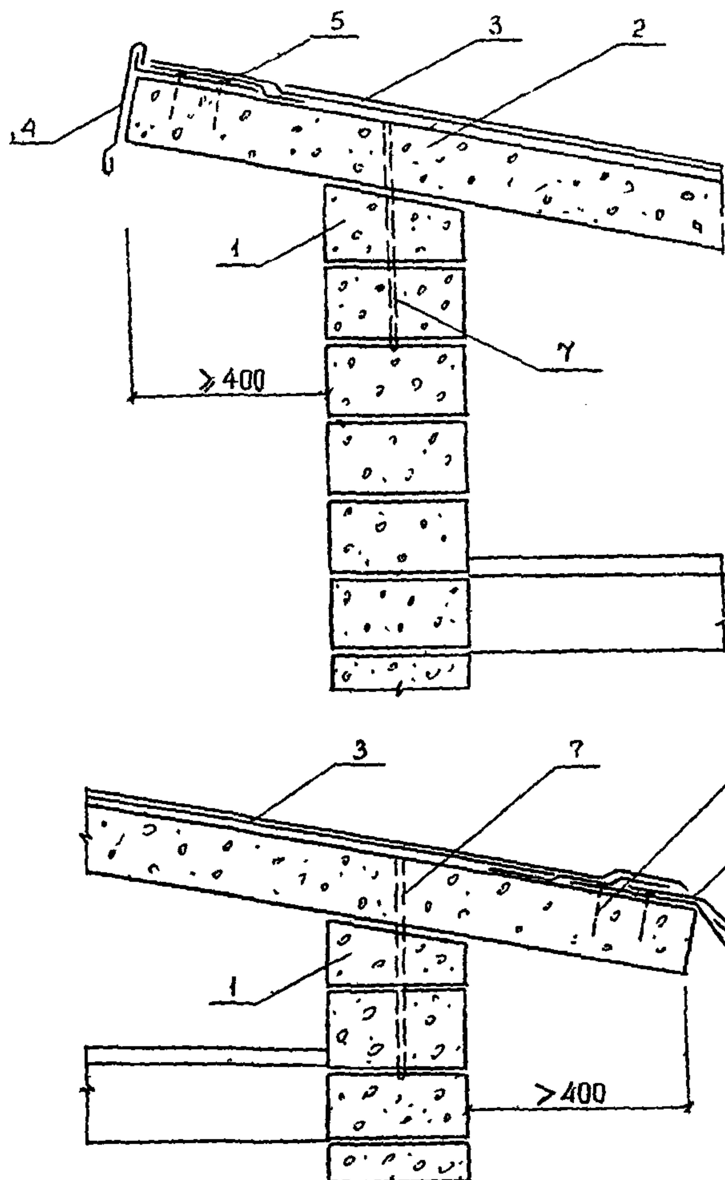
**Рис.5. Вариант устройства наклонной крыши из ячеистобетонных плит**
