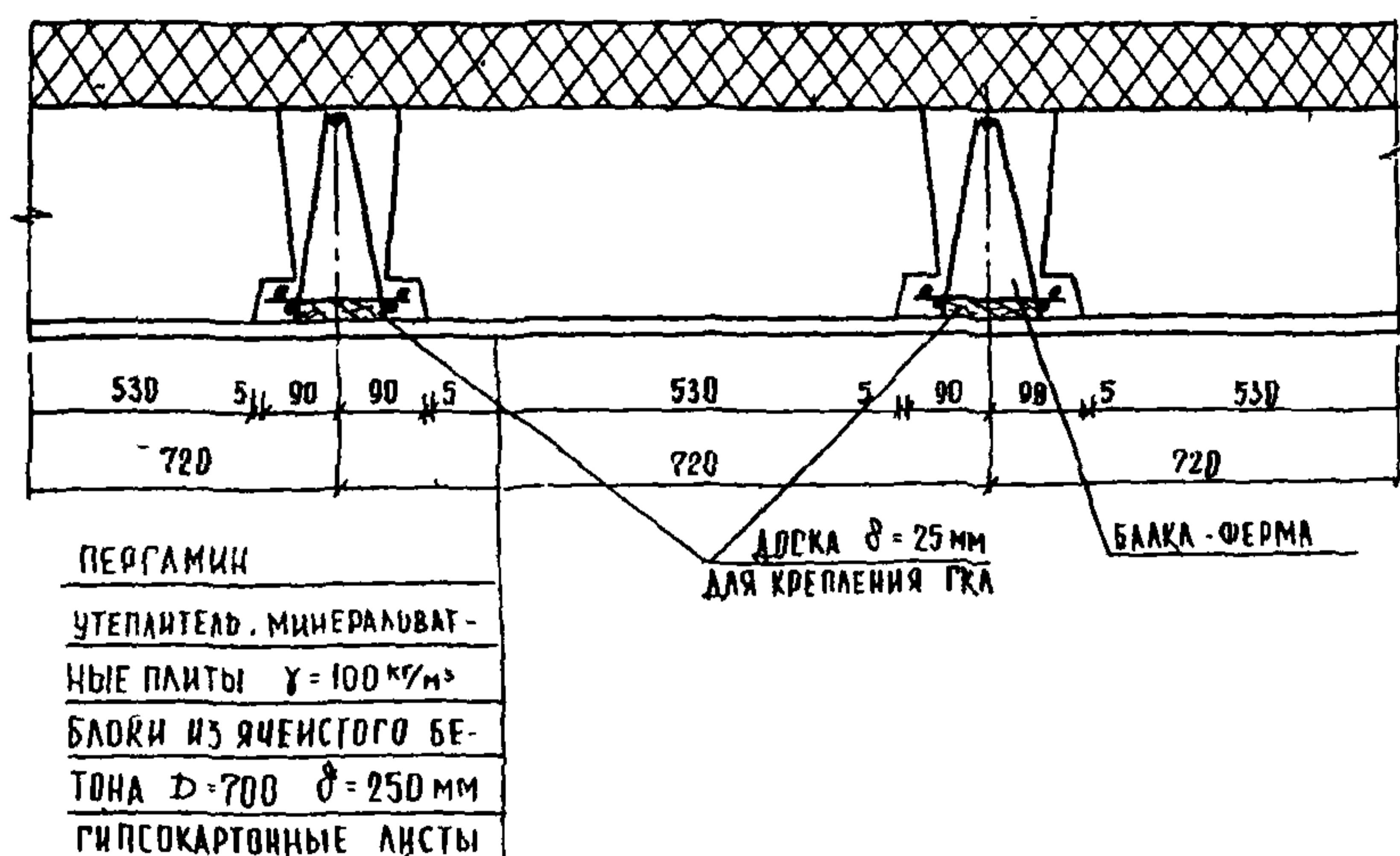
Рис. 11. Вариант сборно-монолитного перекрытия из ячеистобетонных блоков
