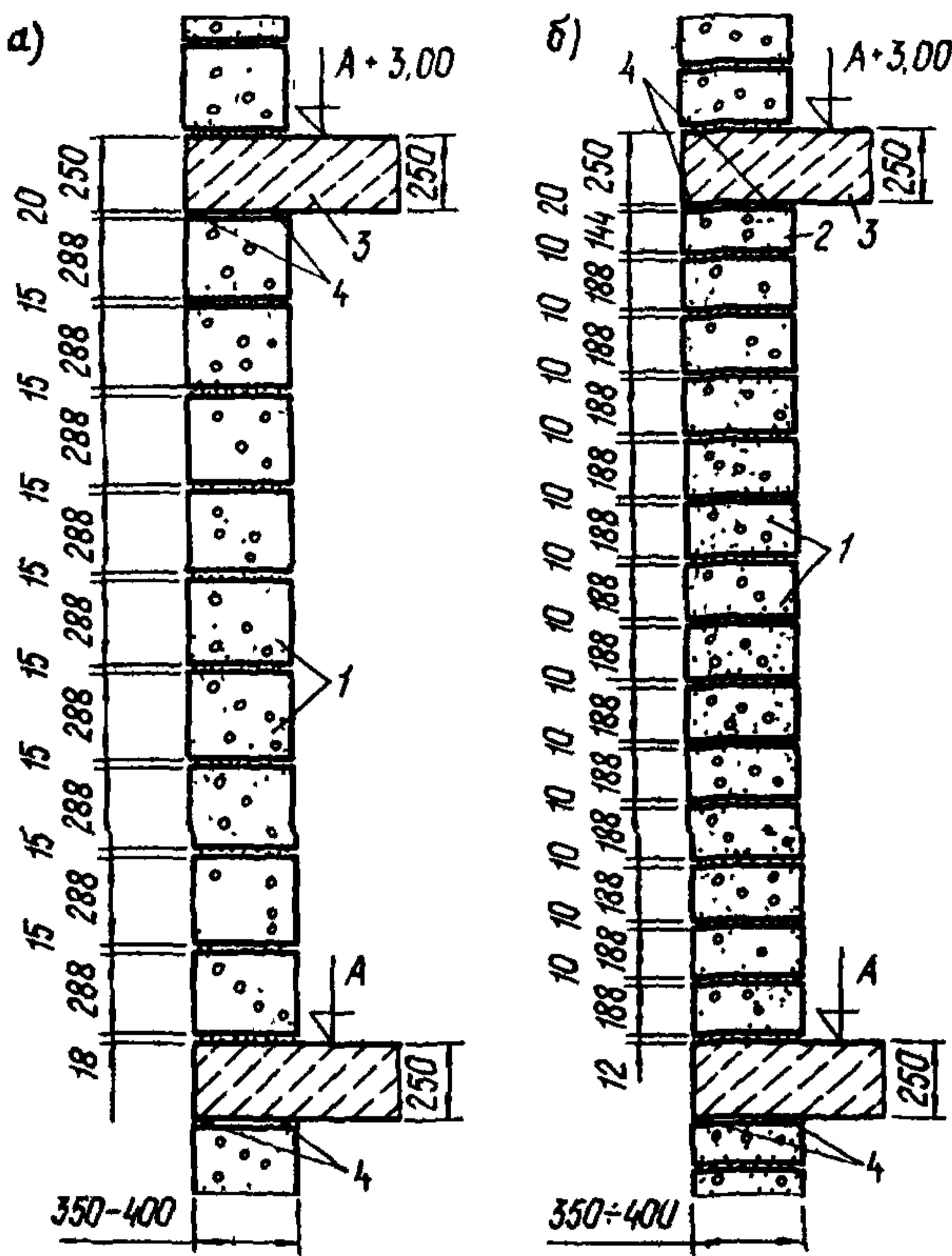
Рис.9. Схема кладки наружных навесных стен из мелких ячеистобетонных блоков
