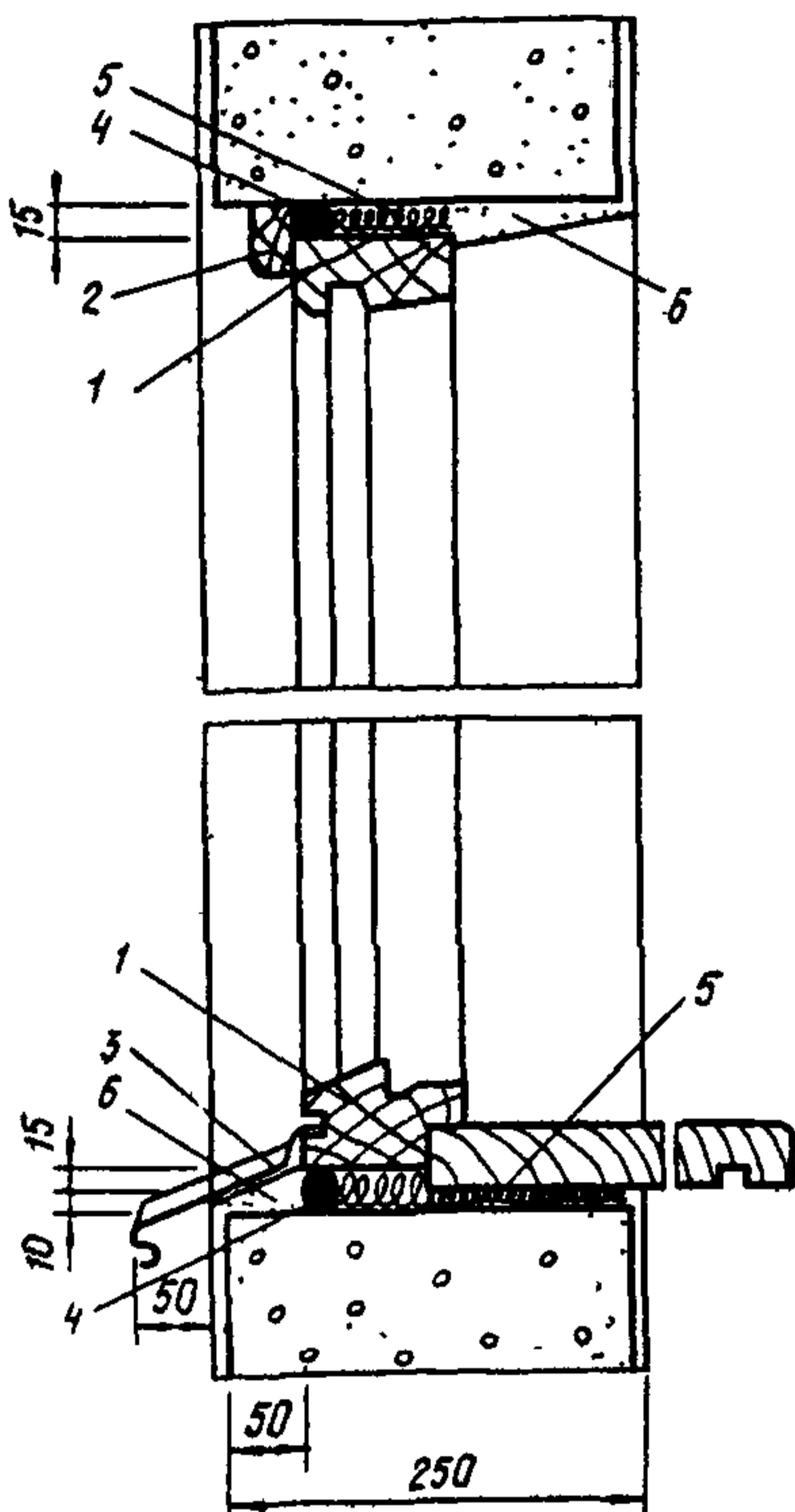
Рис.16. Схема узла заполнения оконного проема
