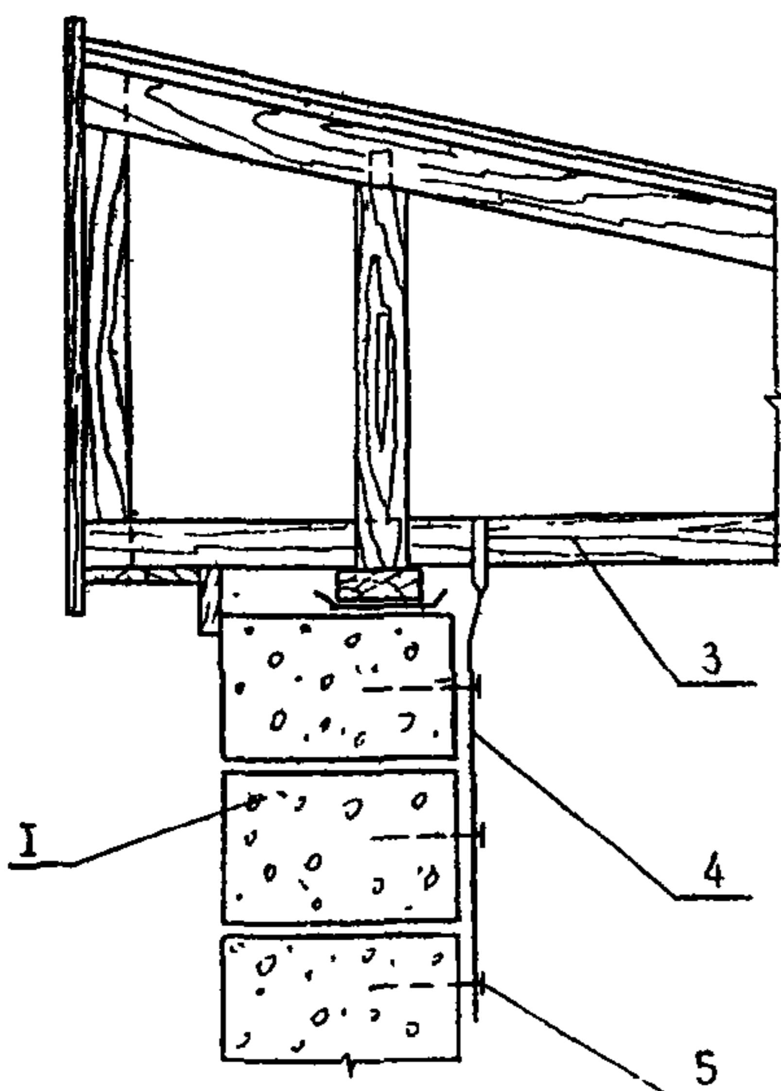
Рис.7. Анкеровка стропильной ноги в пли-те пере-крытия
