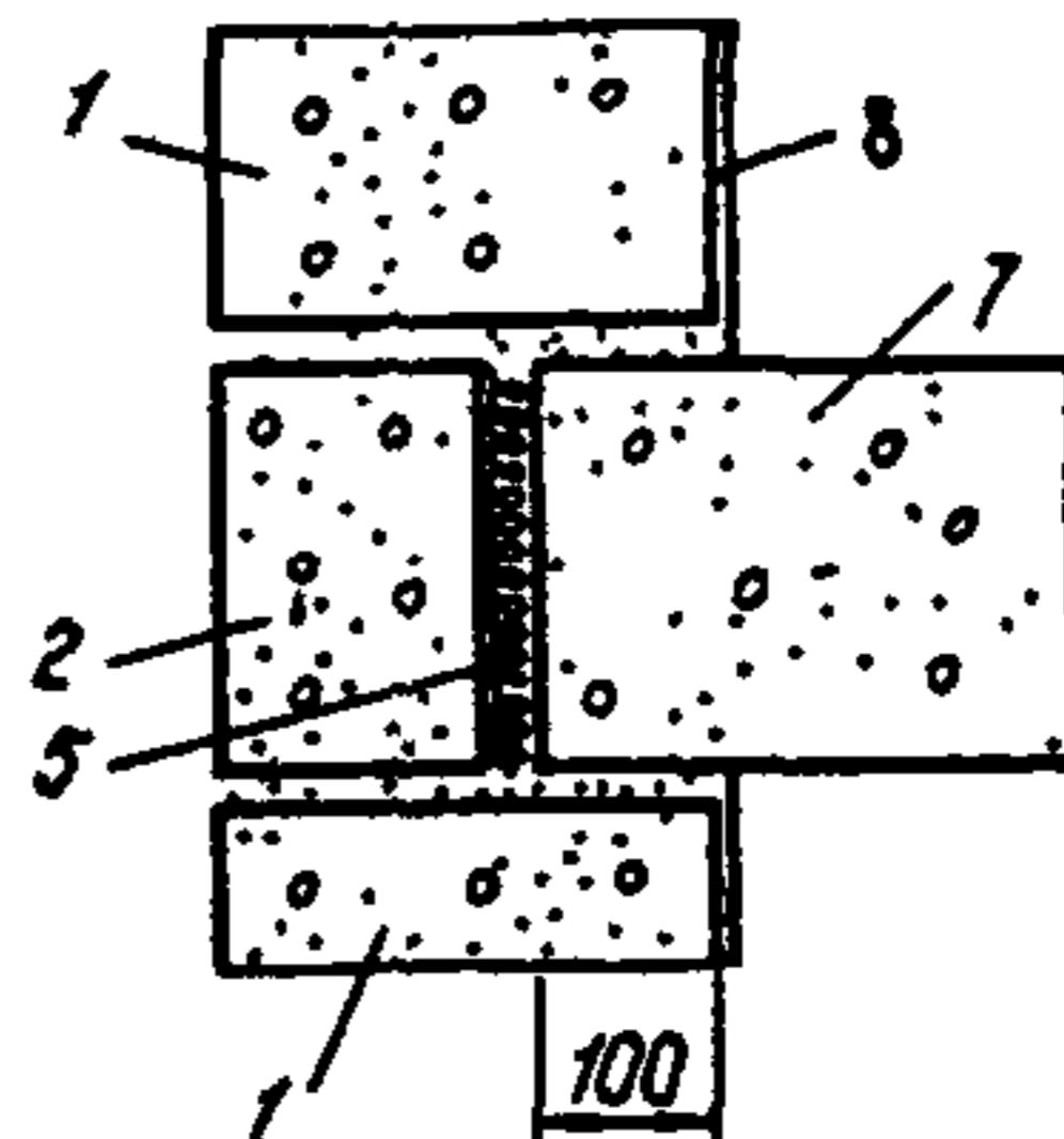
Рис.13. Схема узла опирания плиты перекрытия на стены из ячеистого бетона
