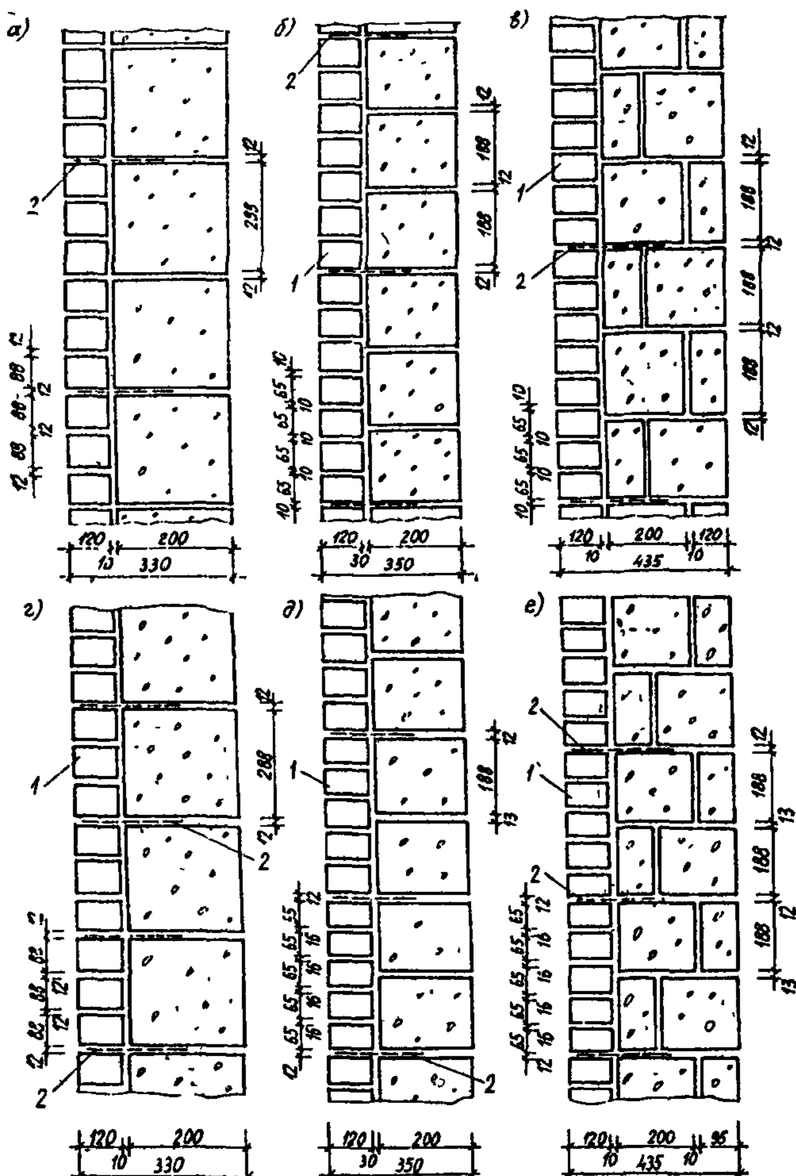
Рис. 5. Типы кладок стен из мелких ячеистобетонных блоков с наружной облицовкой в 1/2 кирпича
