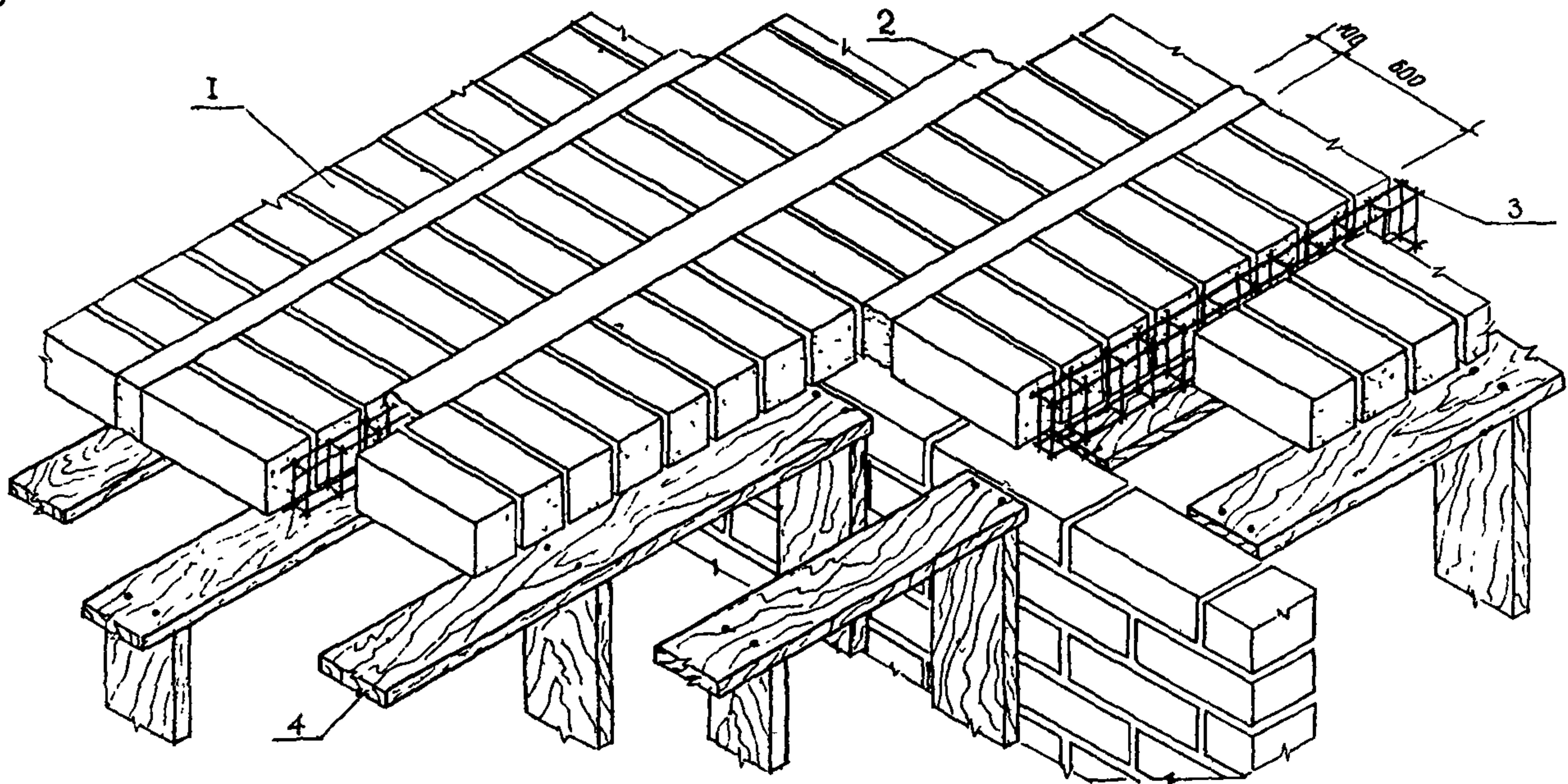
**Рис.10. Вариант сборно-монолитного перекрытия из ячеистобетонных блоков
