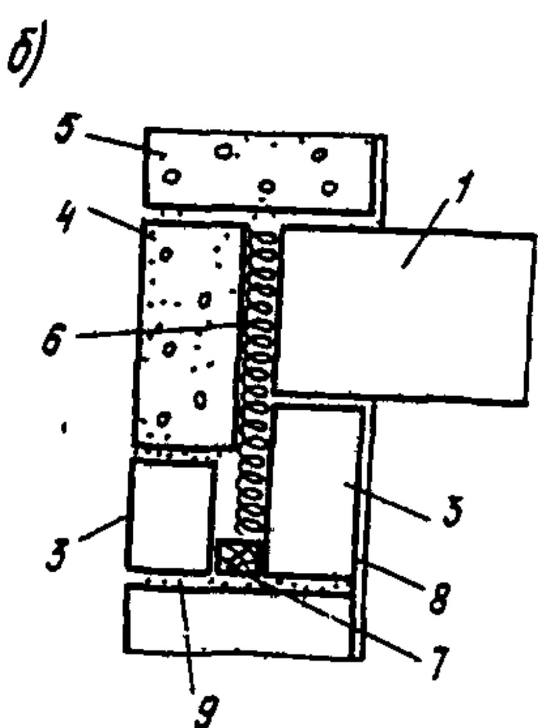
**Рис.14.** Схемы узлов опирания железобетонного перекрытия
