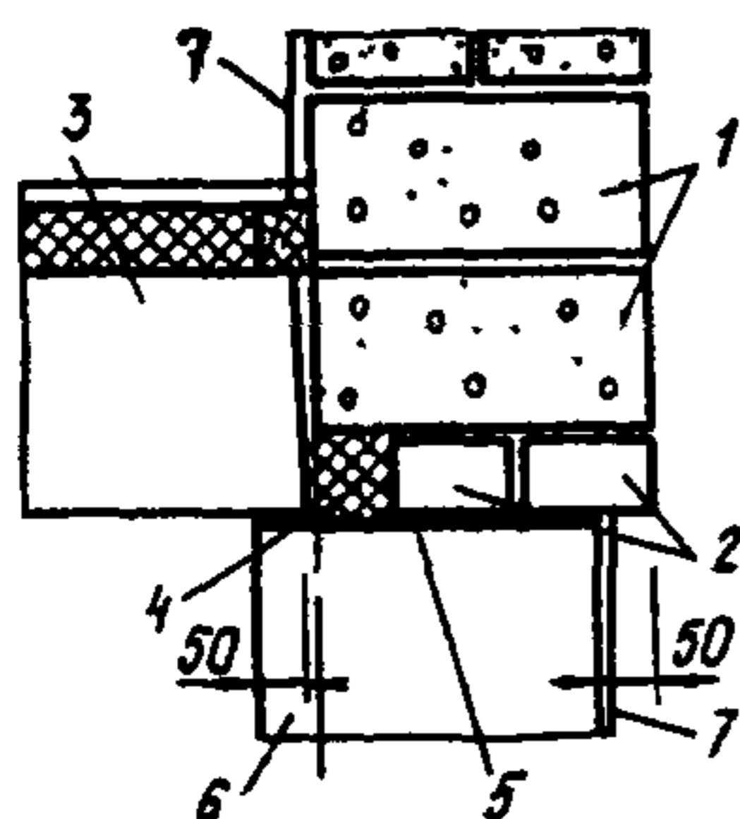
Рис.12. Схема узла цоколя здания из ячеистобетонных блоков
