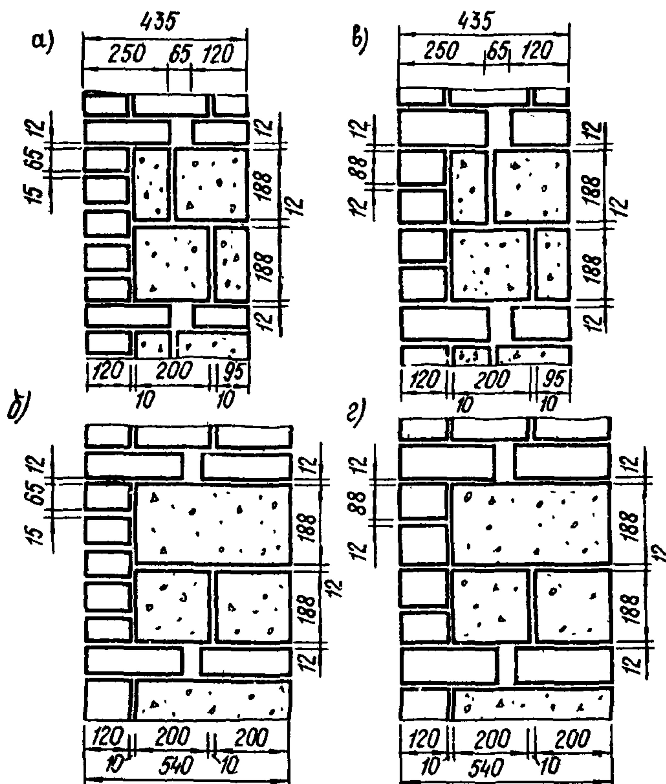
Рис. 6. Типы кладок стен из мелких ячеистобетонных блоков толщиной в полтора и два блока с наружной облицовкой в 1/2 кирпича с перевязкой прокладными тычковыми рядами
