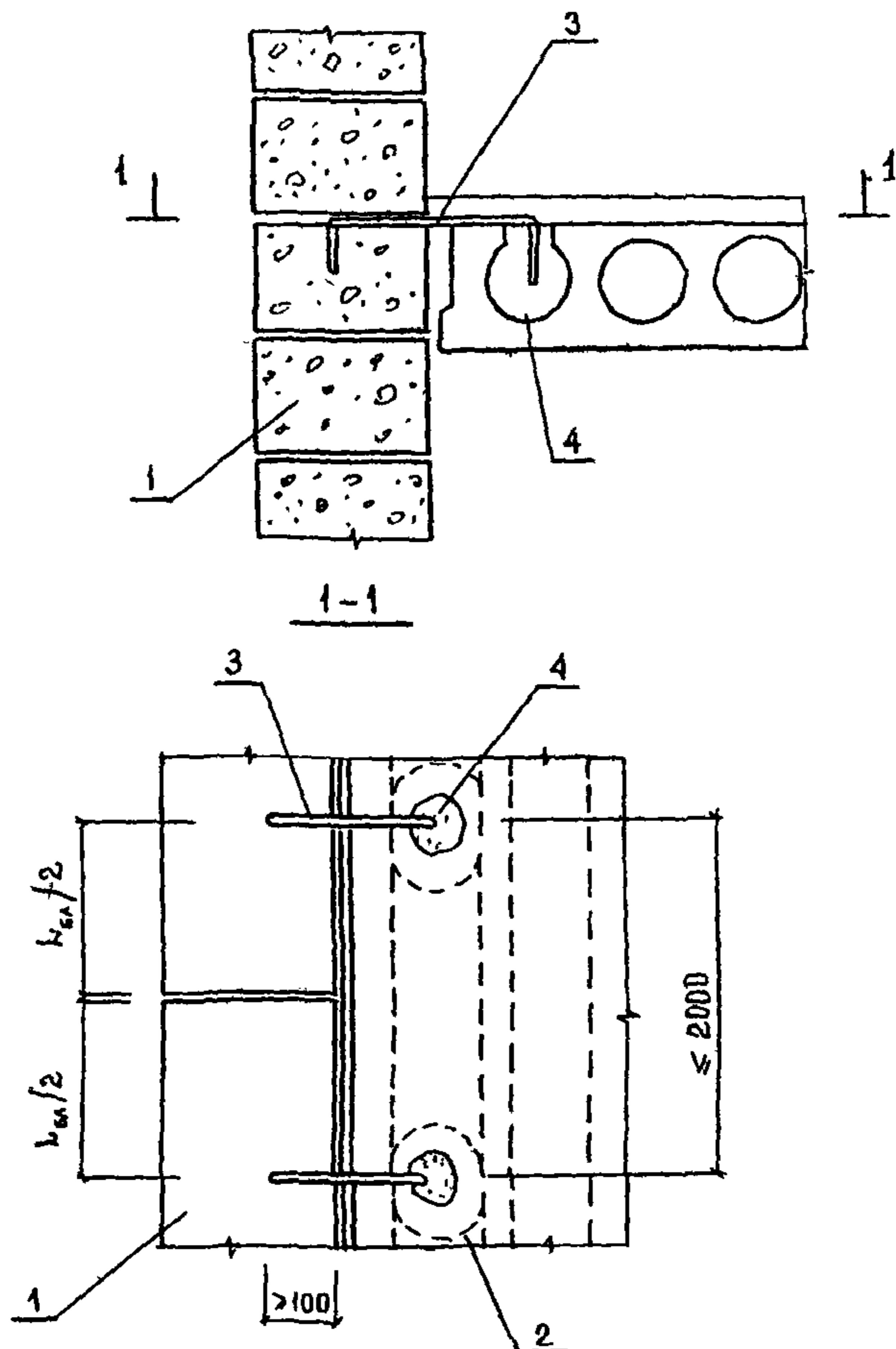
Рис. 9. Анкеровка наружной стены к железобетонной плите перекрытия
