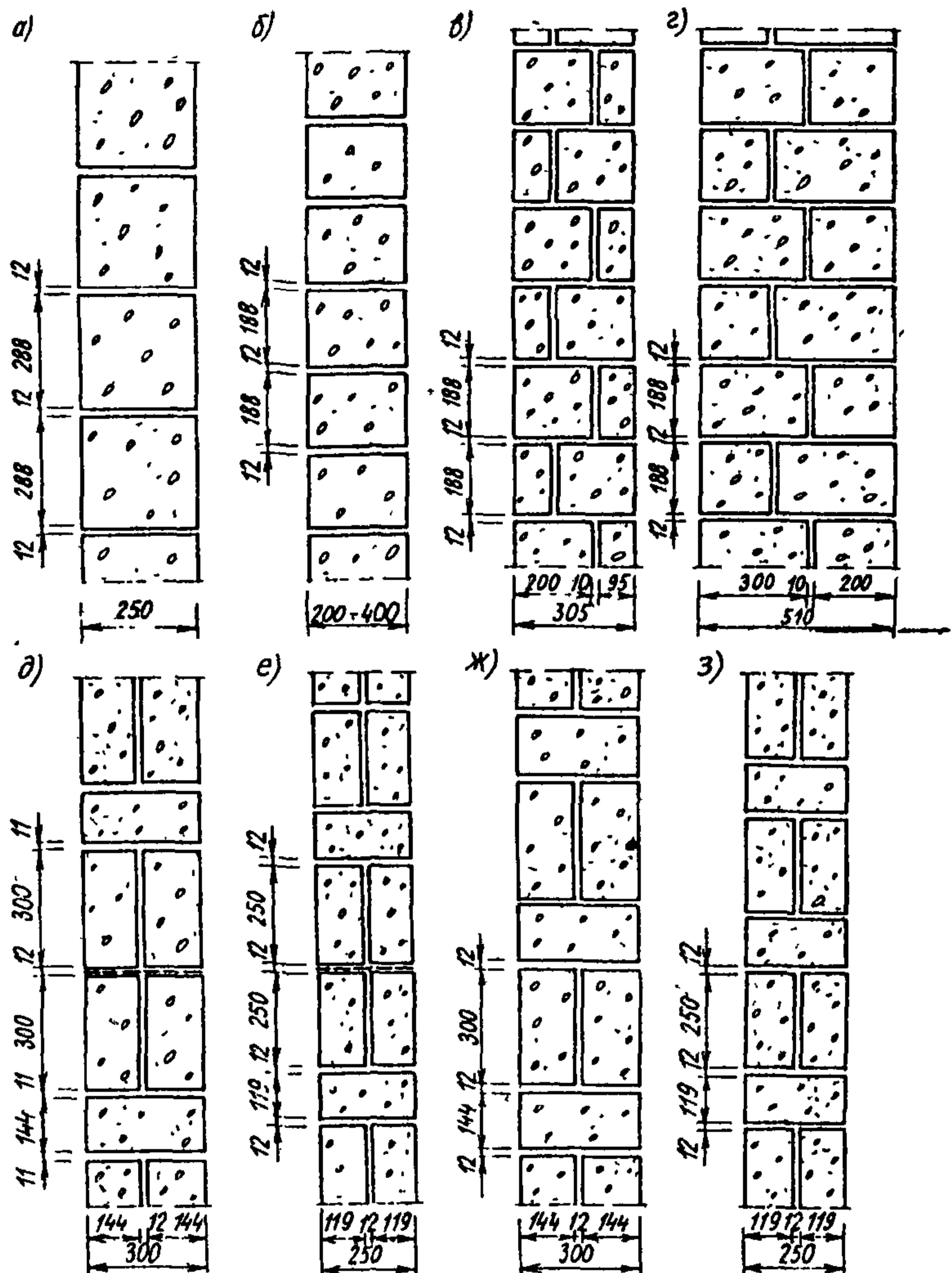
Рис.1. Типы кладки стен из мелких ячеистобетонных блоков
