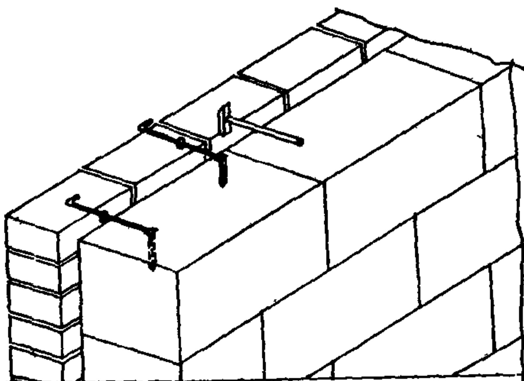
Рис.18. Схема установки металлических скоб
