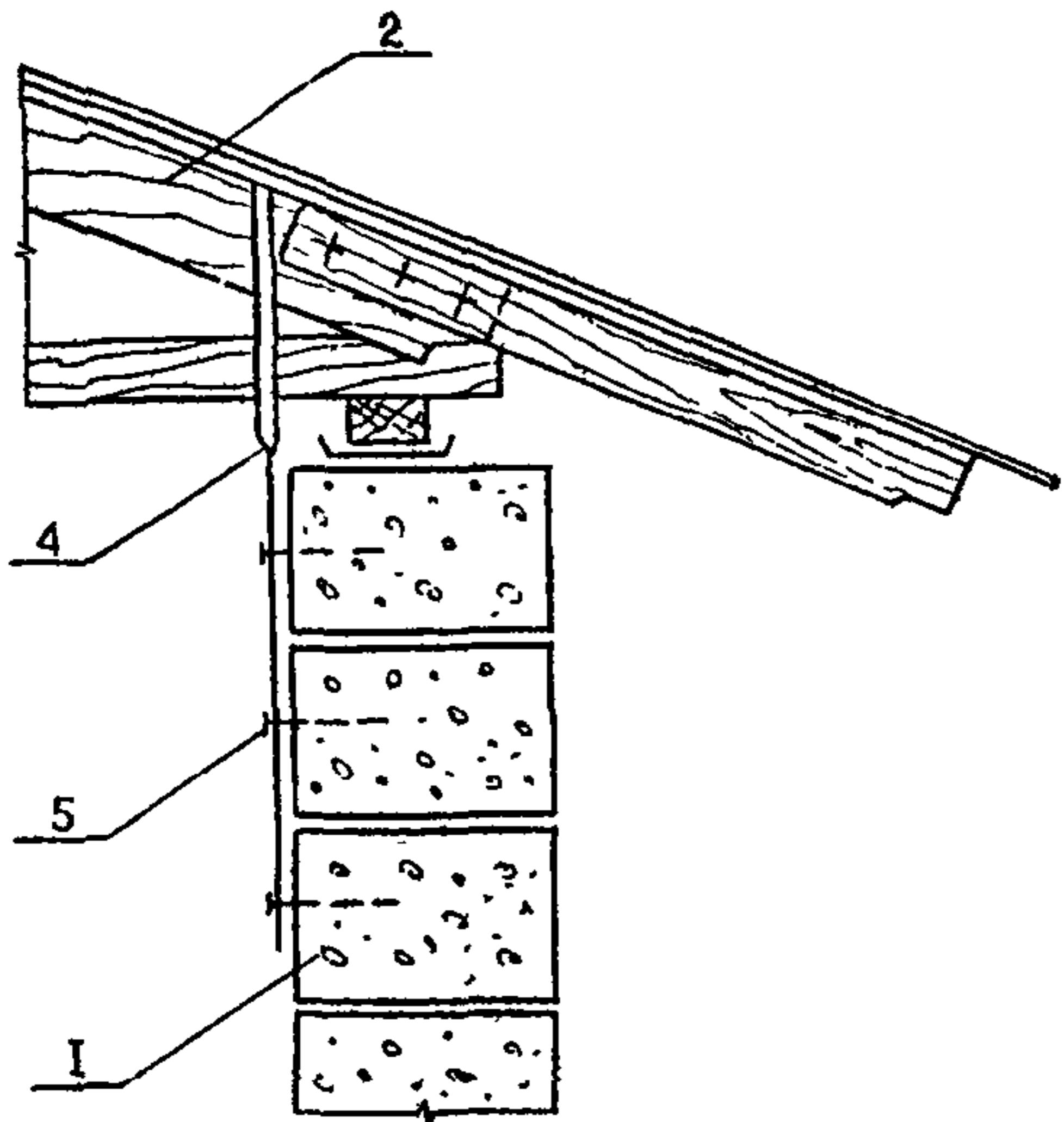
Рис. 6. Анкеровка конструкций крыш в стенах хозпостроек
