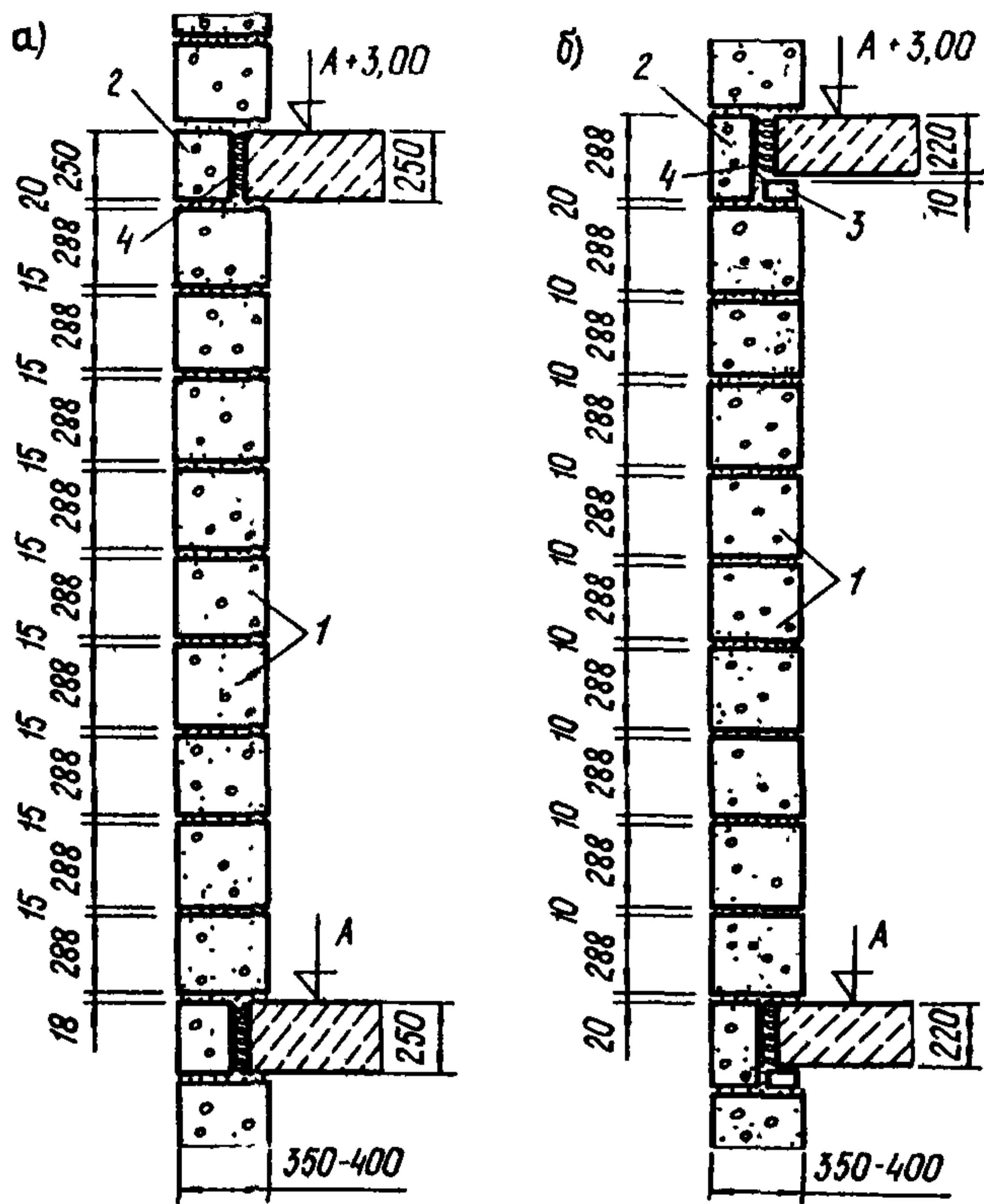
Рис. 7. Схема кладки наружных несущих стен из мелких ячеистобетонных блоков
