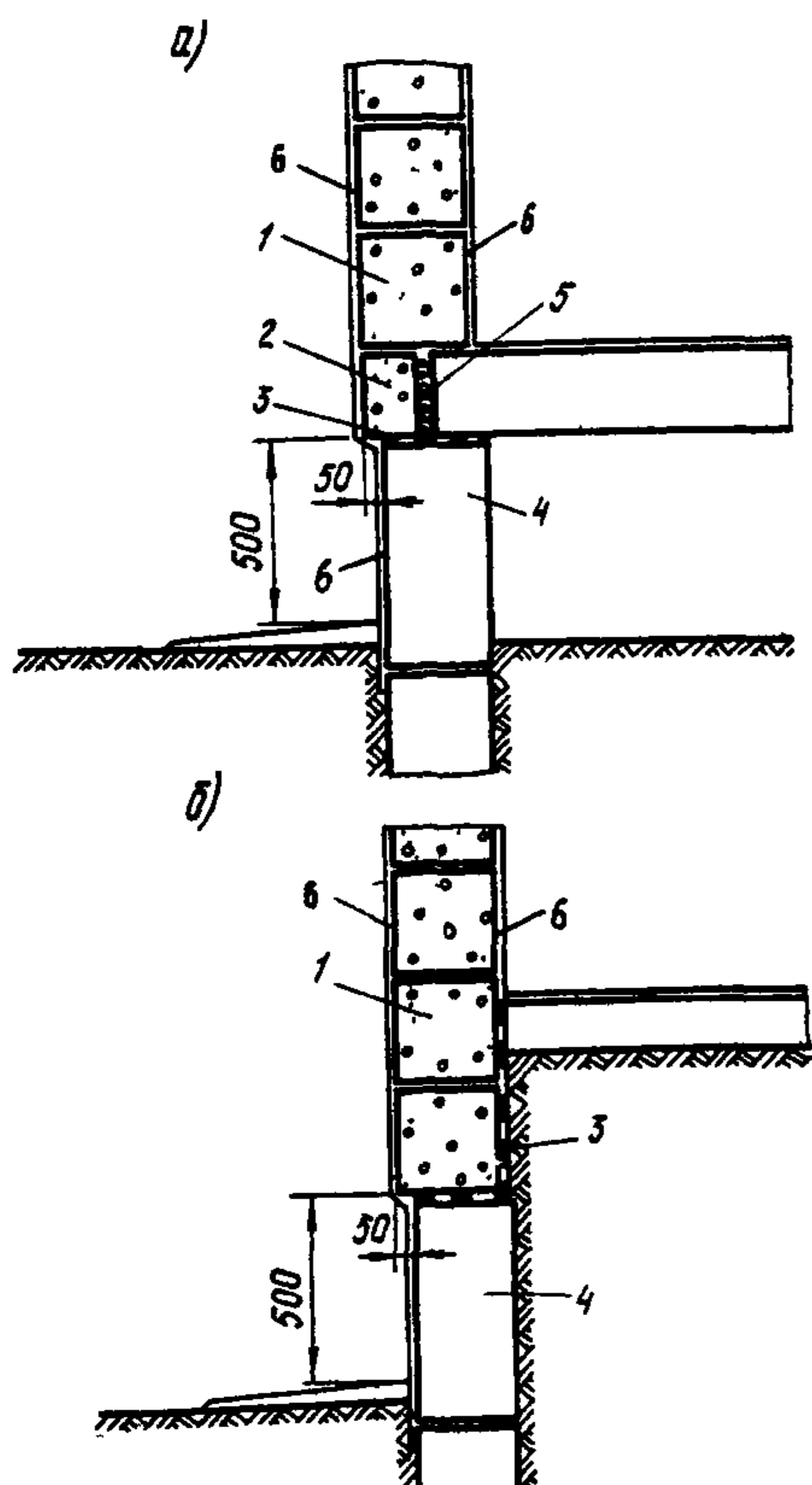
Рис. 11. Схема гидроизоляции стен из мелких ячеистобетонных блоков
