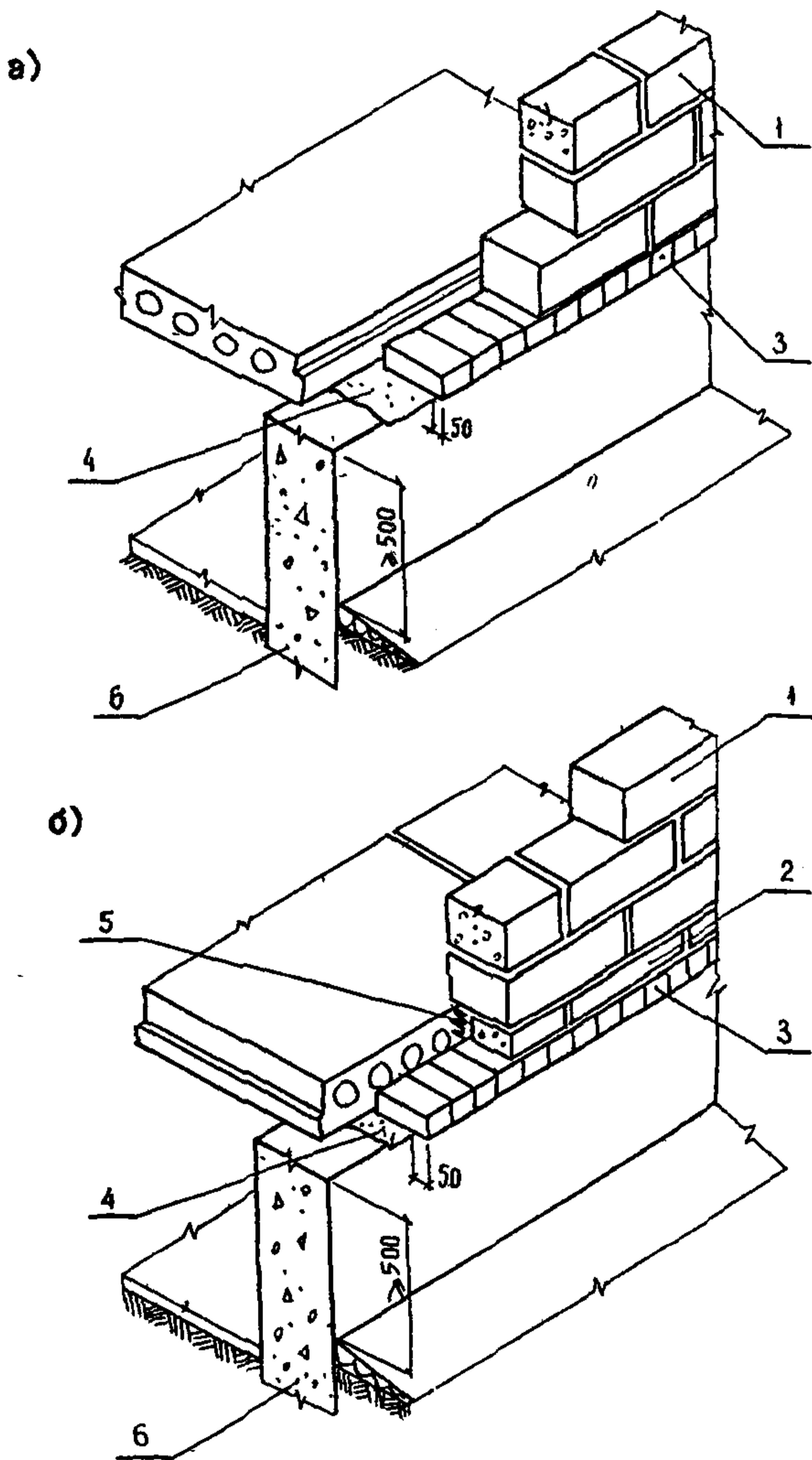
Схемы узла цоколя здания с опиранием первого ряда ячеистобетонных блоков на кирпичи
