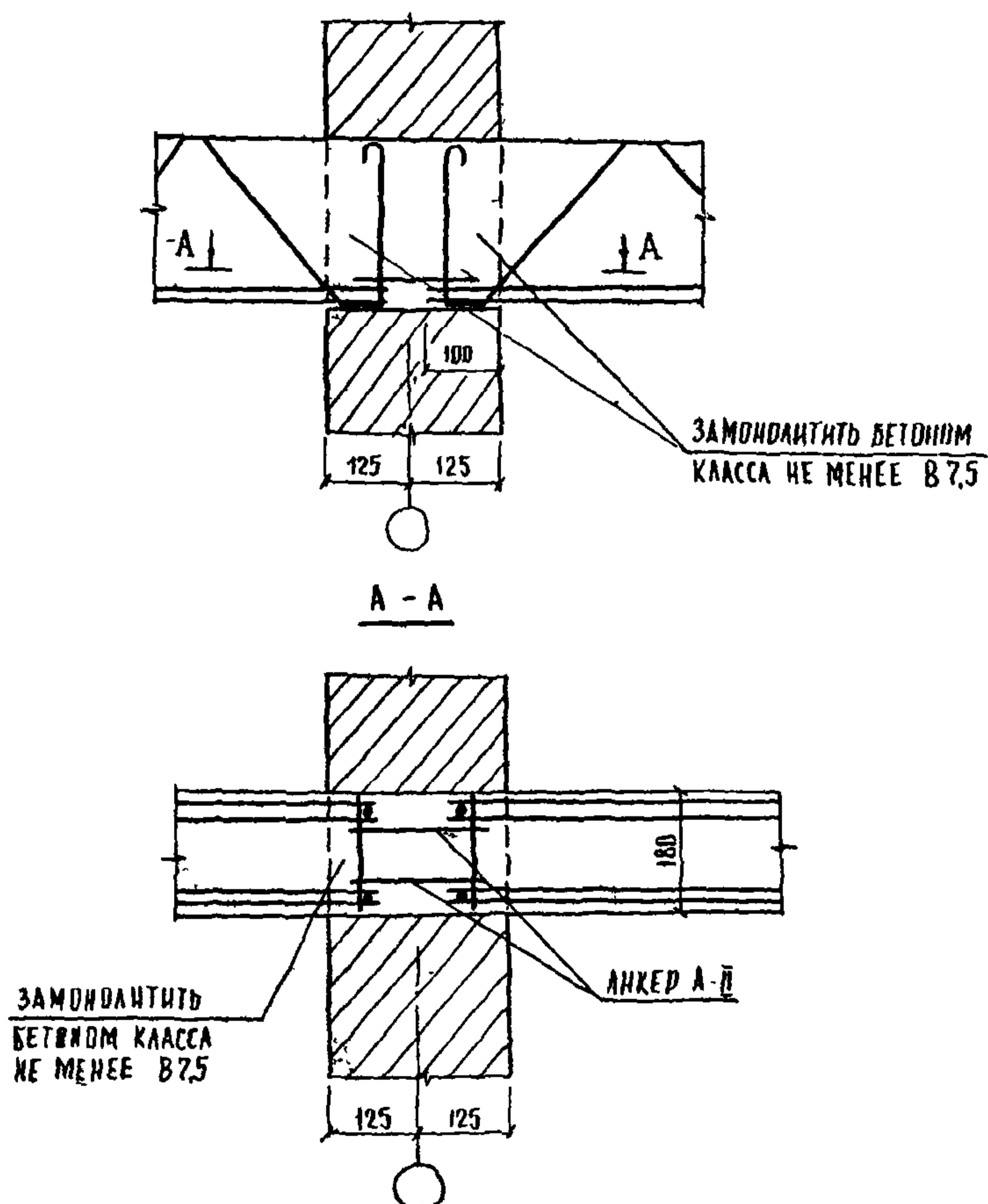
Рис.13. Узел опирания балок-ферм на внутреннюю стену
