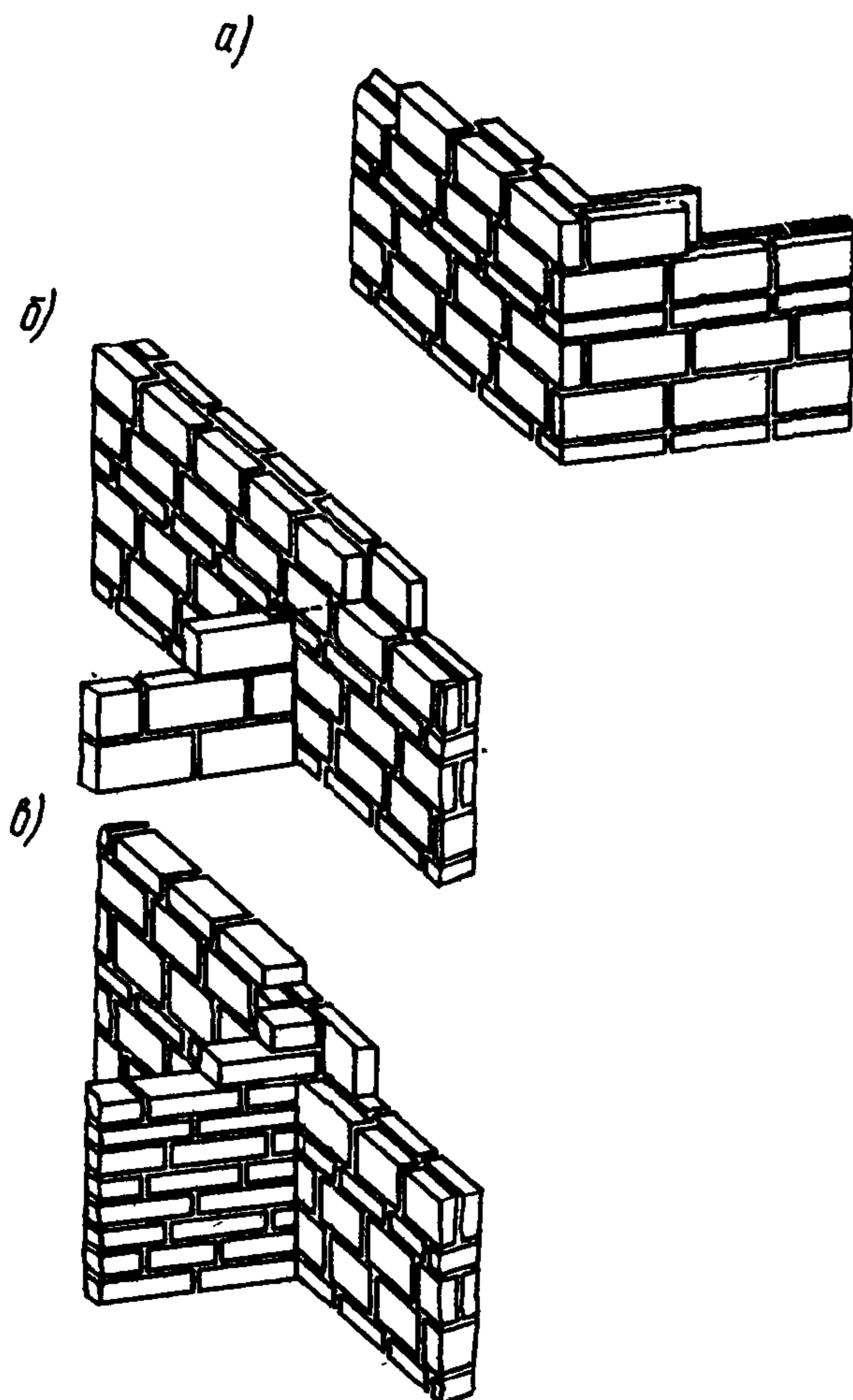
Рис.4. Схема кладки стен толщиной в два блока
