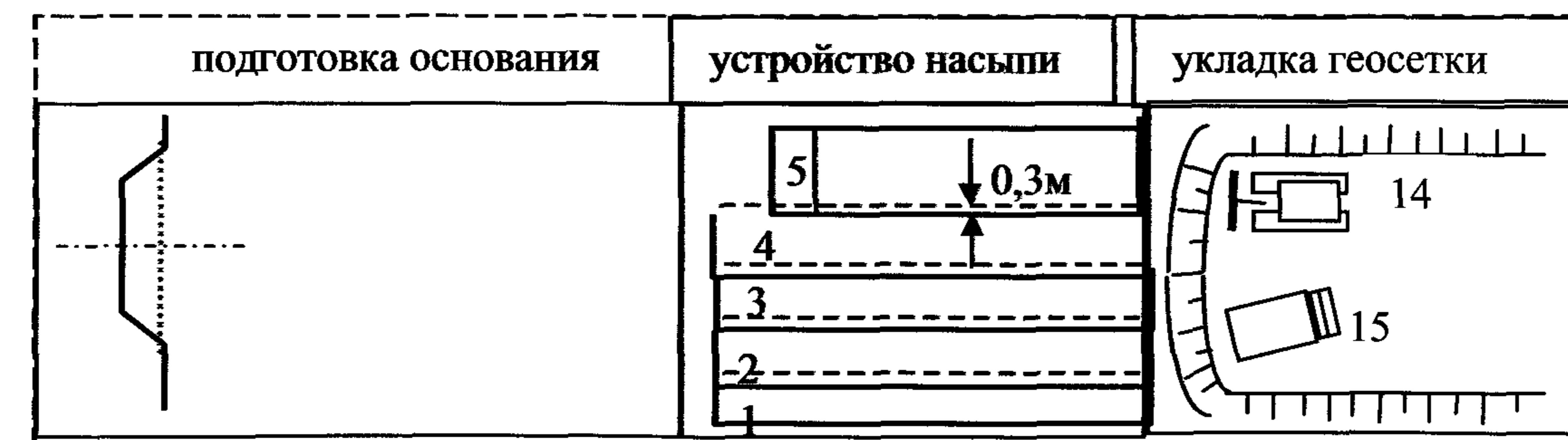
1 - 5 - рулоны (полотна) геосетки ССНП «Нефтегаз» параллельно оси дороги ;
