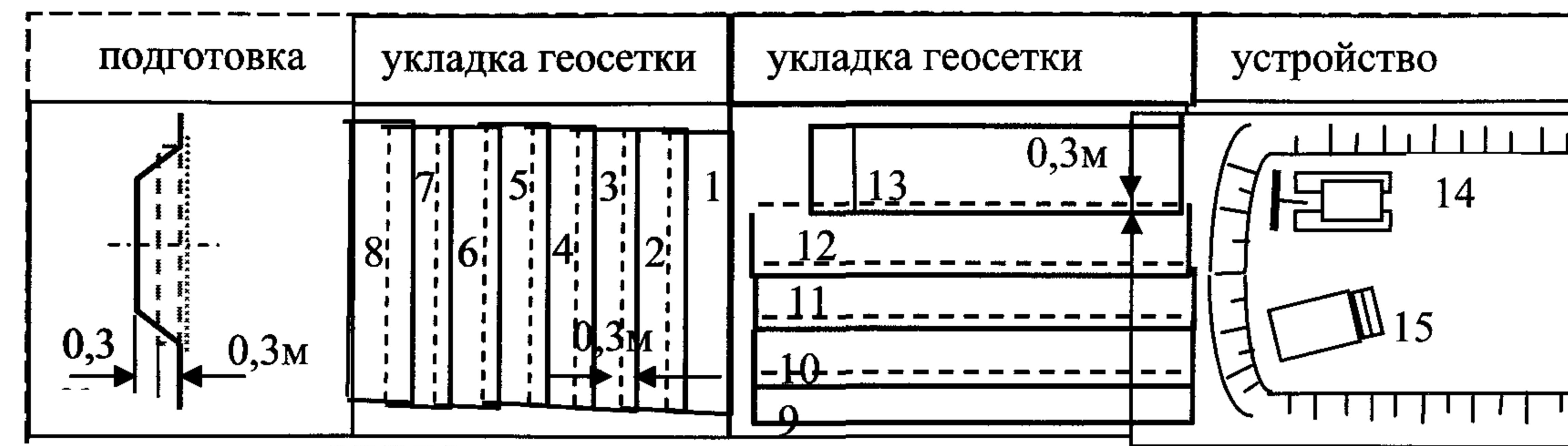
1 - 8 - рулоны (полотна) геосетки ССП «Нефтегаз» перпендикулярно оси дороги ;
