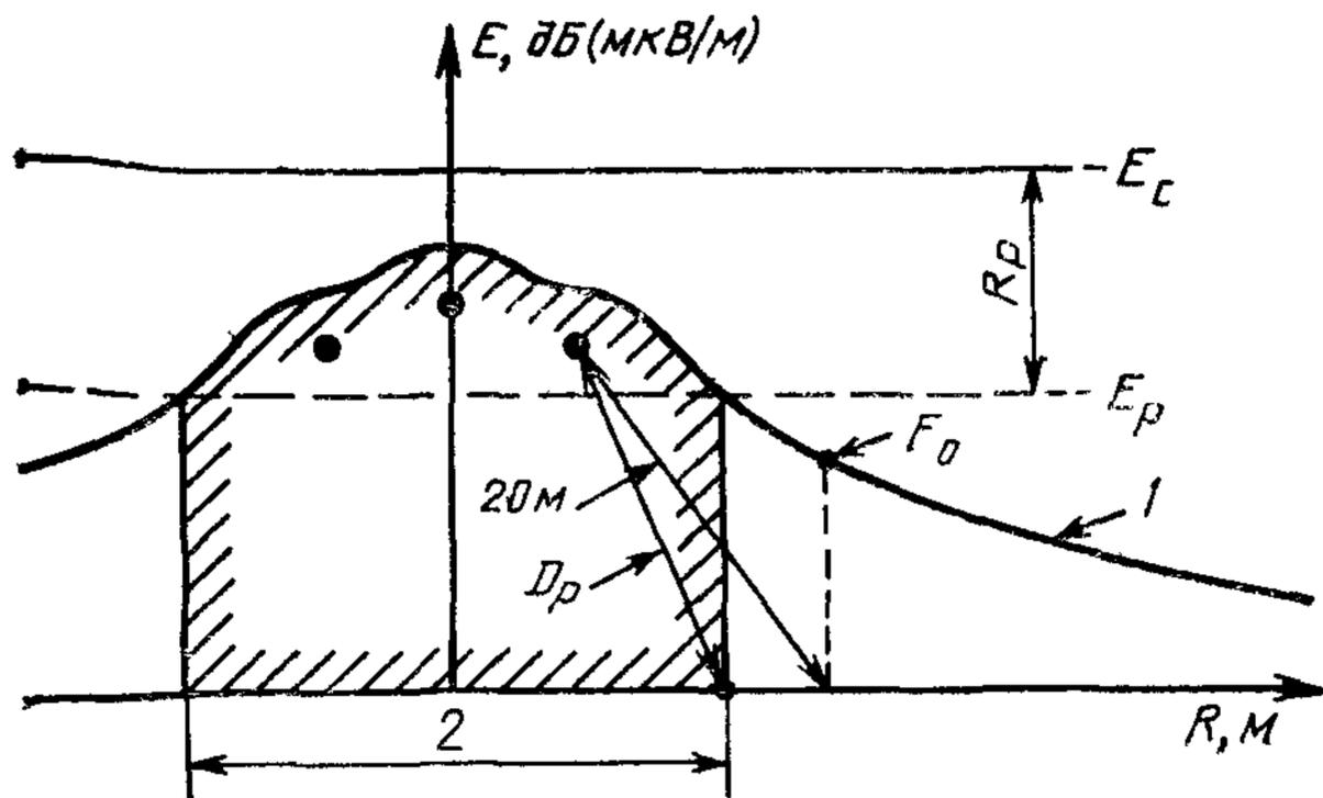
$E_c$  — минимальный защищаемый сигнал,  $R_p$  — отношение сигнал/помеха,  $E_p$  — допустимый уровень помехи;  $E_0$  — базисный уровень помехи,  $D_p$  — «защитное расстояние», 1 — профиль радиопомех для заданных погодных условий, 2 — область, где качество приема не гарантируется
