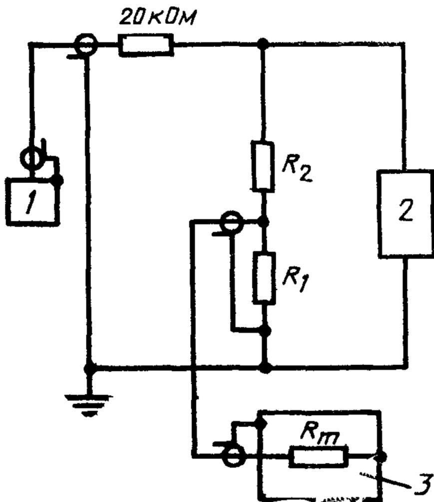
1 — генератор сигналов, 2 — испытуемый объект, 3 — измерительная установка
