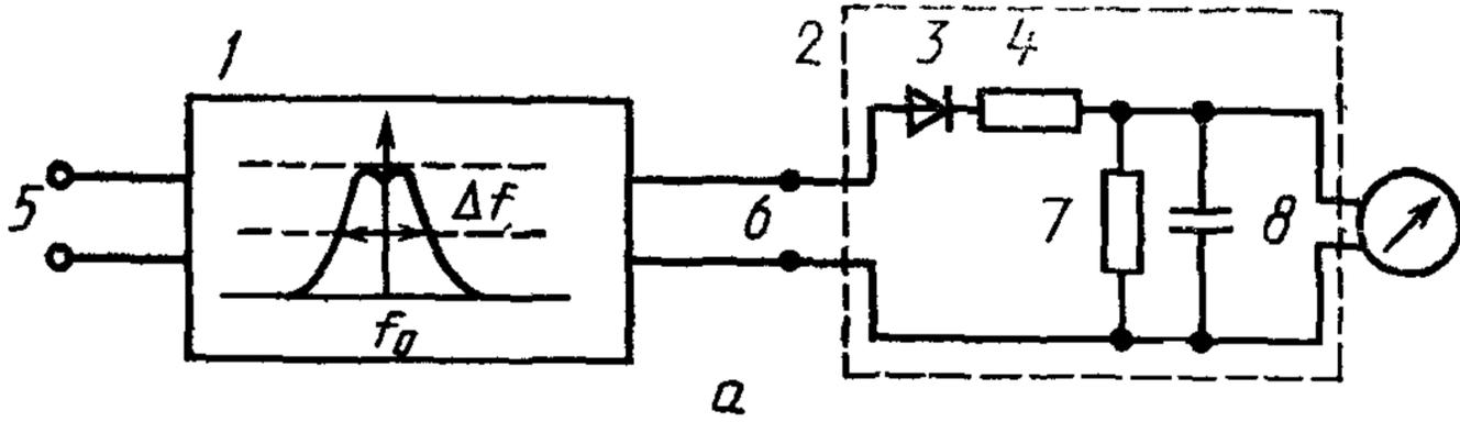
1 — усилитель; 2 — детектор СИСПР; 3 — диод; 4 — зарядный резистор; 5 — вход; 6 — выход; 7 — разрядный резистор; 8 — конденсатор;  $\Delta f$  — ширина полосы пропускания;  $f_0$  — средняя частота
