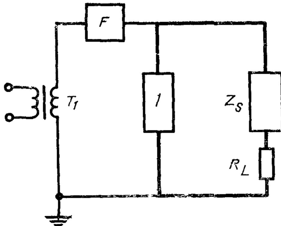
$T_1$  — высоковольтный трансформатор;  $F$  — фильтр;
