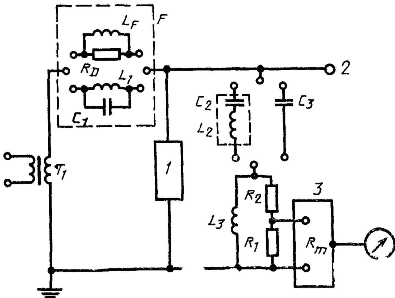
$T_1$  — высоковольтный трансформатор;  $F$  — фильтр;  $L_F$  — катушка индуктивности фильтра;  $R_D$  — демпфирующее сопротивление;  $1$  — испытуемый объект;  $2$  — окончное некоронирующее устройство (нагрузка);  $3$  — измерительная установка
