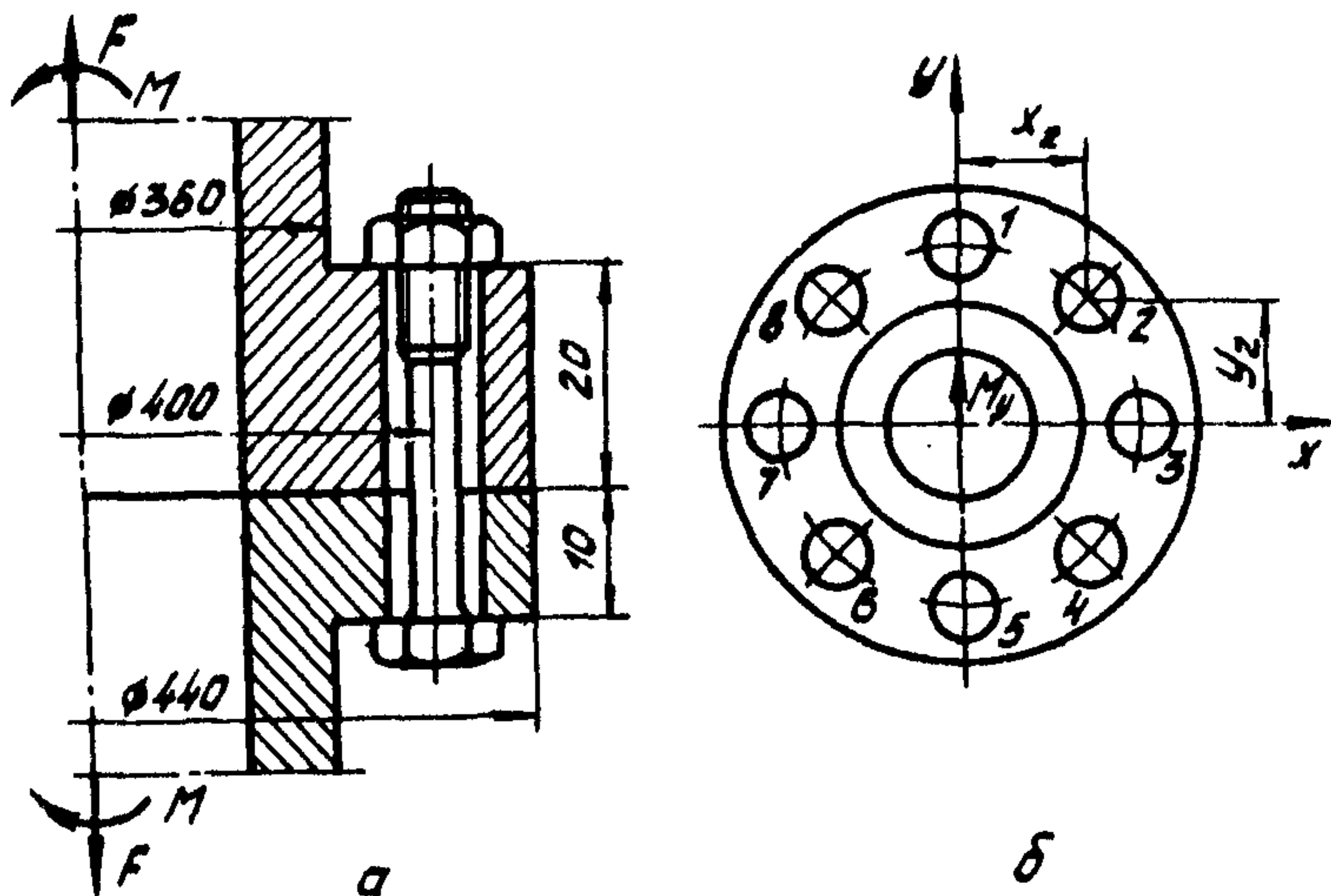
Рис.6.1. К расчету круглофланцевого контактирующего соединения
