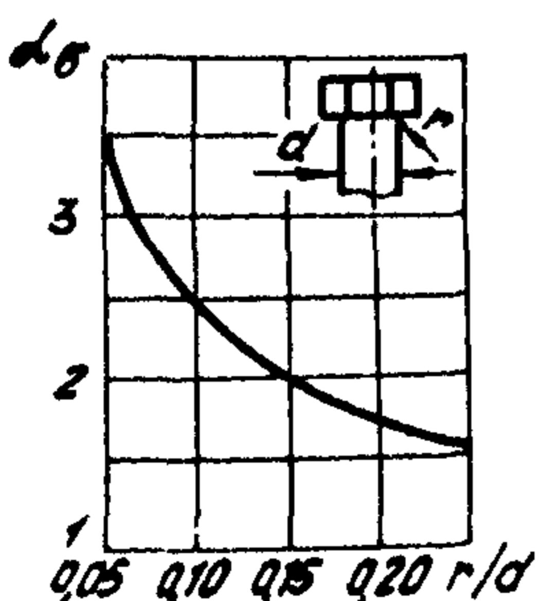
Рис. 2.6. Зависимость теоретического коэффициента концентрации напряжений под головкой болта от отношения радиуса скругления к диаметру с "гл/д"
