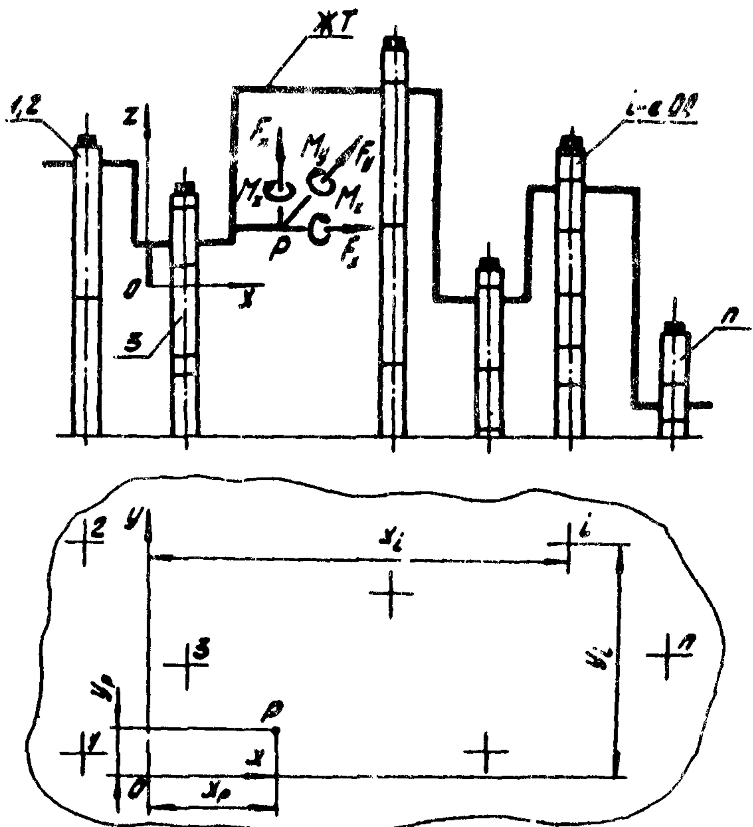
Рис 5. Расчетная схема группового резьбового соединения со ступенчатой диафрагмой:
