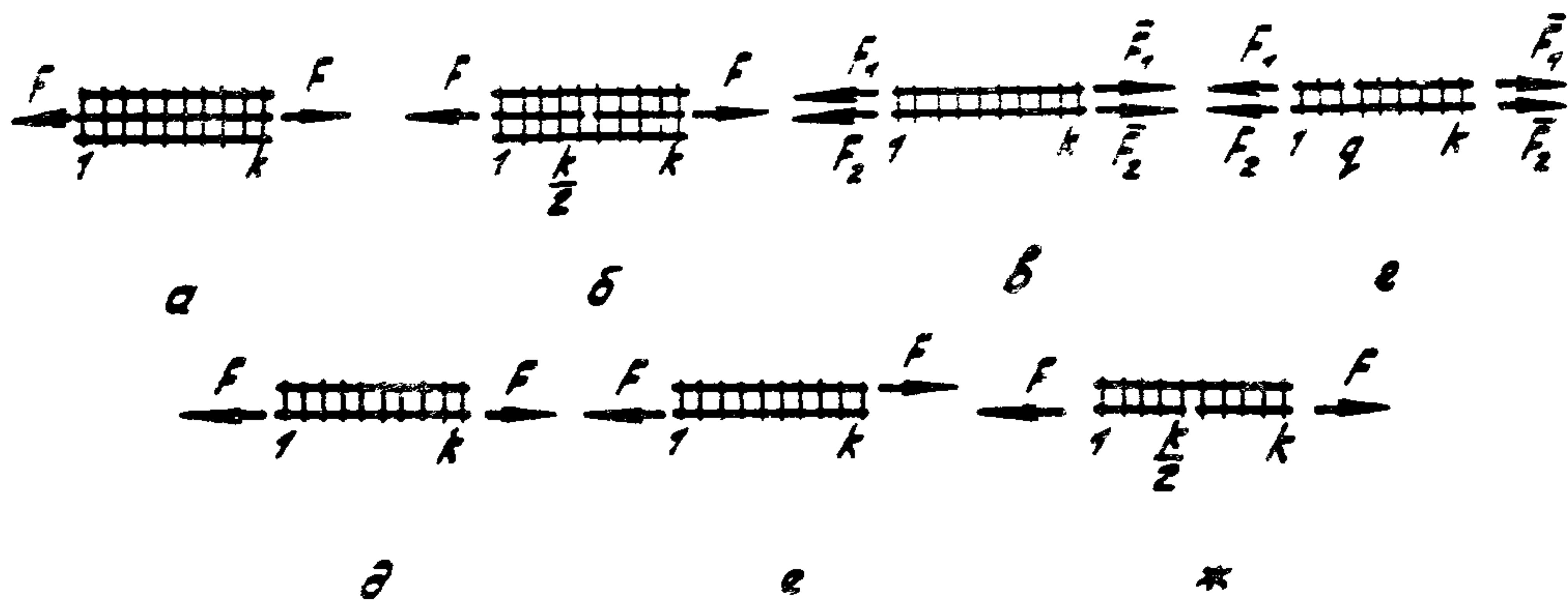
Рис. 3.3. Разновидности конструкций, нагруженных в плоскости стыка
