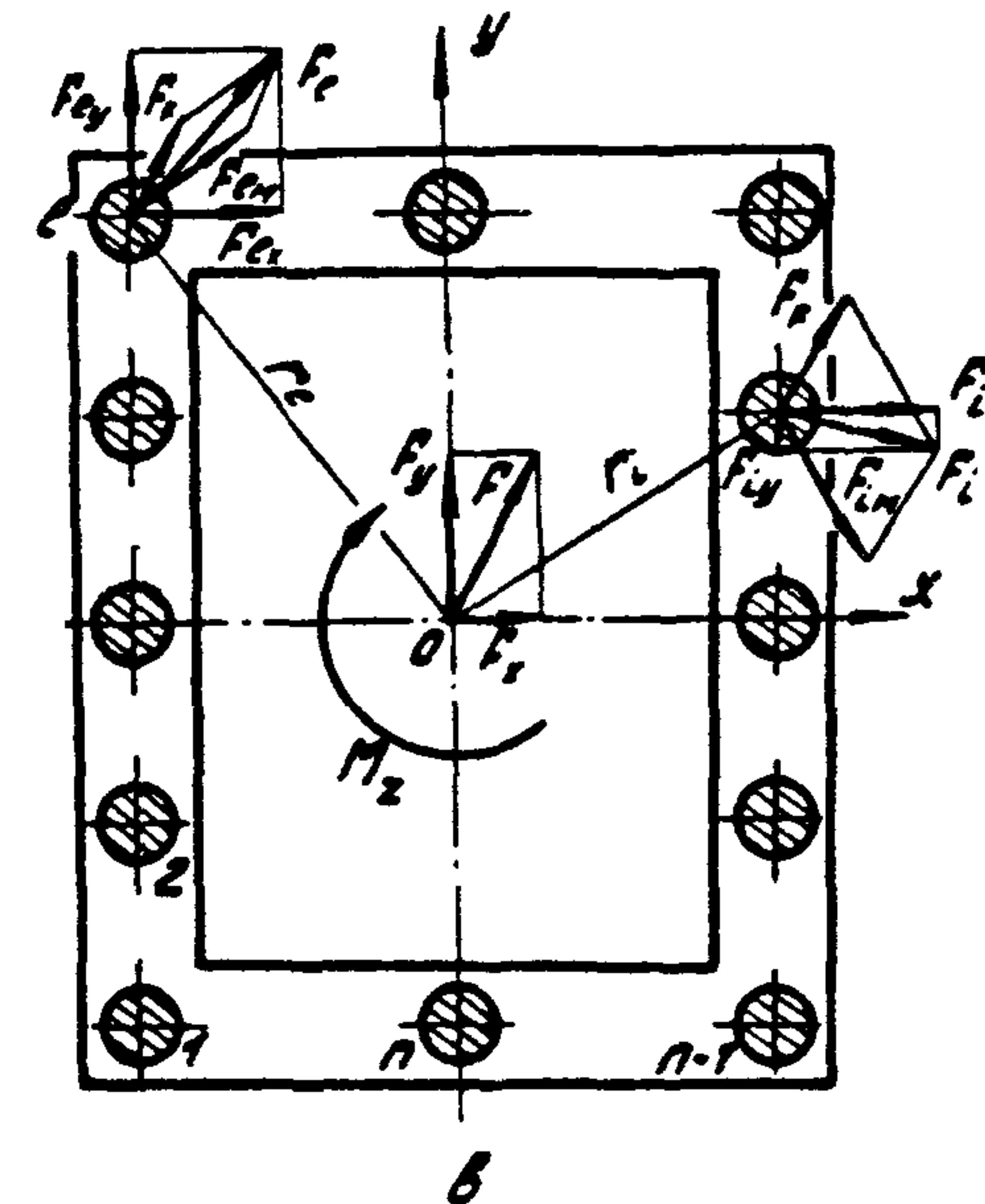
Рис. 3.1. К расчету соединений, нагруженных в плоскости стыка
