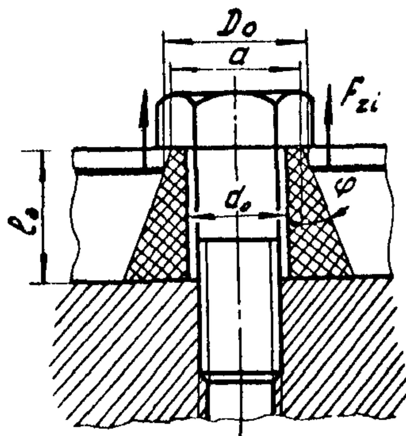
Рис. 2.2. Условное одиночное винтовое соединение
