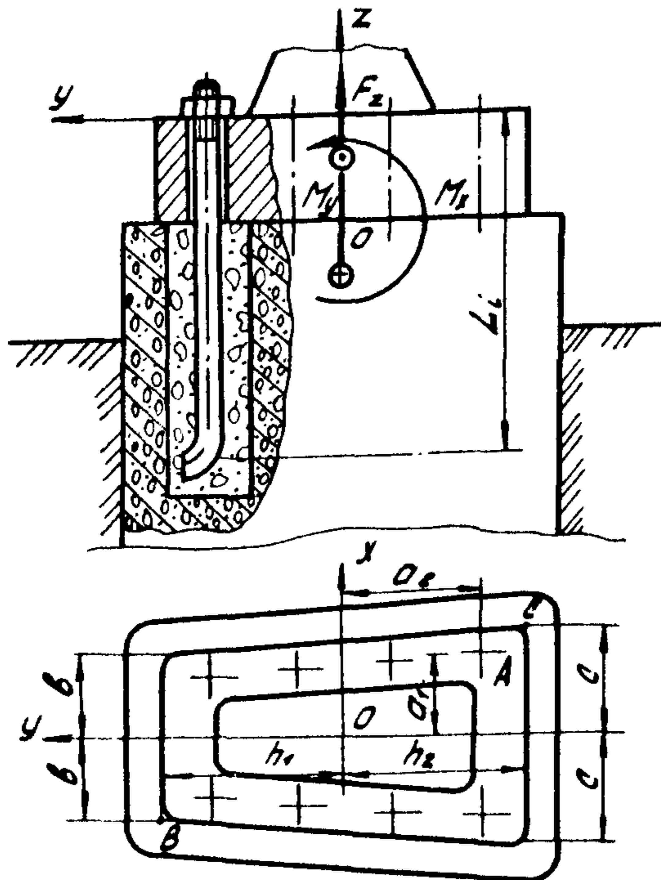
Рис. 2.8. К расчету соединений фундаментальными болтами
