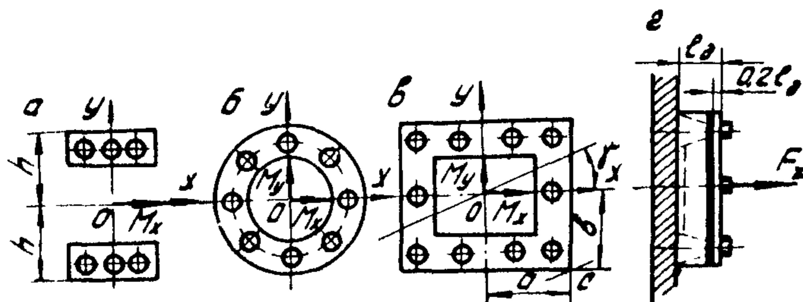
Рис. 2.7. К расчету соединений типа плита – основание: *а* – полосовой стык; *б* и *в* – фланцевые стыки (круглый и прямоугольный); *г* – вид сбоку
