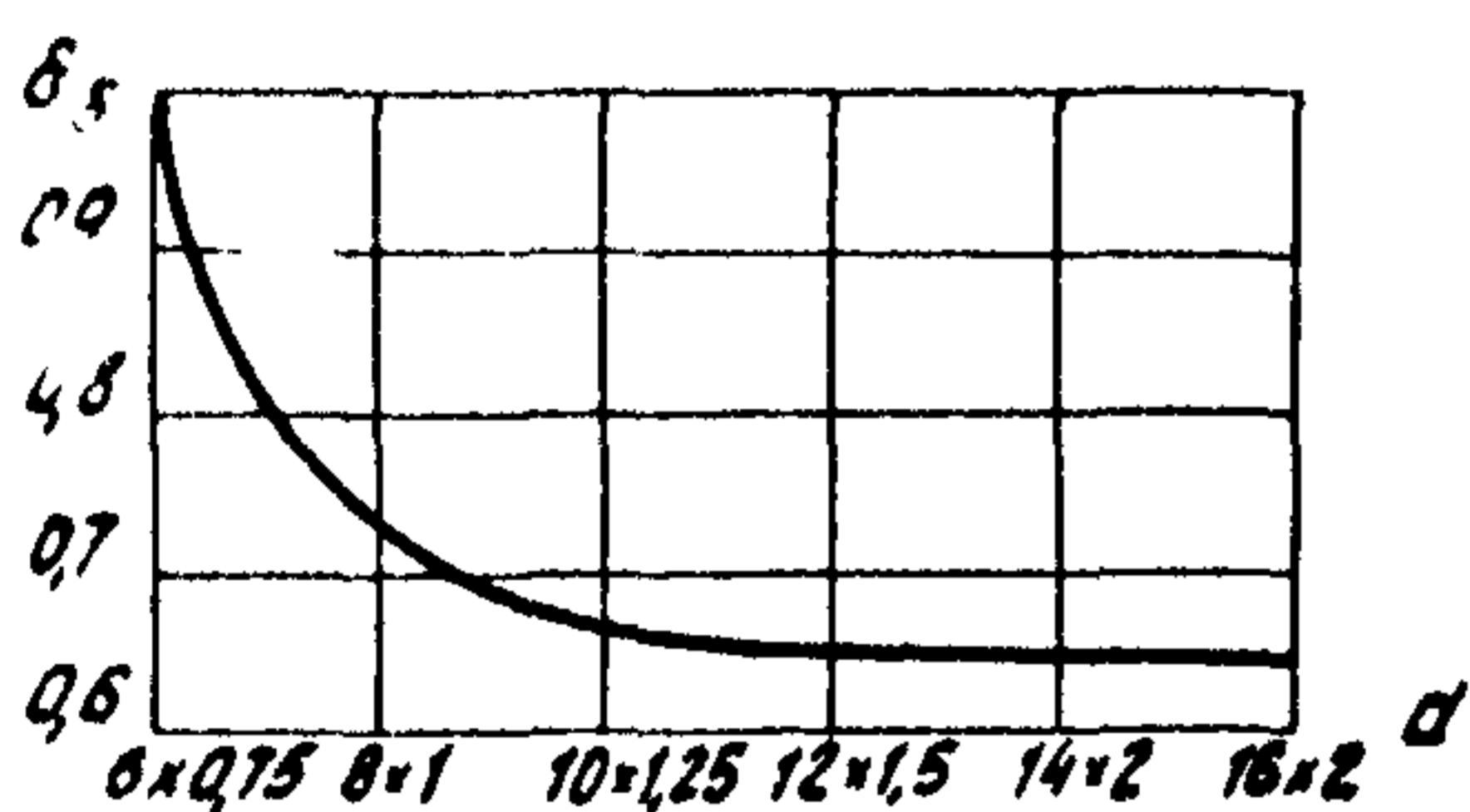
Рис. 2.4. Зависимость масштабного фактора от наружного диаметра болта
