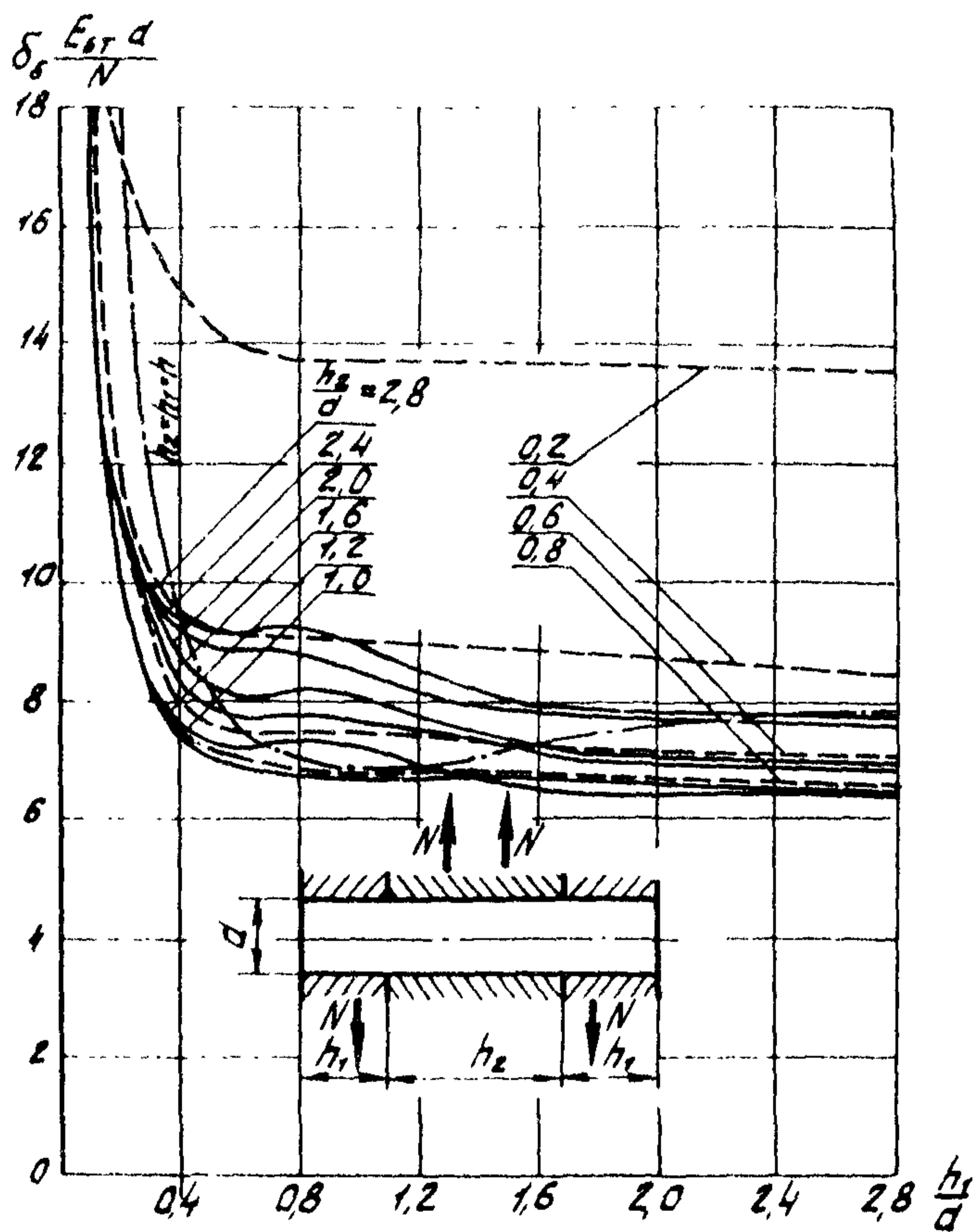
Гис. 5.4. График суммарных перемещений двухсредной конструкции
