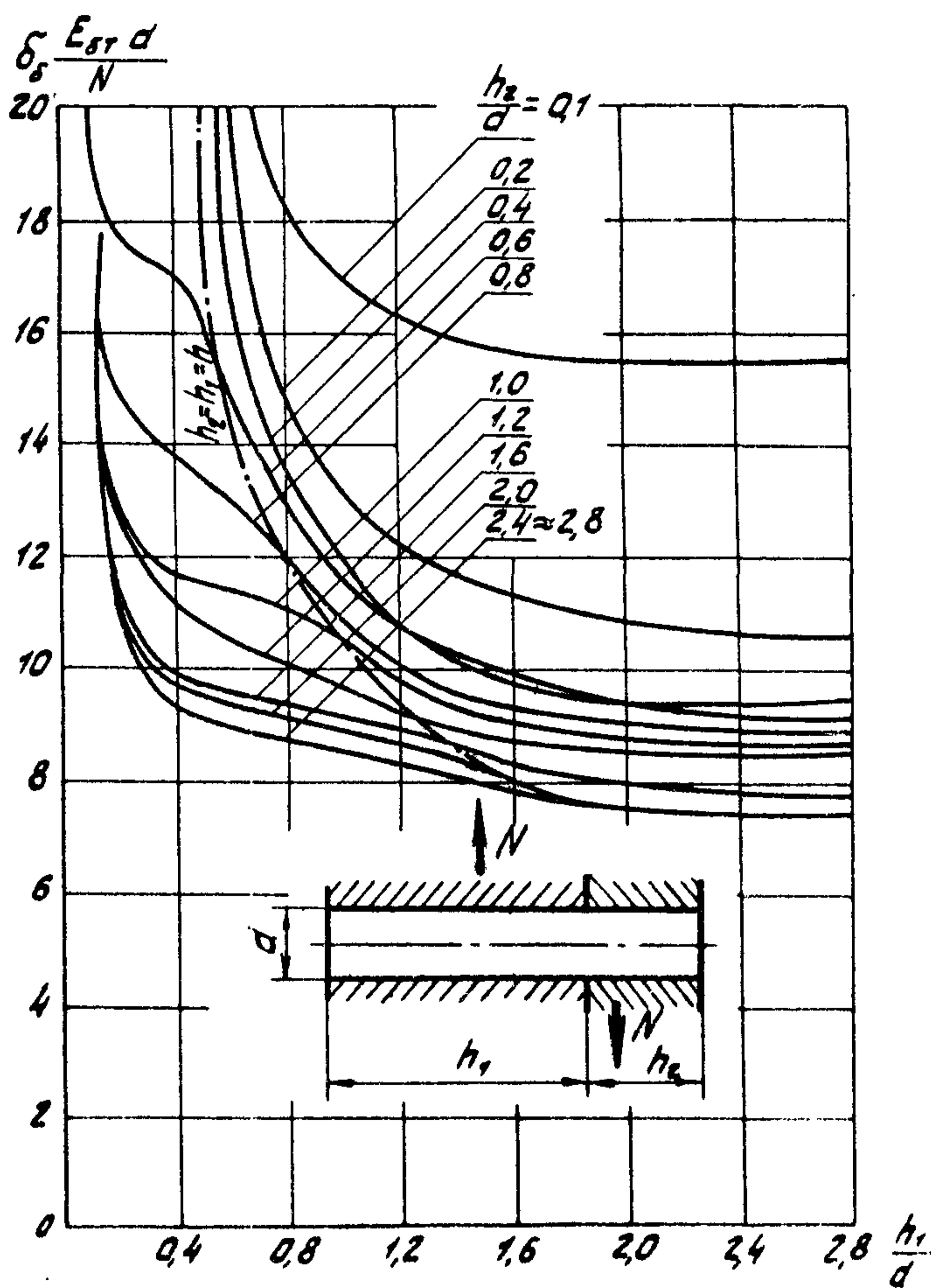
Рис. 5.3. Кривые суммарных перемещений односрезной конструкции
