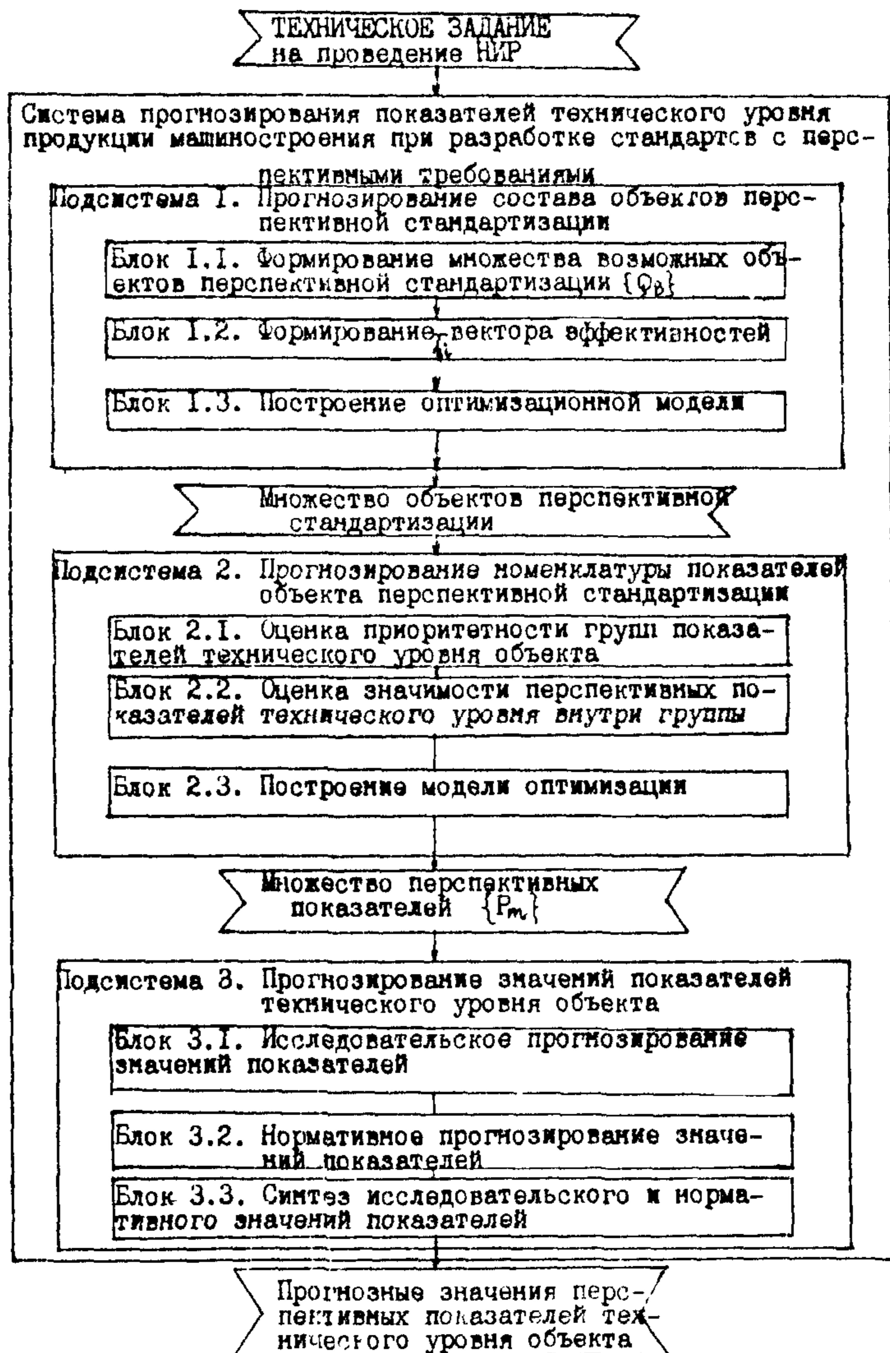
Рис. I. Блок-схема системы прогнозирования показателей технического уровня продукции машиностроения
