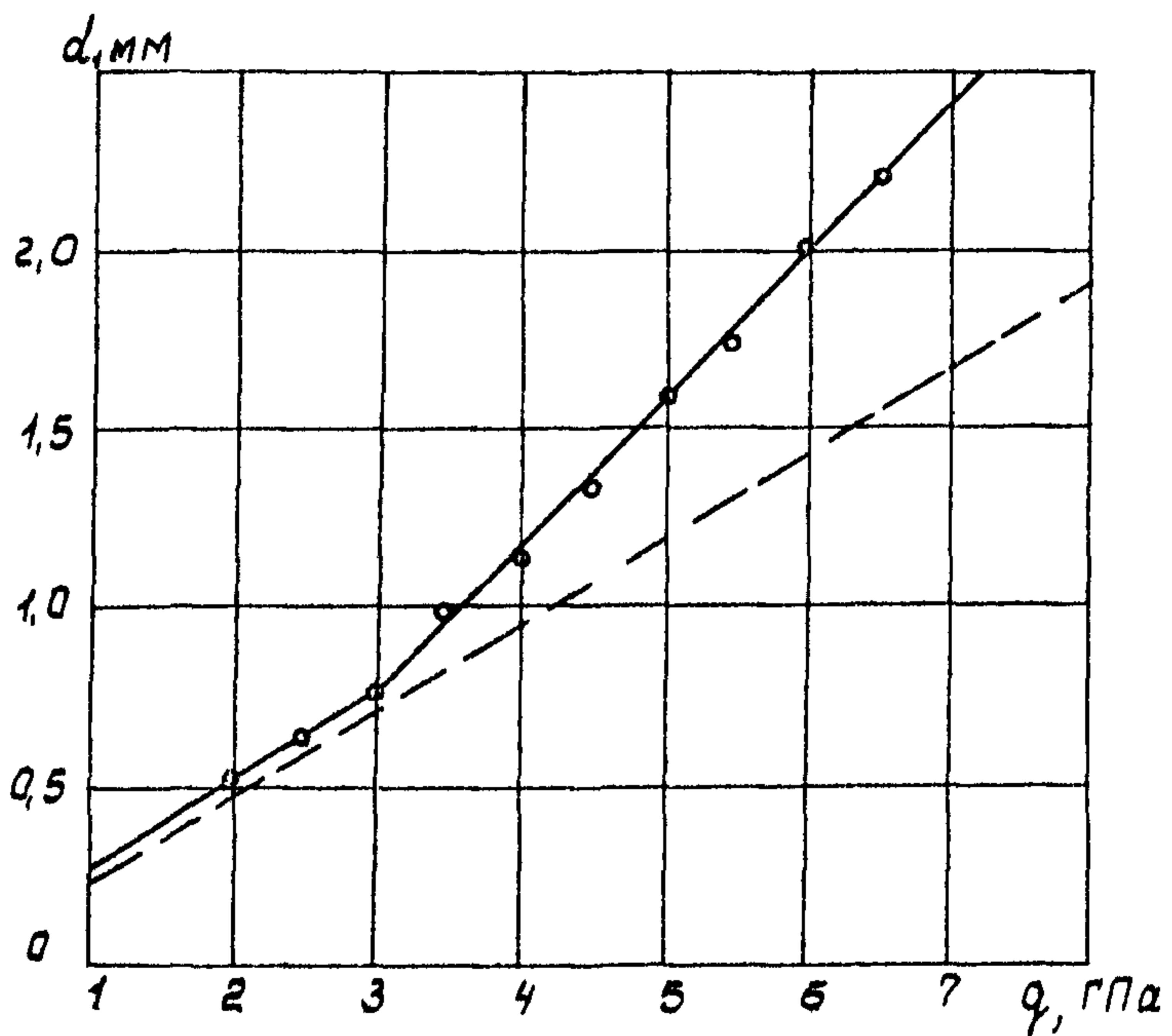
Зависимость диаметра отпечатка от среднего контактного напряжения для стали марки ШХ 15
