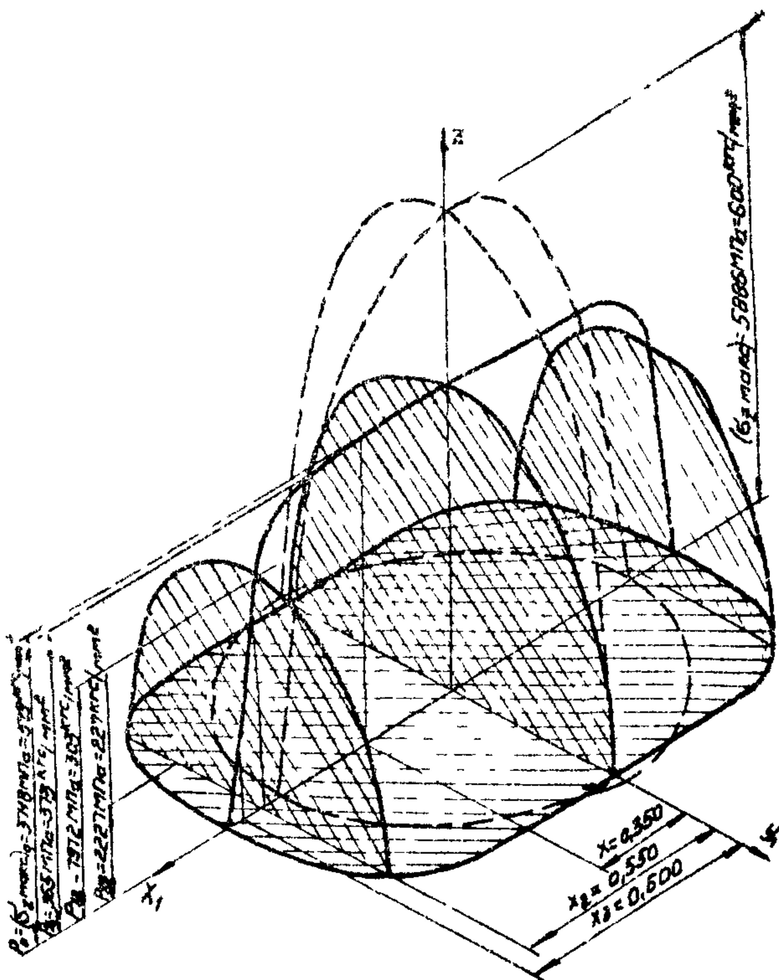
Черт. 2. Распределение напряжений на площадке контакта для четвертого режима нагружения
