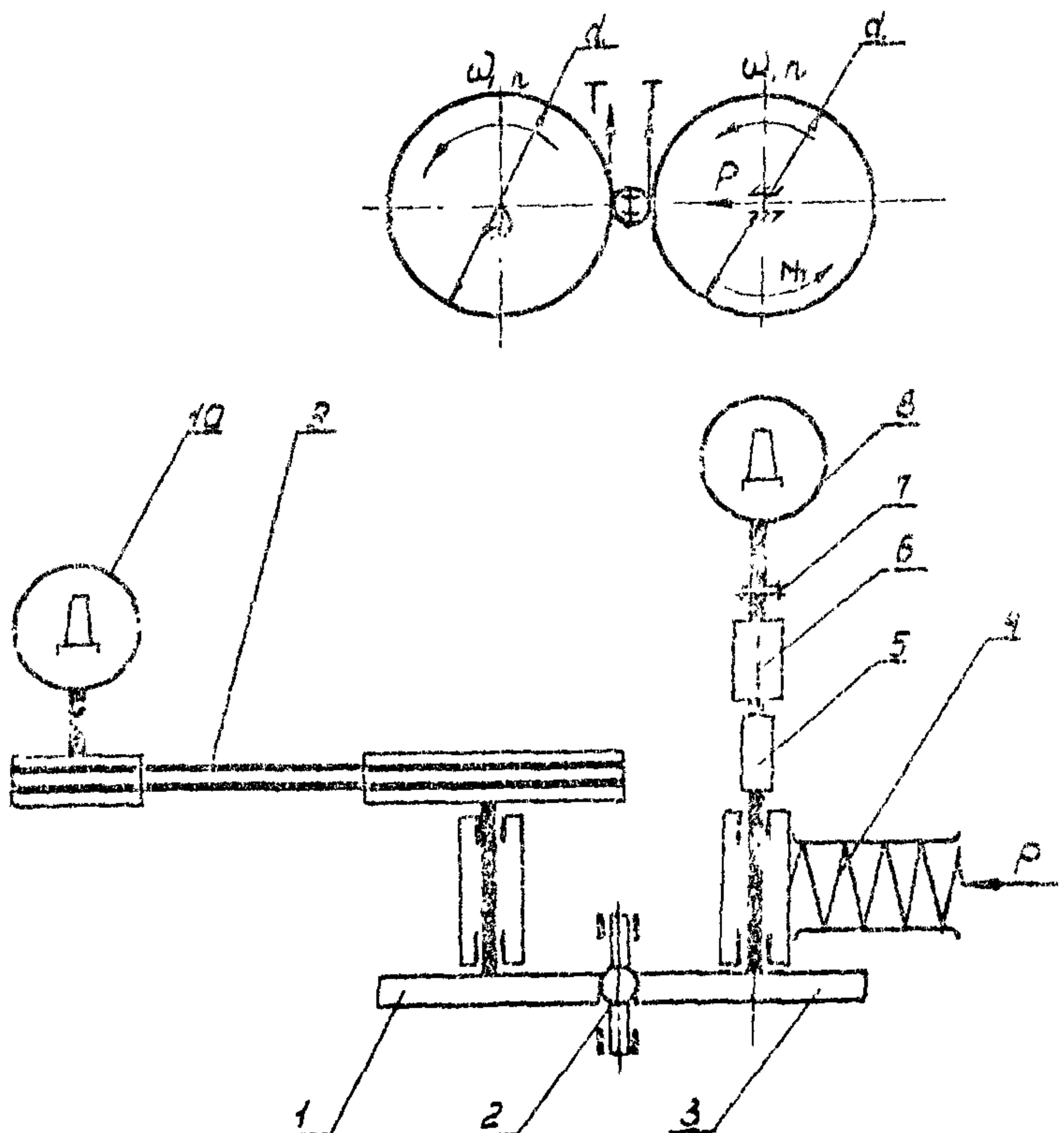
1-ведущее контролто; 2-образец; 3-ведомое контролто; 4-пружинный механизм; 5-тензометрическая балочка; 6-токосъемник; 7-упругая втулочно-палцевая муфта; 8-электродвигатель постоянного тока; 9-клиновременная передача; 10-электродвигатель переменного тока
