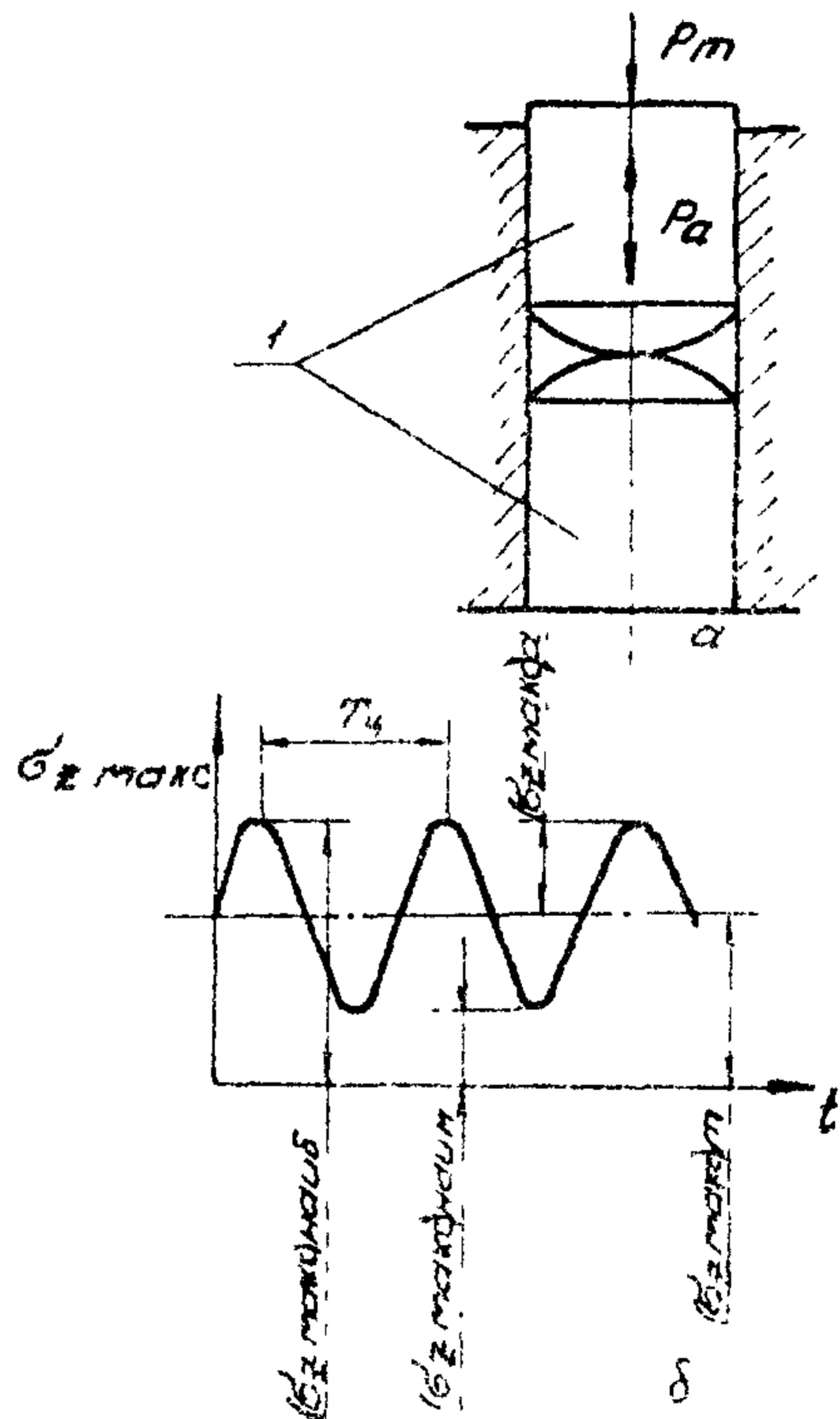
а - схема нагружения; б - цикл напряжений;
