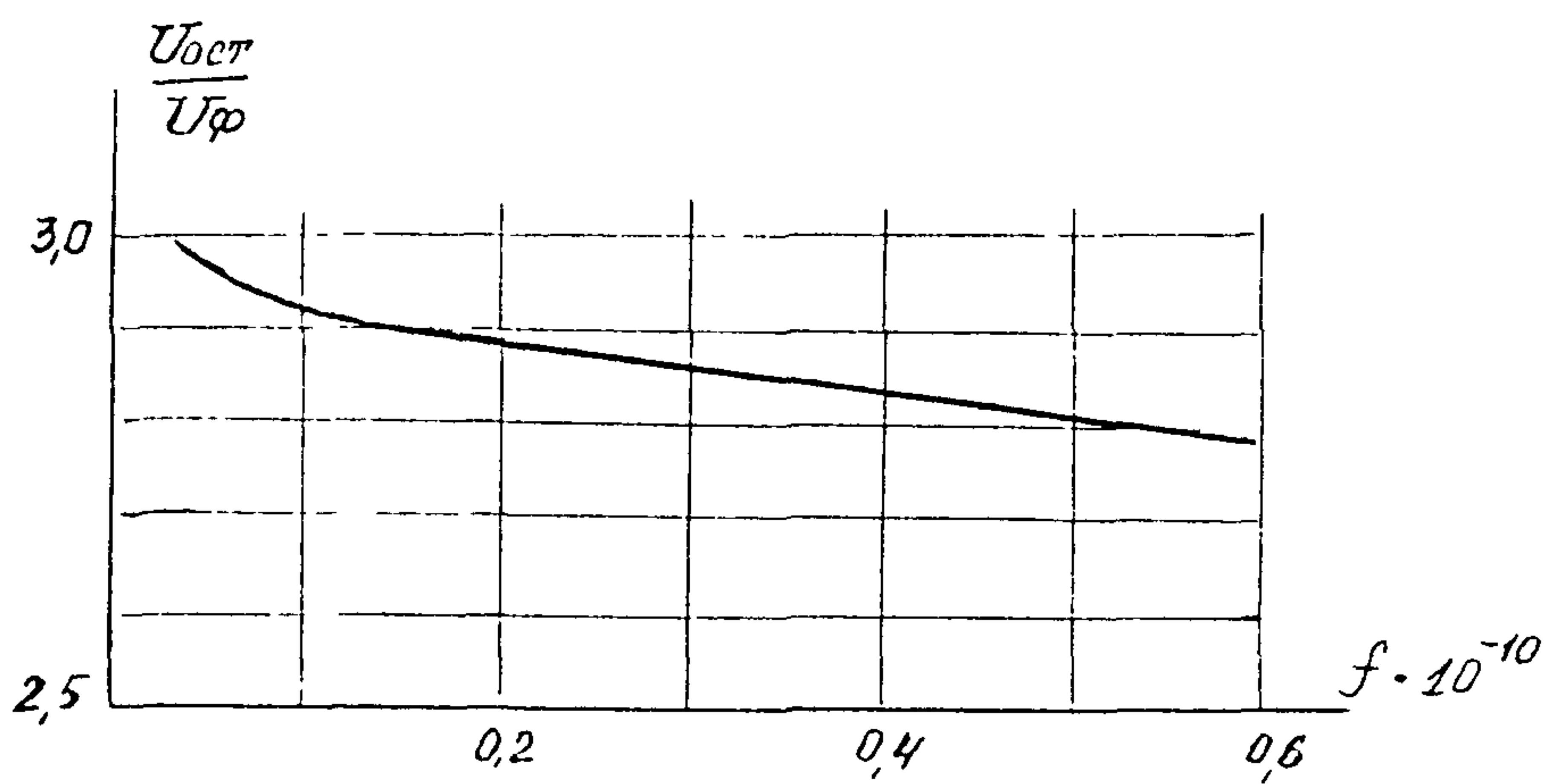
Рис. 3 Зависимость уровня ограничения дуговых замыканий на землю
