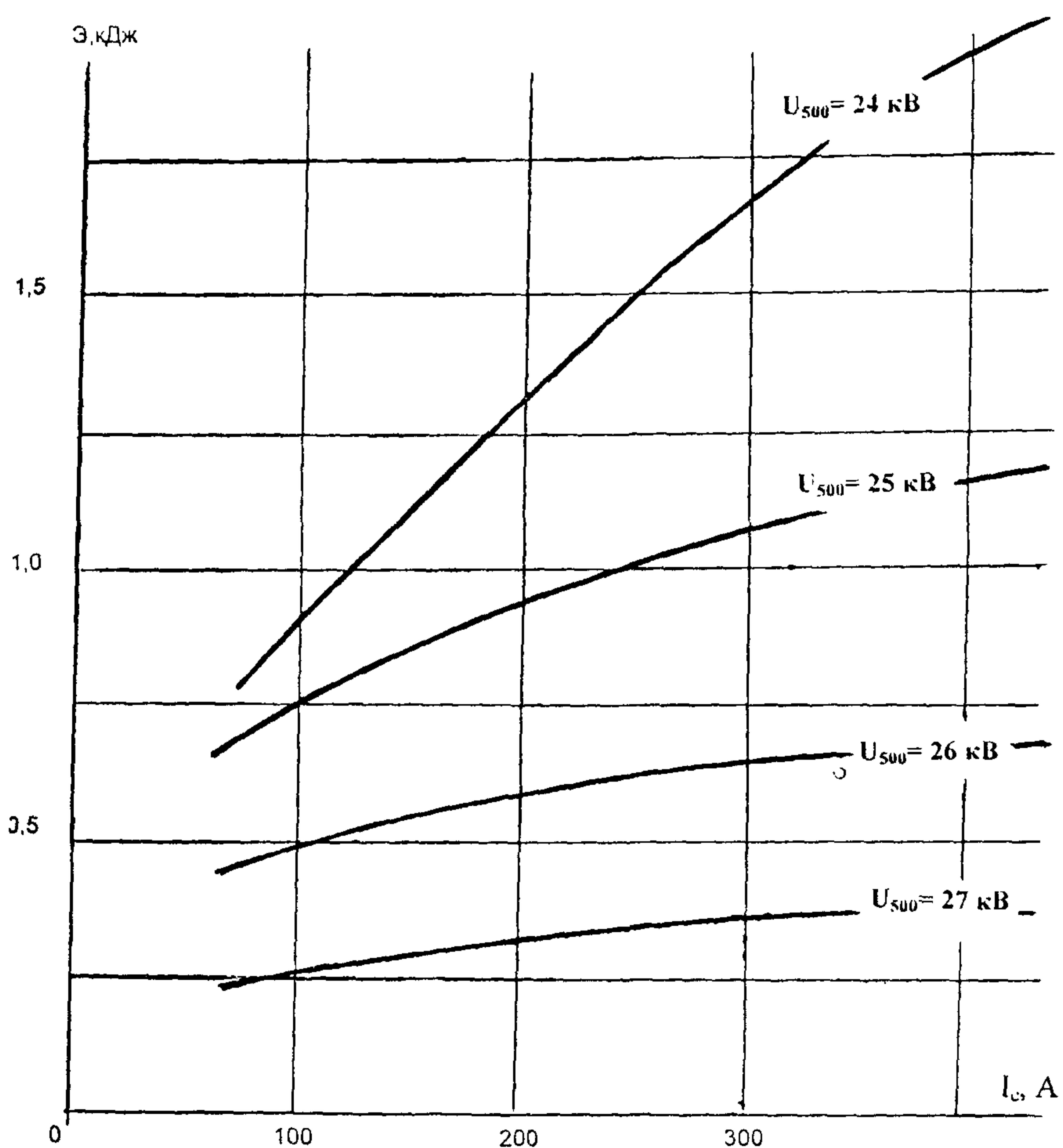
Рис.2 Обобщенные расчетные зависимости рассеиваемой ограничителем энергии за один цикл гашение-зажигание ( $E_1$ ) в кабельной сети 10 кВ от емкостного тока однофазного замыкания на землю( $I_c$ ) и параметра ограничителя  $U_{500}$ .
