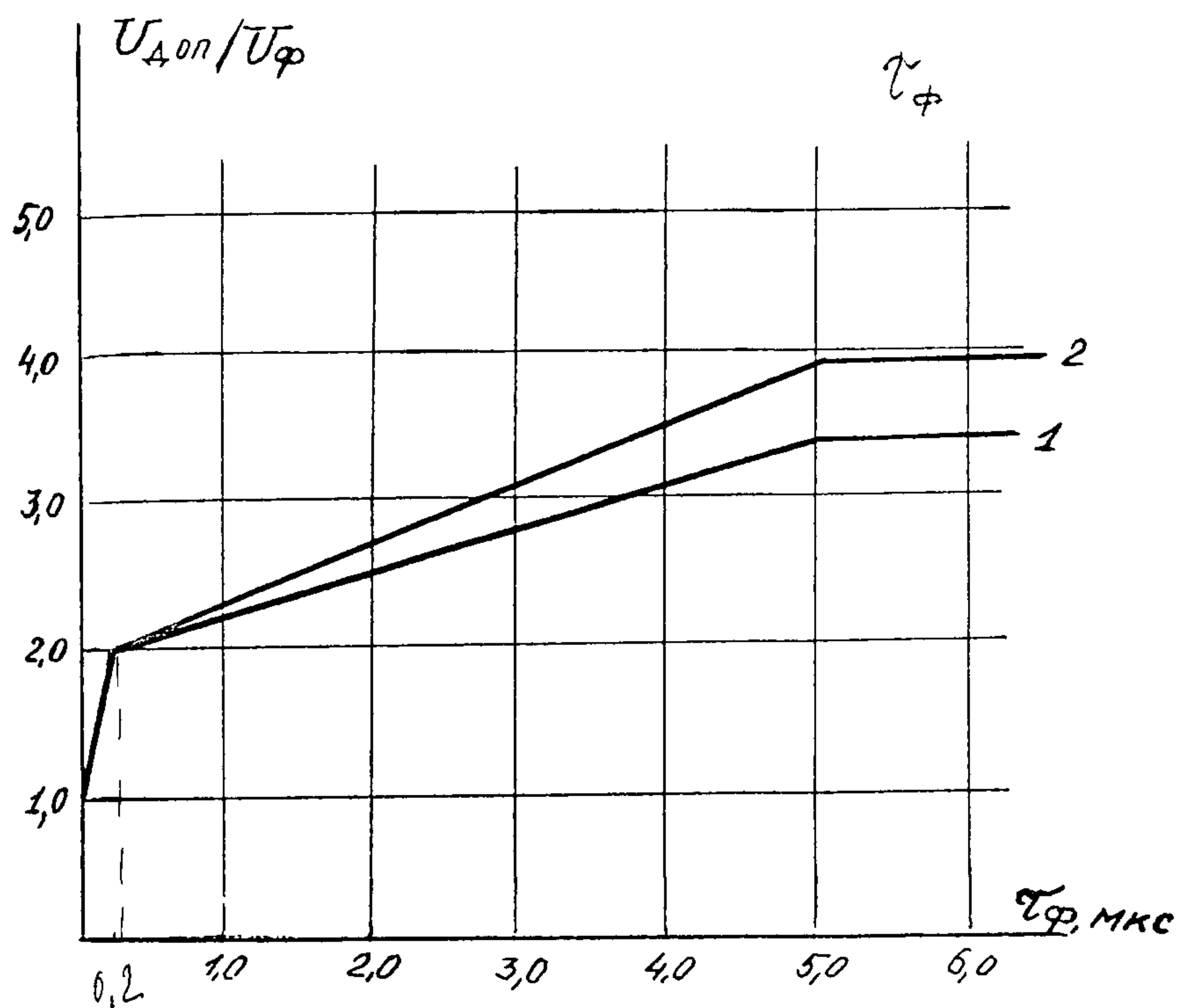
Рис. 4.1. Зависимость выдерживаемых изоляцией электродвигателей 6 кВ импульсных воздействий от длины фронта импульса.
