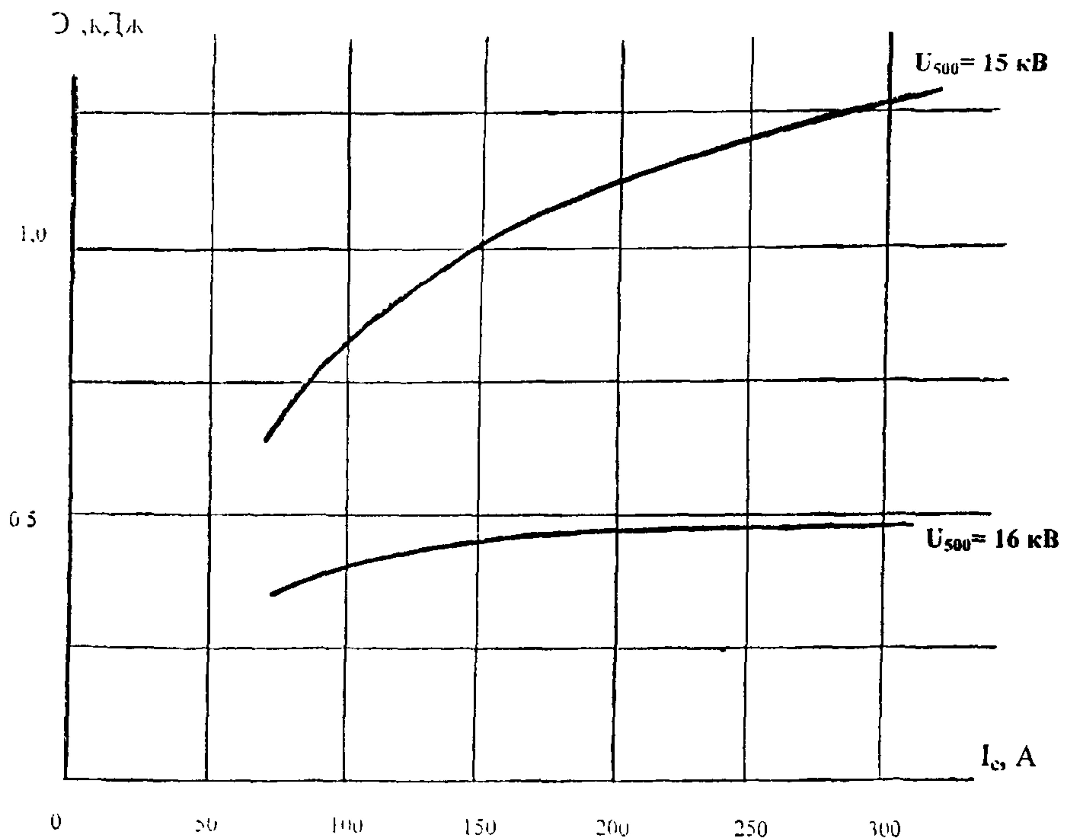
Рис. 1. Обобщенные расчетные зависимости рассеиваемой ограничителем энергии за один цикл гашение-зажигание ( $C_1$ ) в кабельной сети 6 кВ от емкостного тока однофазного замыкания на землю ( $I_C$ ) и параметра ограничителя  $U_{500}$ .
