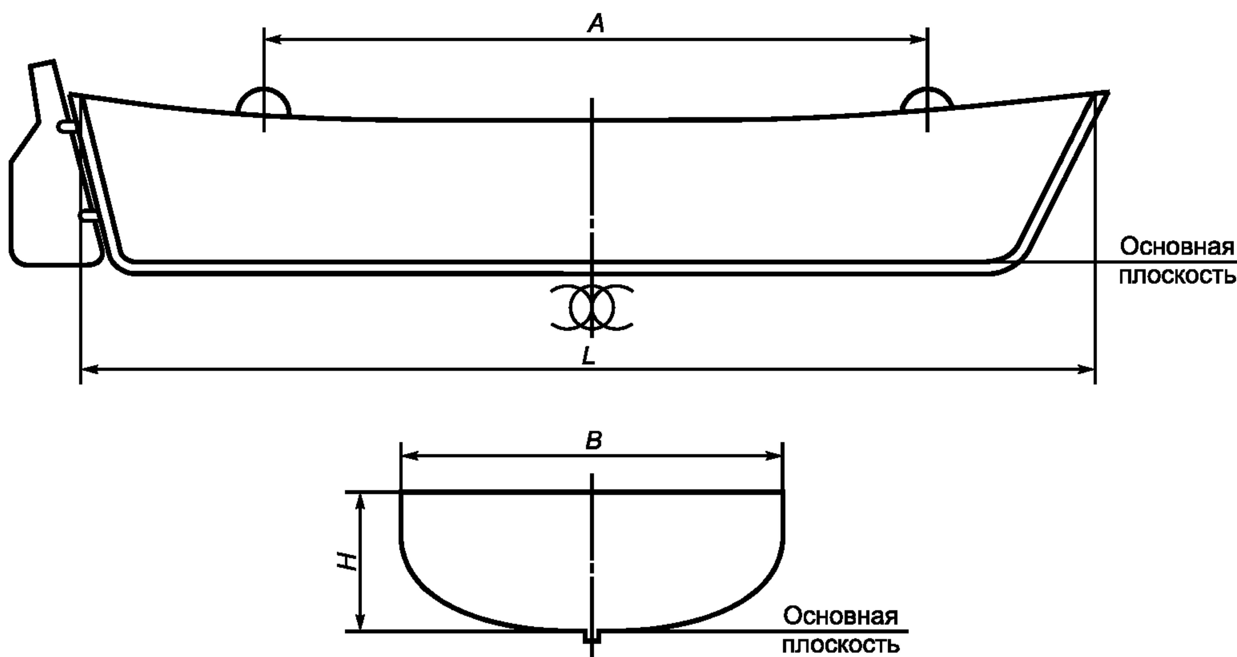
$L$  — расстояние между проекциями на основную плоскость точек пересечения наружной поверхности обшивки с форштевнем и ахтерштевнем (транцем);  $B$  — наибольшая ширина между наружными поверхностями обшивки;  $H$  — высота борта, измеренная вертикально от основной плоскости до нижней кромки планширя;  $A$  — расстояние между осевыми линиями подъемных гаков
