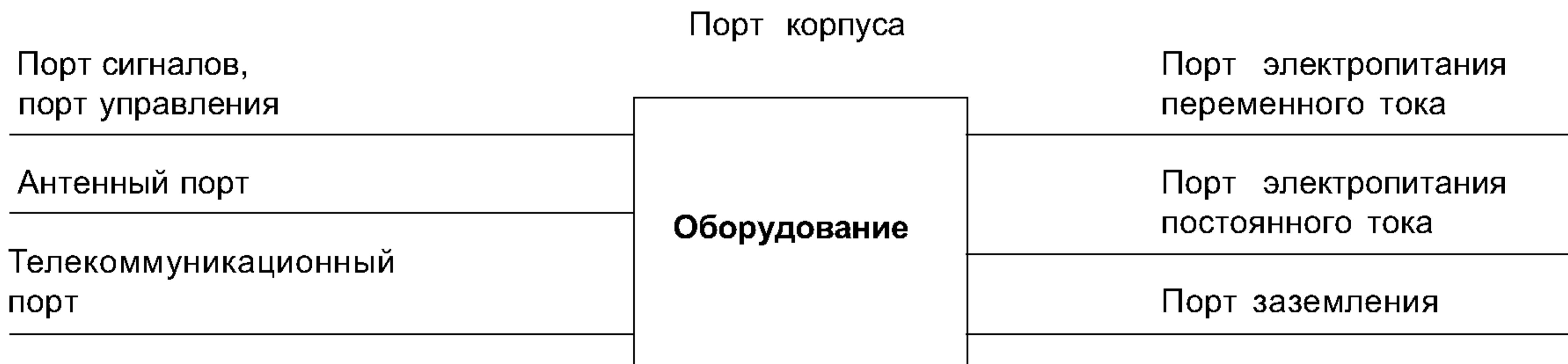
Рисунок 1 — Примеры портов оборудования
