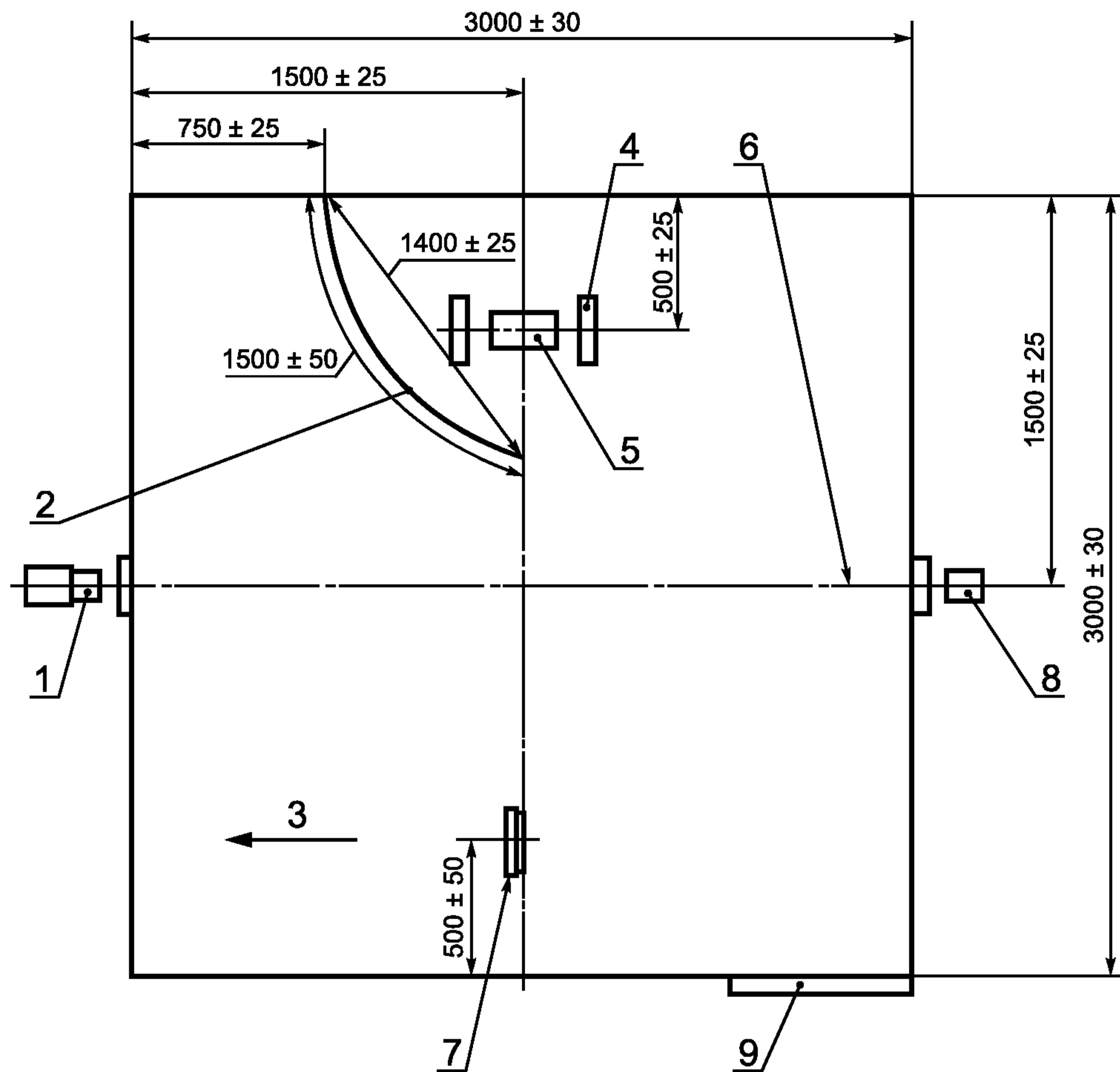
1 — источник света; 2 — воздушный экран высотой  $(1000 \pm 50)$  мм; 3 — направление потока воздуха от вентилятора; 4 — опора для кабеля; 5 — поддон со спиртом; 6 — высота оптической оси  $(2150 \pm 100)$  мм; 7 — вентилятор (расход воздуха  $7\text{--}15\text{ м}^3/\text{мин}$ ); 8 — фотоэлемент; 9 — дверь
