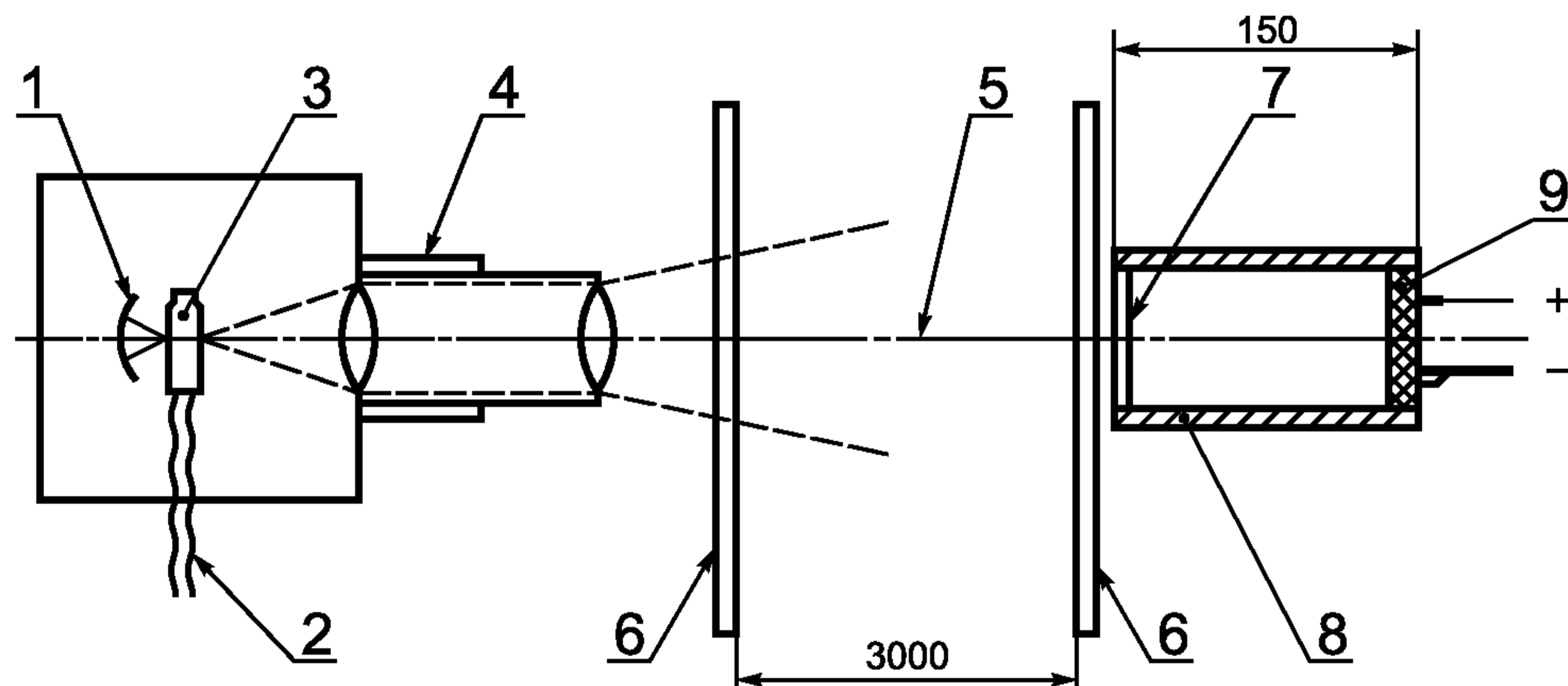
1 — рефлектор; 2 — подача стабилизированного напряжения  $(12,0 \pm 0,1)$  В (с предельными отклонениями при стабилизации  $\pm 0,01$  В); 3 — галогеновая лампа с кварцевой колбой; 4 — система линз; 5 — световой поток; 6 — окна камеры; 7 — пылезащитное стекло; 8 — трубка с внутренней матовой поверхностью; 9 — фотоэлемент
