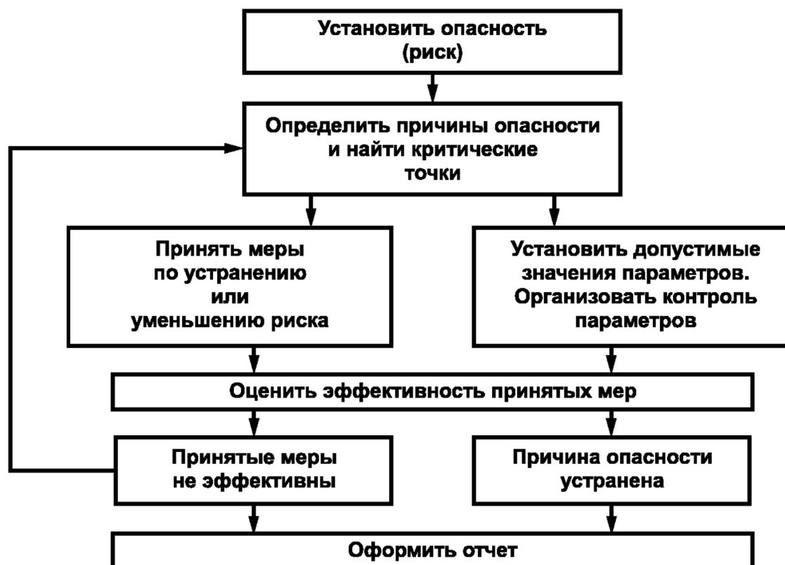
Рисунок 2 — Схема работы по анализу рисков
