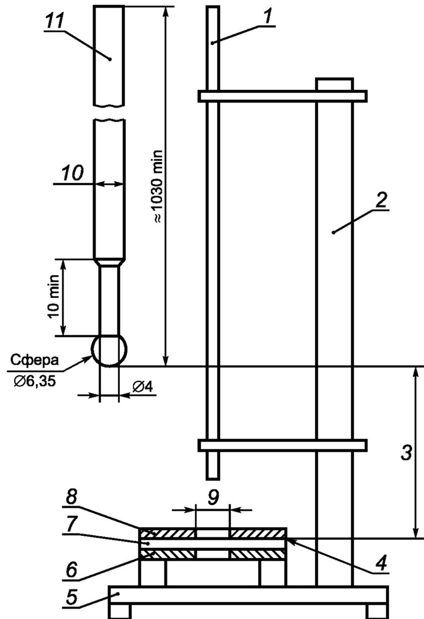
1 — направляющая труба с допусковым отклонением от вертикали  $\pm 2^\circ$ ; 2 — опорная стойка; 3 — высота падения; 4 — добавленная экстра крафт-бумага; 5 — основание; 6 — стальная нижняя пластина размером  $6,35 \times 150 \times 150$  мм; 7 — образец  $6,35 \times 150 \times 150$  мм; 8 — стальная верхняя пластина размером  $20 \times 150 \times 150$  мм; 9 — отверстие диаметром 50 мм; 10 — стальной стержень диаметром 6,35; 11 — проникающее устройство массой 0,25 кг
