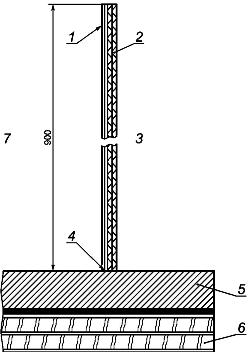
1 — крафт-бумага, используемая при необходимости; 2 — гофрированный картон, один или два слоя при необходимости; 3 — внешняя сторона; 4 — края панели-мишени, плотно прижатые к основанию, препятствующие шарикам вырываться за края стены; 5 — кокосовое покрытие основания (рисунки ВВ.1 и ВВ.2); 6 — основание из фанеры; 7 — сторона испытаний прибора
