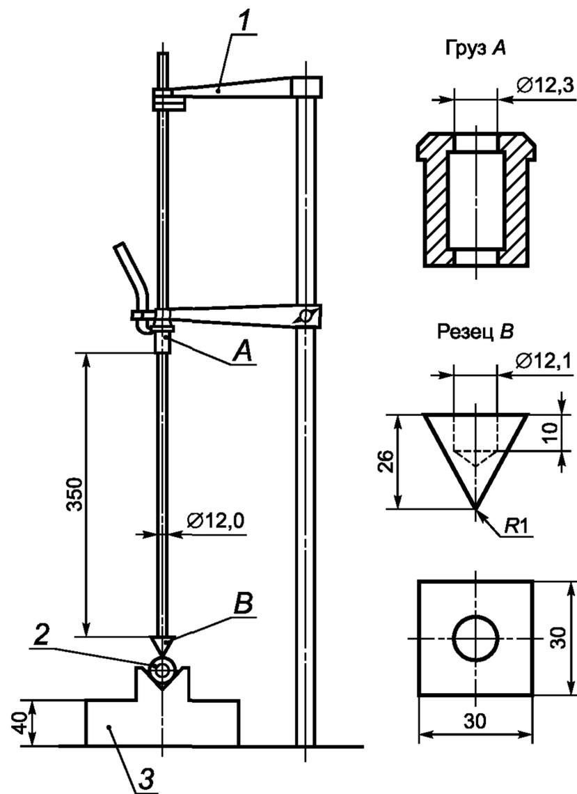
1 — фиксирующий кронштейн; 2 — образец; 3 — основание массой 10 кг
