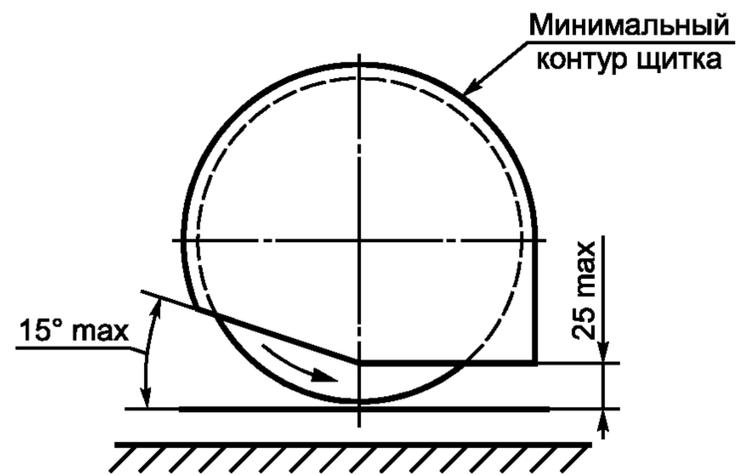
Рисунок 108 — Ограждение режущих устройств сбоку
