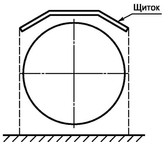
Рисунок 109 — Ограждение задних разгрузочных проемов
