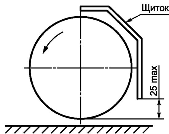
Рисунок 110 — Ограждение передних разгрузочных проемов
