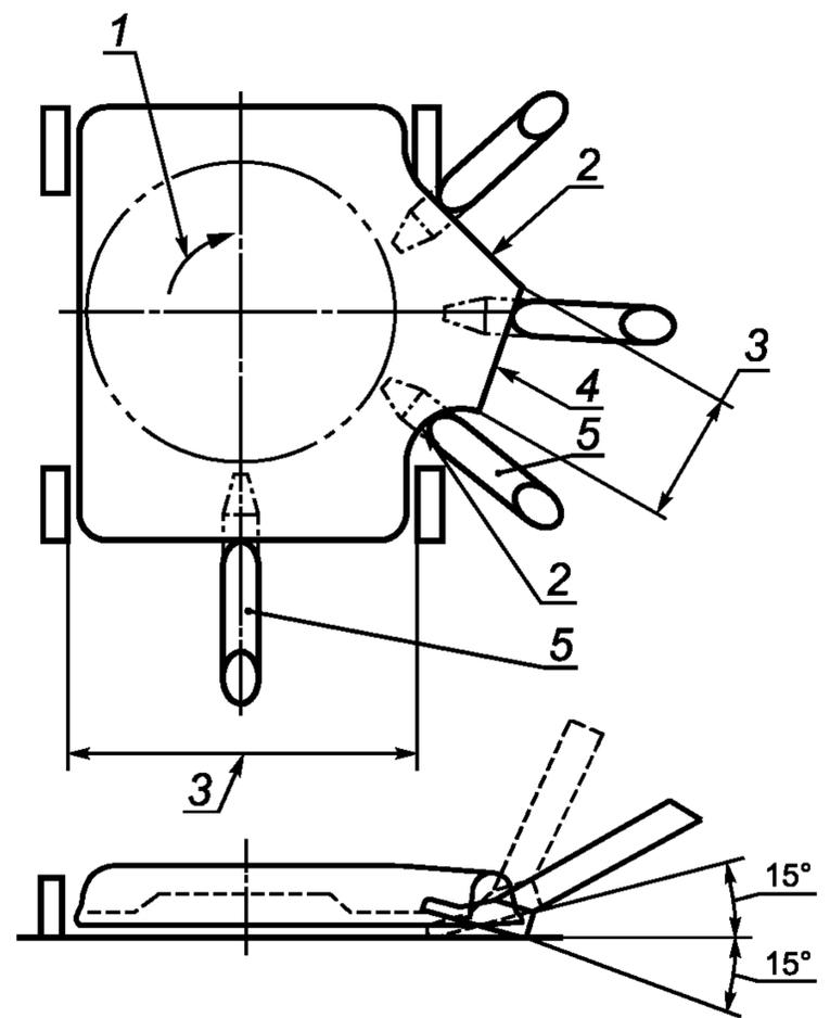
1 — направление вращения; 2 — сторона разгрузочного желоба, которую проверяют имитатором, если она менее чем на 3 мм ниже плоскости траектории движения лезвия режущего инструмента; 3 — область, проверяемая имитатором; 4 — разгрузочный проем; 5 — имитатор стопы (или основание имитатора из любого указанного начального положения)
