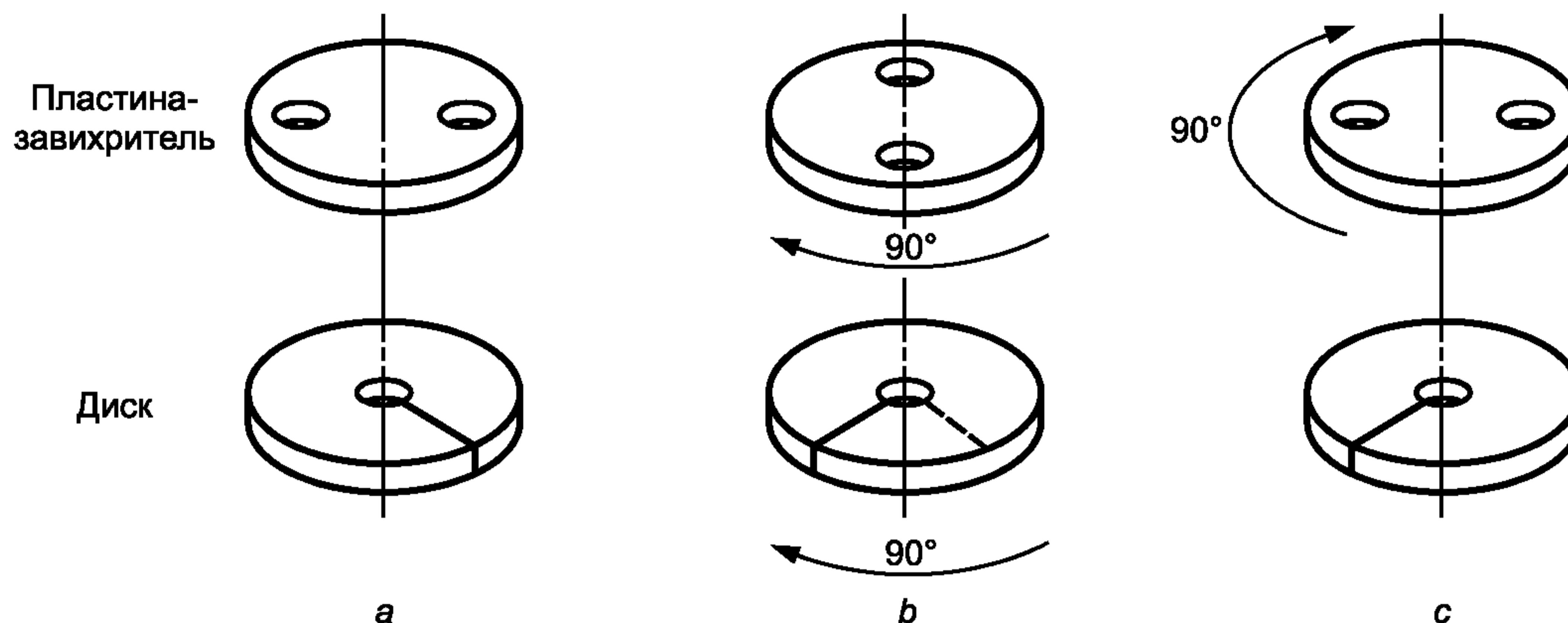
Рисунок 3 — Конфигурация испытуемых насадок с конусным распылением
