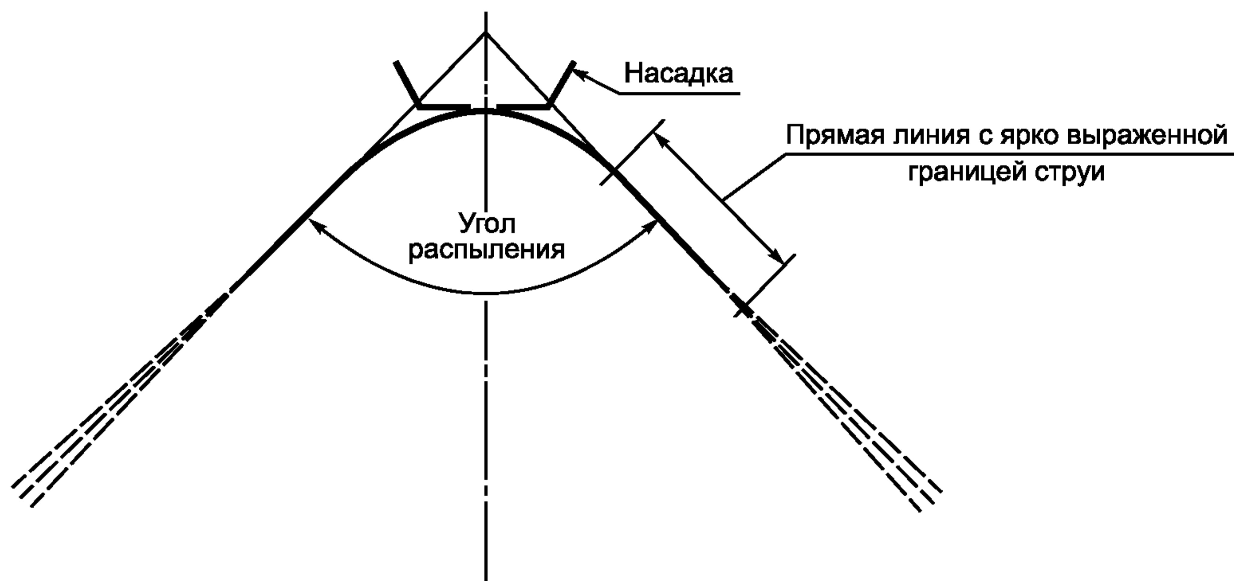
Рисунок 4 — Схема измерения угла распыления
