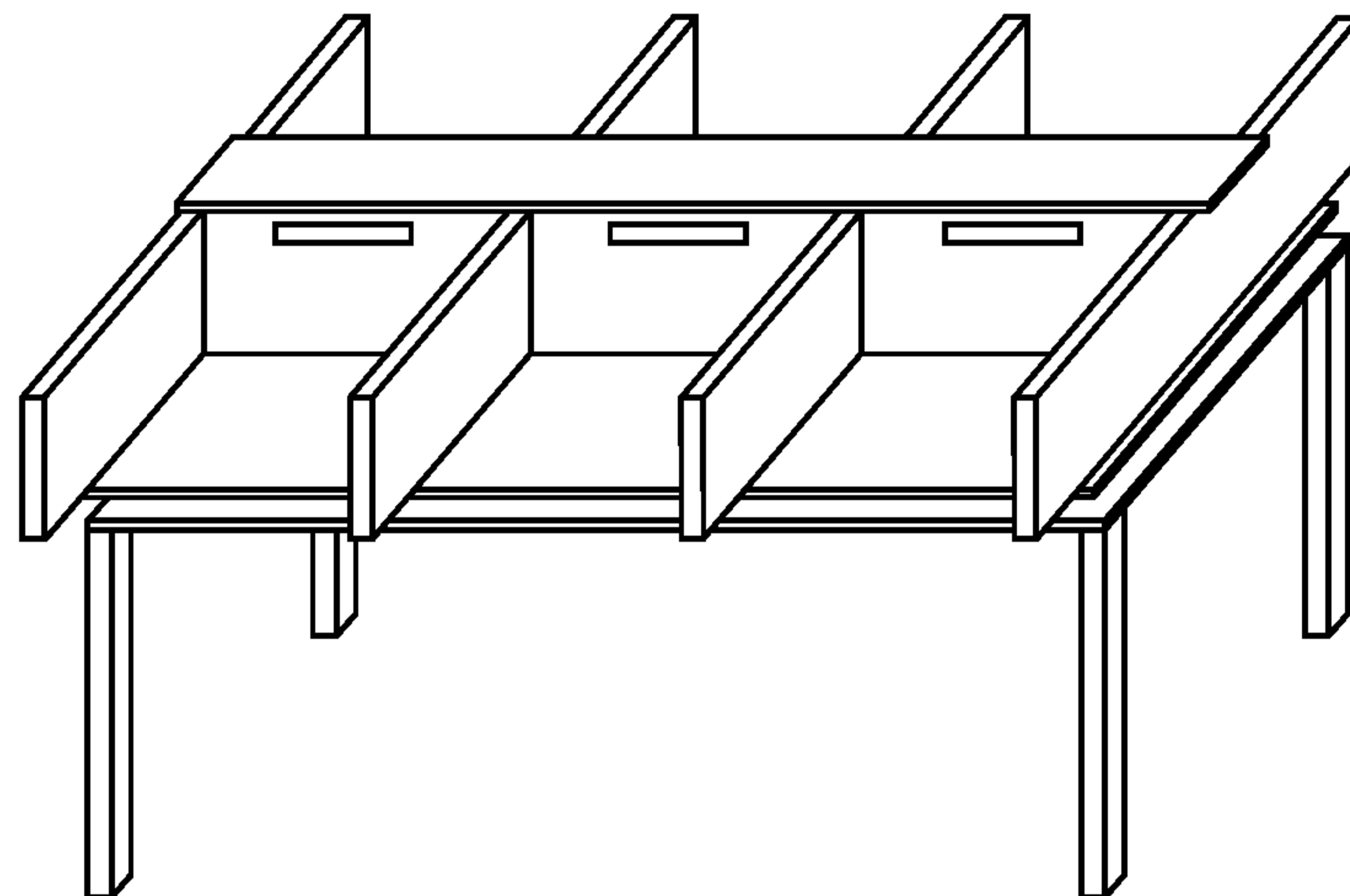
Рисунок А.1 — Оборудование стола съемными разделителями
