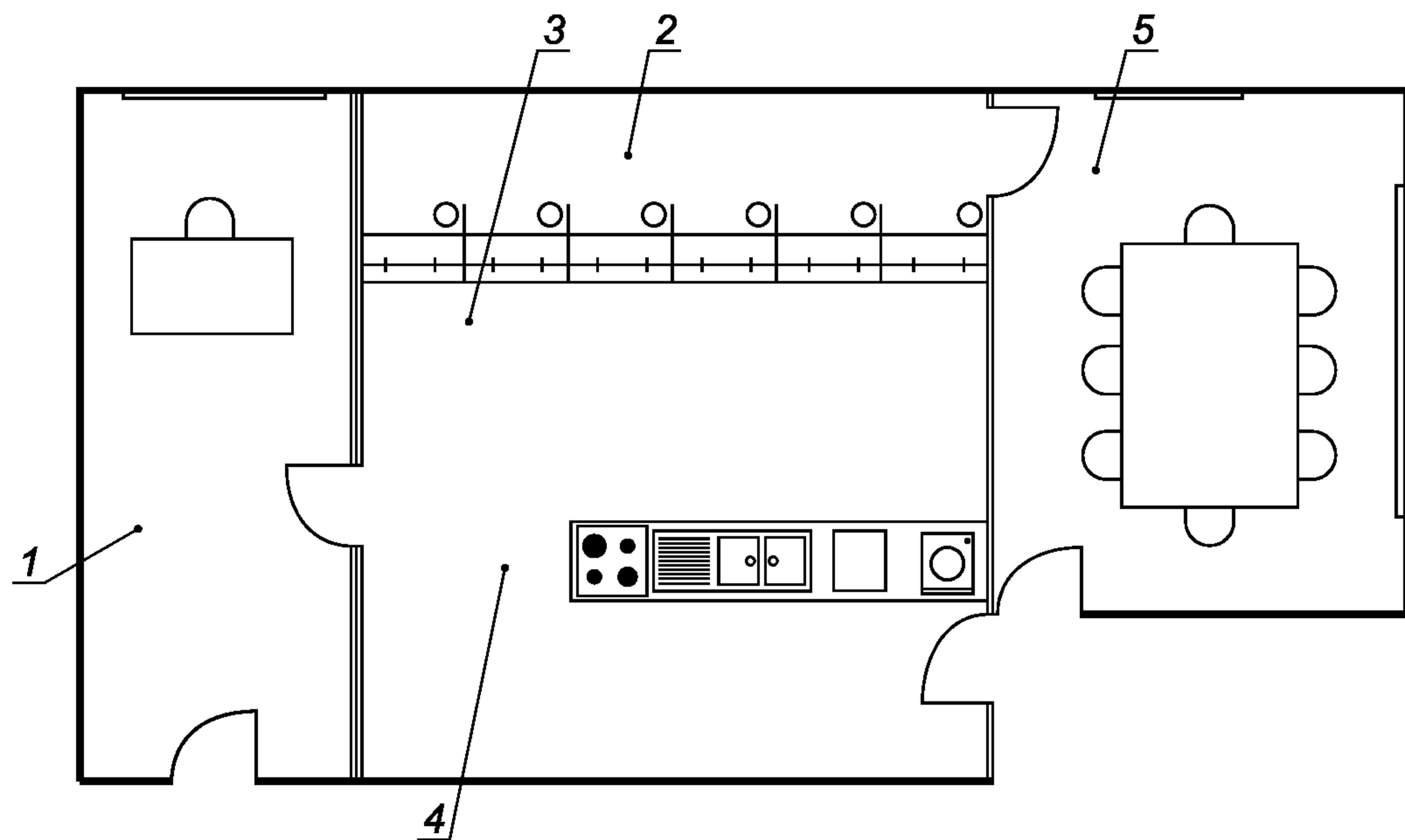
1 — офис; 2 — испытательные кабины; 3 — место раздачи образцов; 4 — место приготовления образцов;
