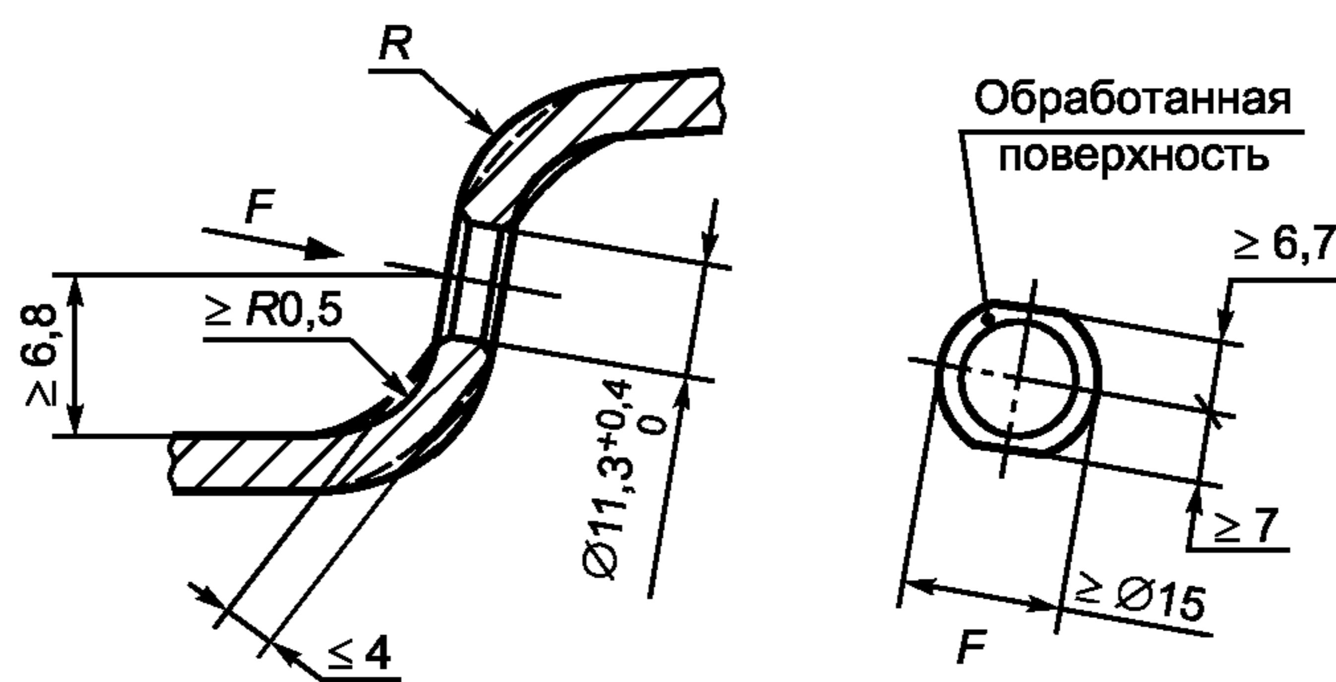
Рисунок 4 — Исполнение поверхности в зоне вентильного отверстия
