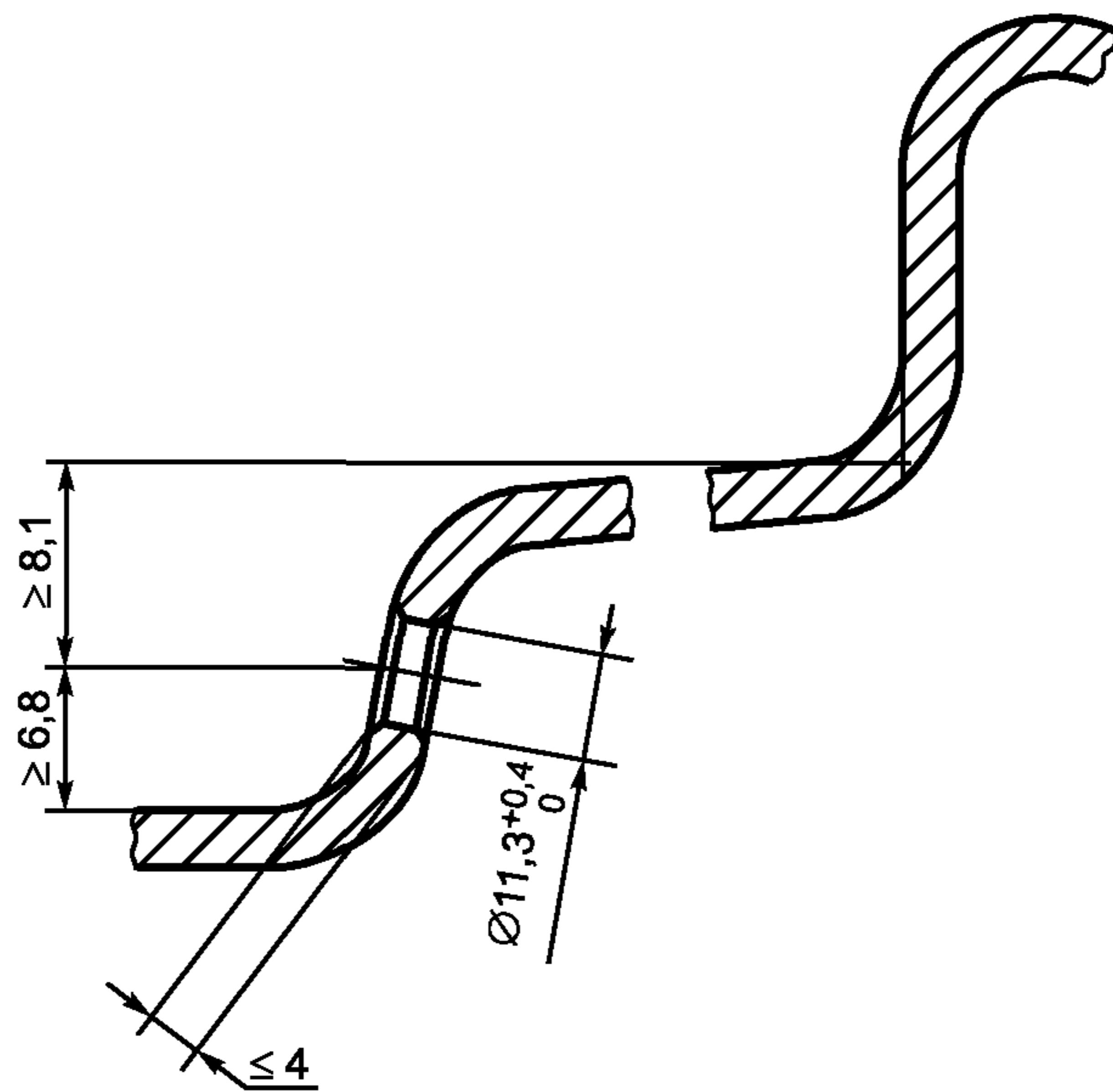
Рисунок 3 — Размеры вентильного отверстия для бескамерных шин
