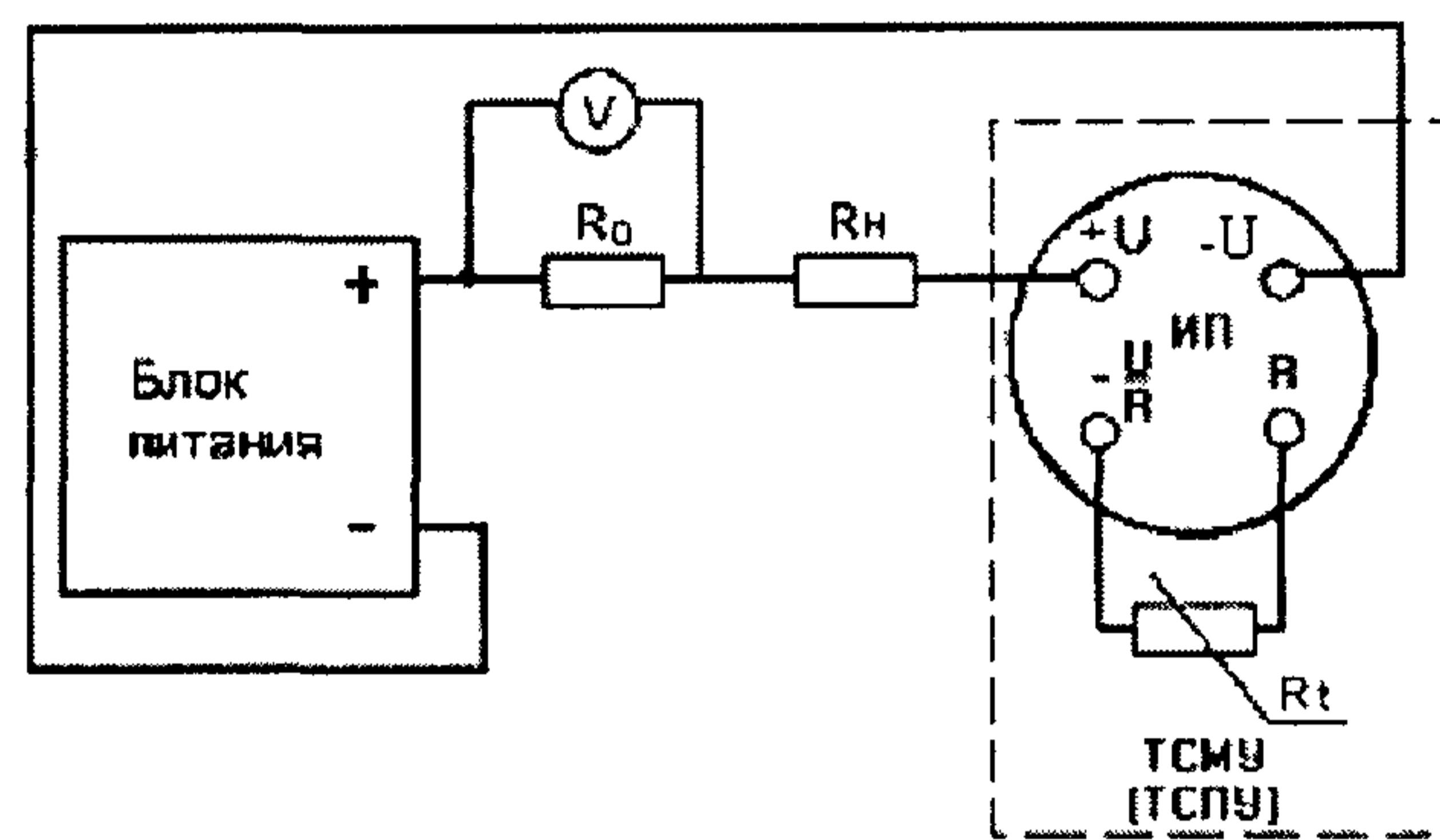
БП – источник питания постоянного тока 24 В; В – вольтметр;  $R_0$  – образцовое сопротивление 100 Ом;  $R_H$  – сопротивление нагрузки 250 Ом; ИП – измерительный преобразователь поверяемого термопреобразователя;  $R_t$  – платиновое сопротивление поверяемого термопреобразователя.
