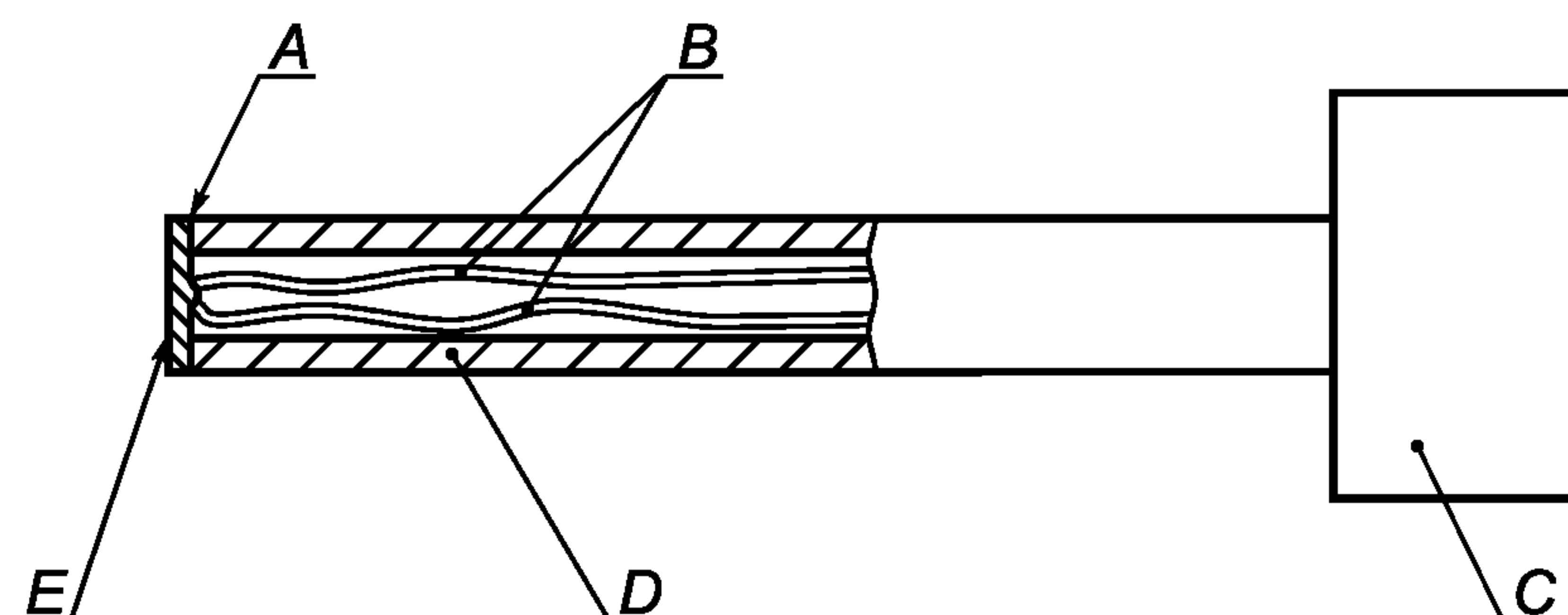
**А** — связывающее вещество; **B** — термопара из проволоки диаметром 0,3 мм типа К (хромоникелевый сплав) по ГОСТ Р 8.585; **C** — ручное устройство, разрешающее контакт с силой  $(4 \pm 1)$  Н; **D** — поликарбонатная труба внутренним диаметром 3 мм, наружным диаметром 5 мм; **E** — покрытый оловом медный диск диаметром 5 мм, толщиной 0,5 мм.
