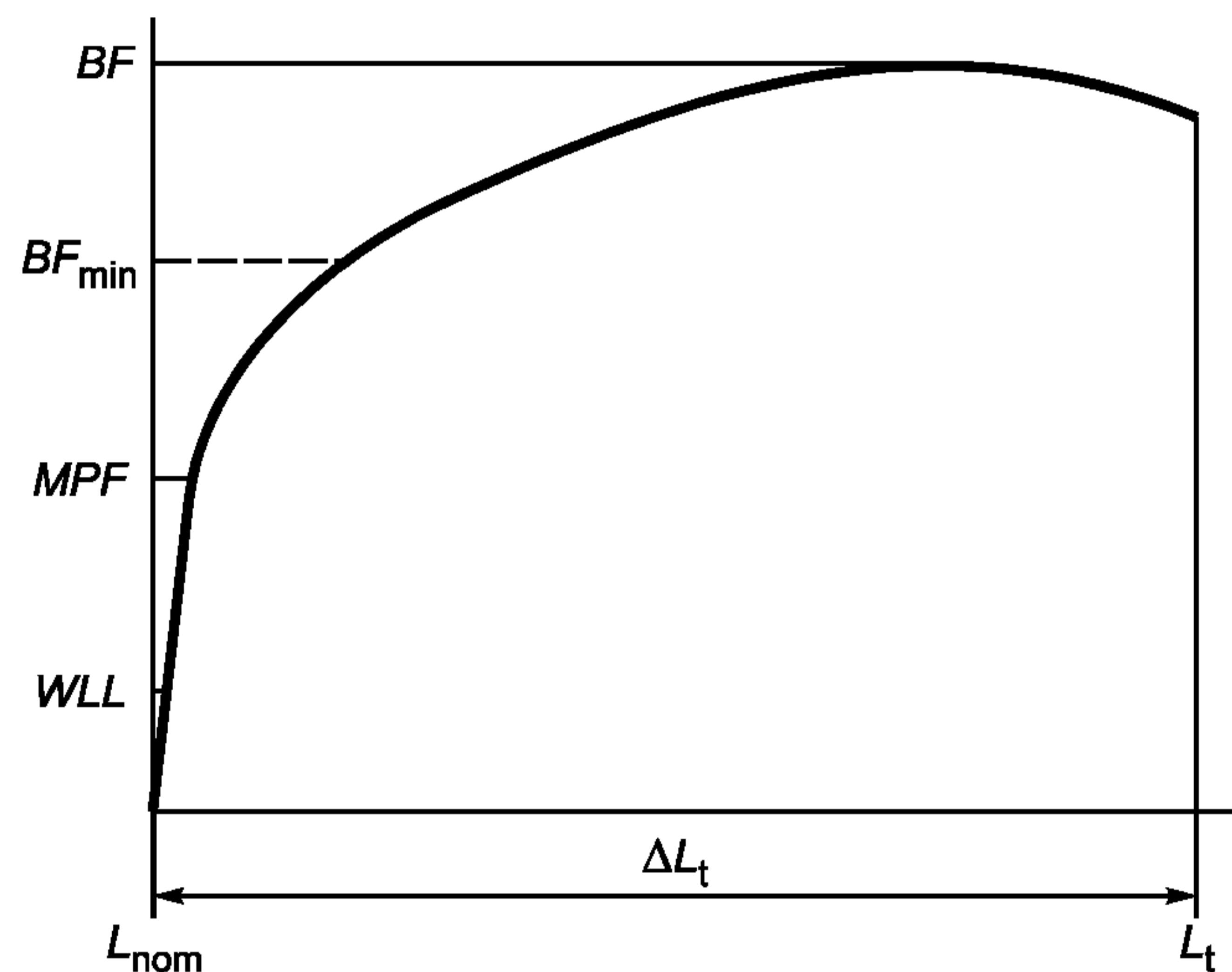
$BF$  — разрывающее усилие;  $BF_{\min}$  — установленное минимальное разрывающее усилие;  $MPF$  — испытательное усилие;
