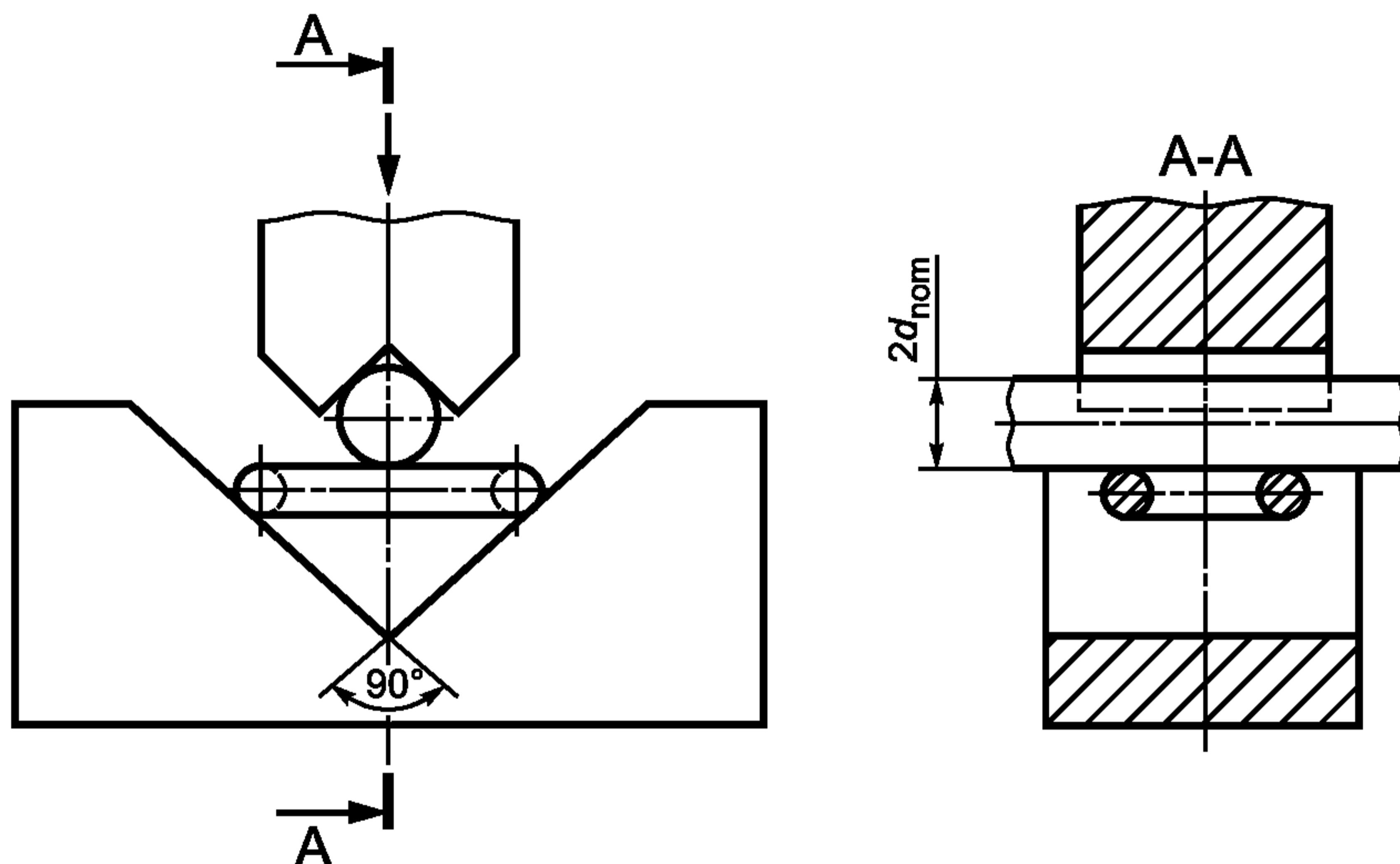
Рисунок В. 1 — Установка для испытания на изгиб
