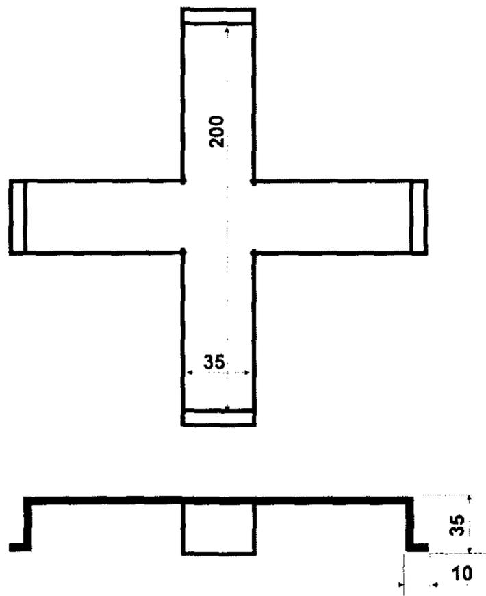
**Рис. 2.** Металлическая подставка для тестовой упаковки (размеры указаны в мм).
