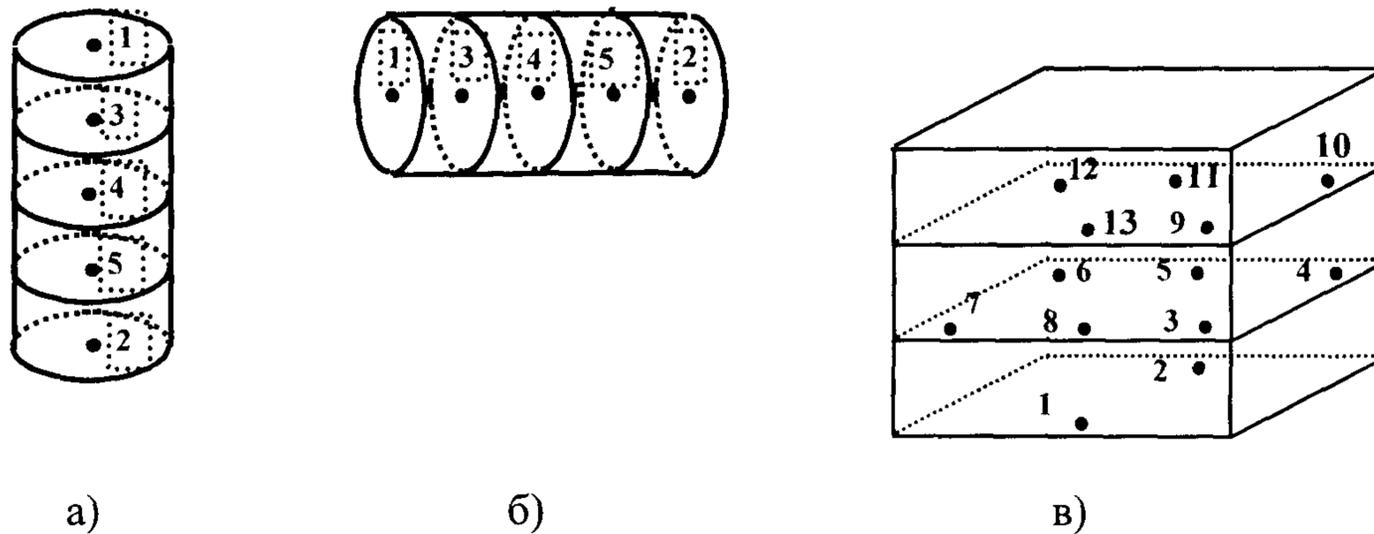
**Рис. 1.** Расположение контрольных точек в паровых стерилизаторах.
