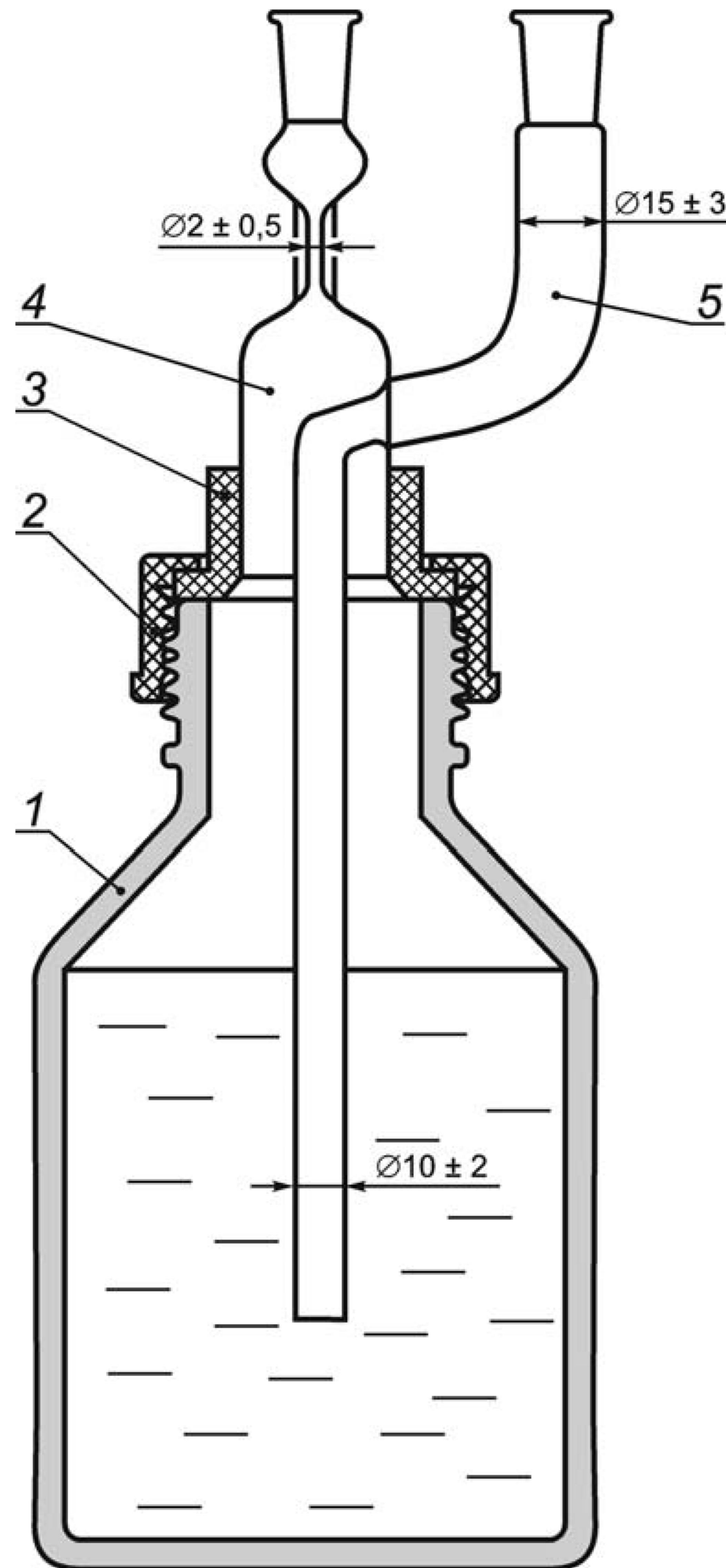
1 — стеклянная емкость с анализируемой пробой воды; 2 — завинчивающаяся крышка с отверстием;
