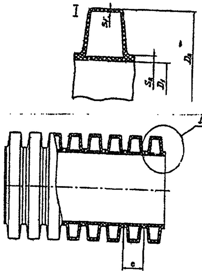
Рис.1. Схема полиэтиленовой гофрированной двухслойной трубы
