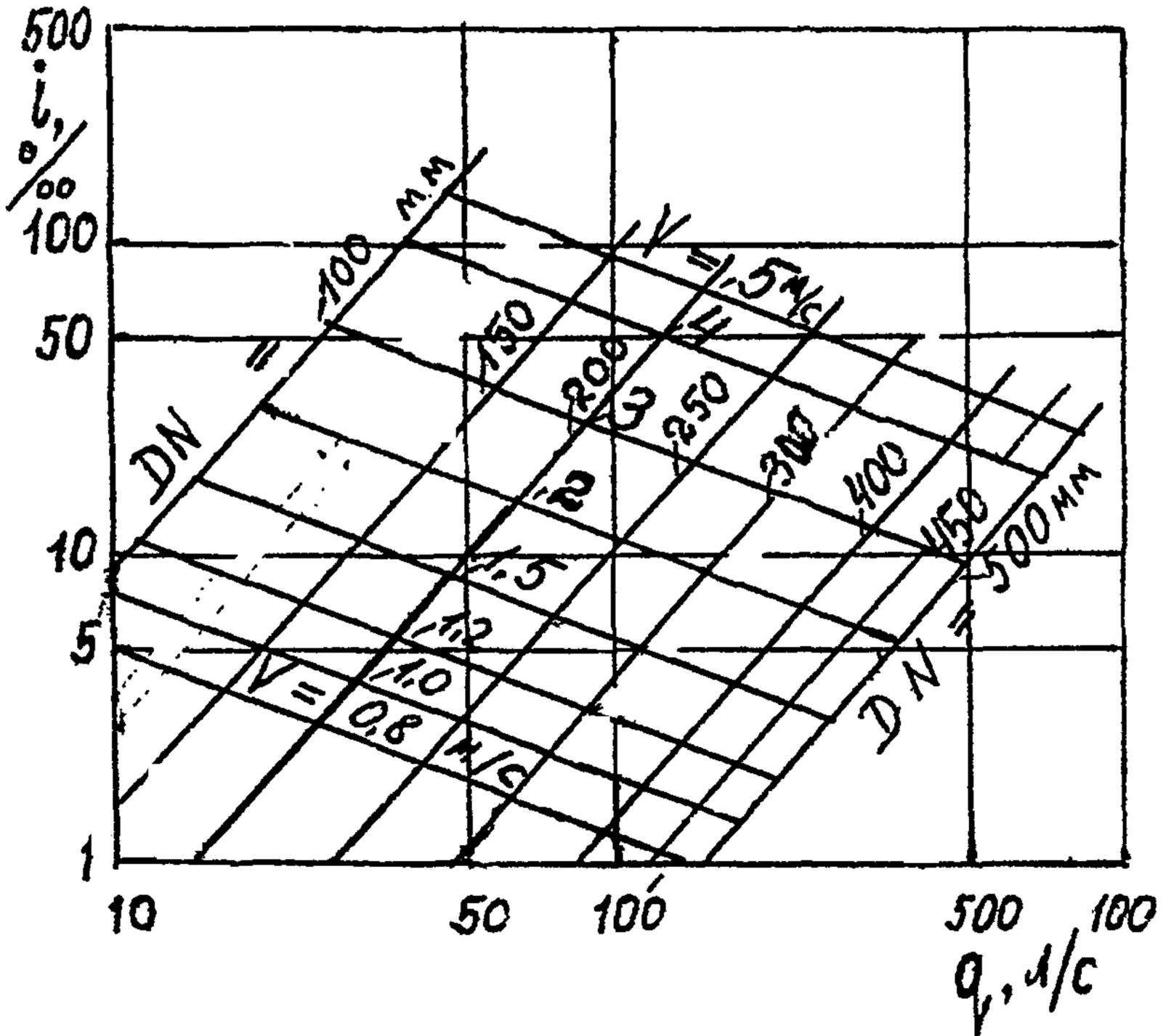
Обозначения: DN- диаметр труб, q - расход, V - средняя скорость, i - гидравлический уклон
