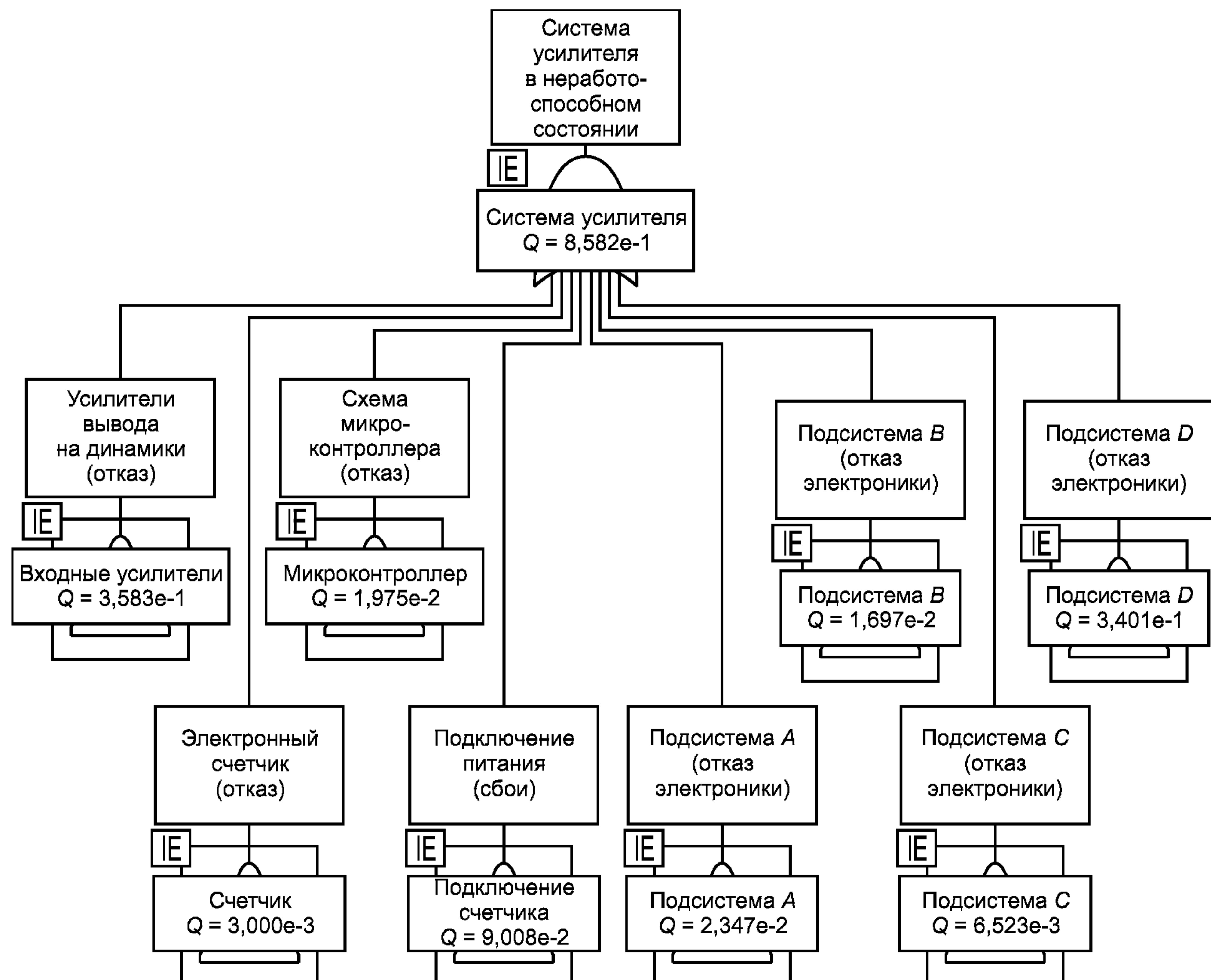
Рисунок А.2 — Дерево неисправностей для аудиоусилителя
