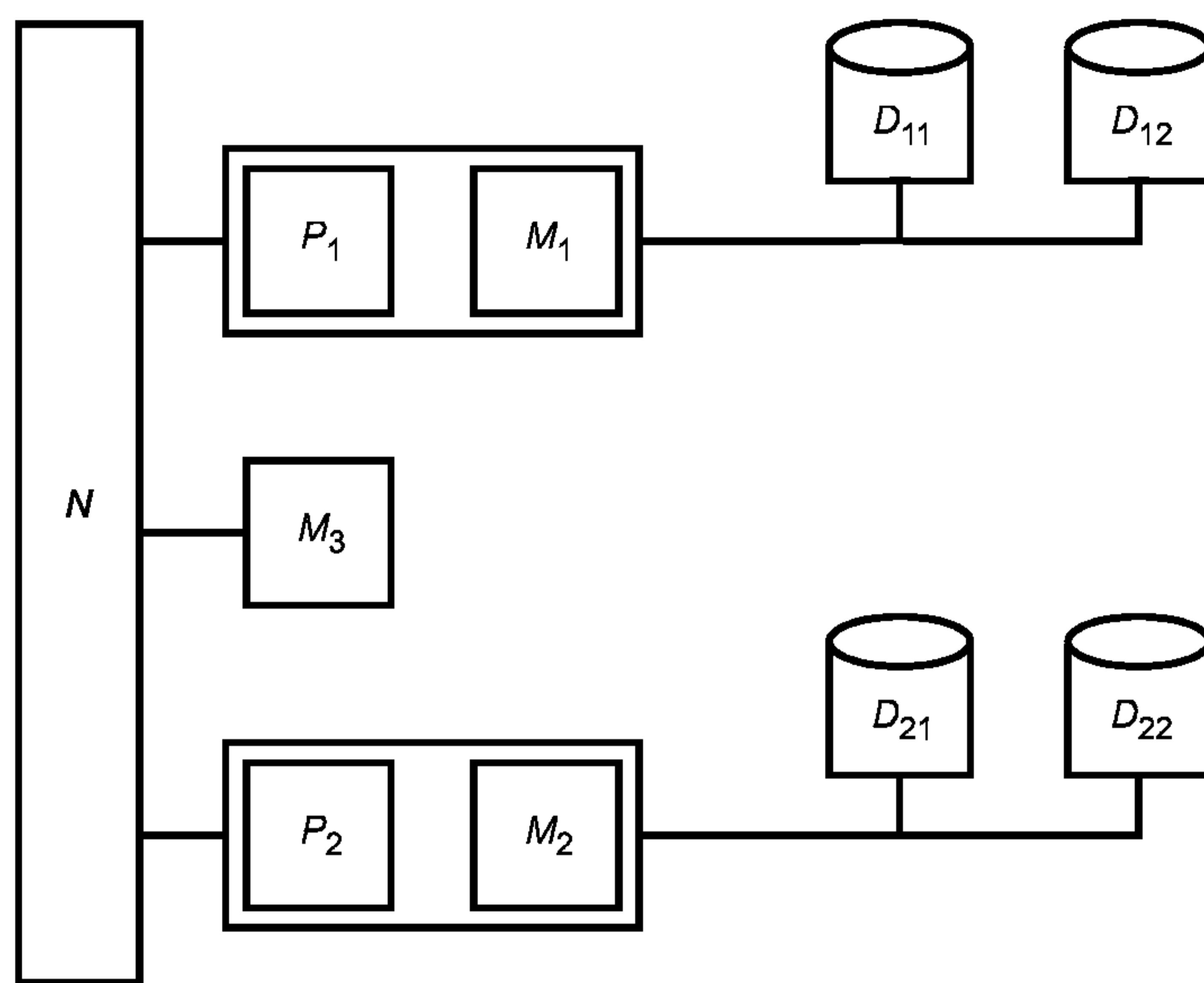
Рисунок А.8 — Структурная схема мультипроцессора
