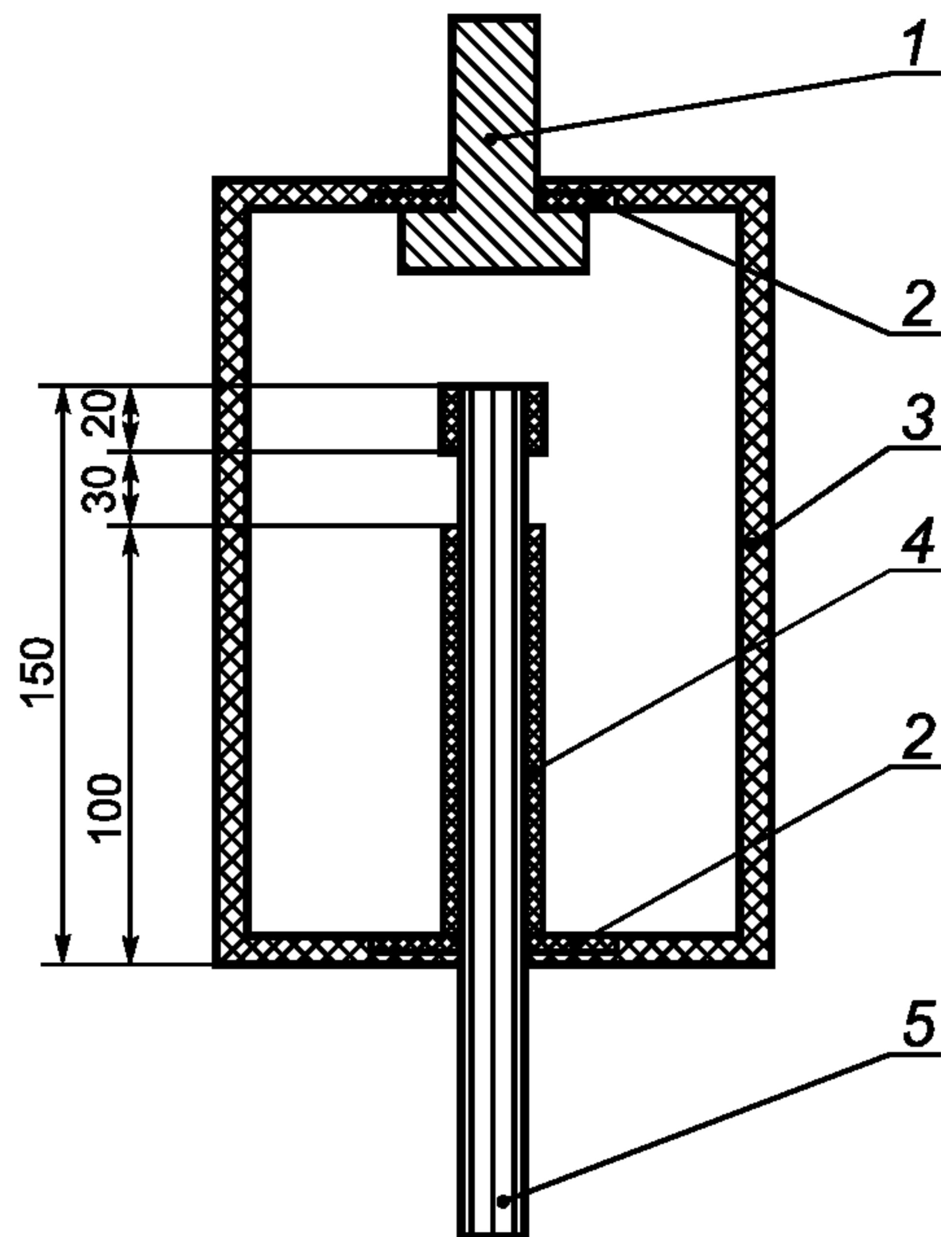
1 — стержень для захвата в зажиме разрывной машины; 2 — упорный подшипник; 3 — корпус устройства;
