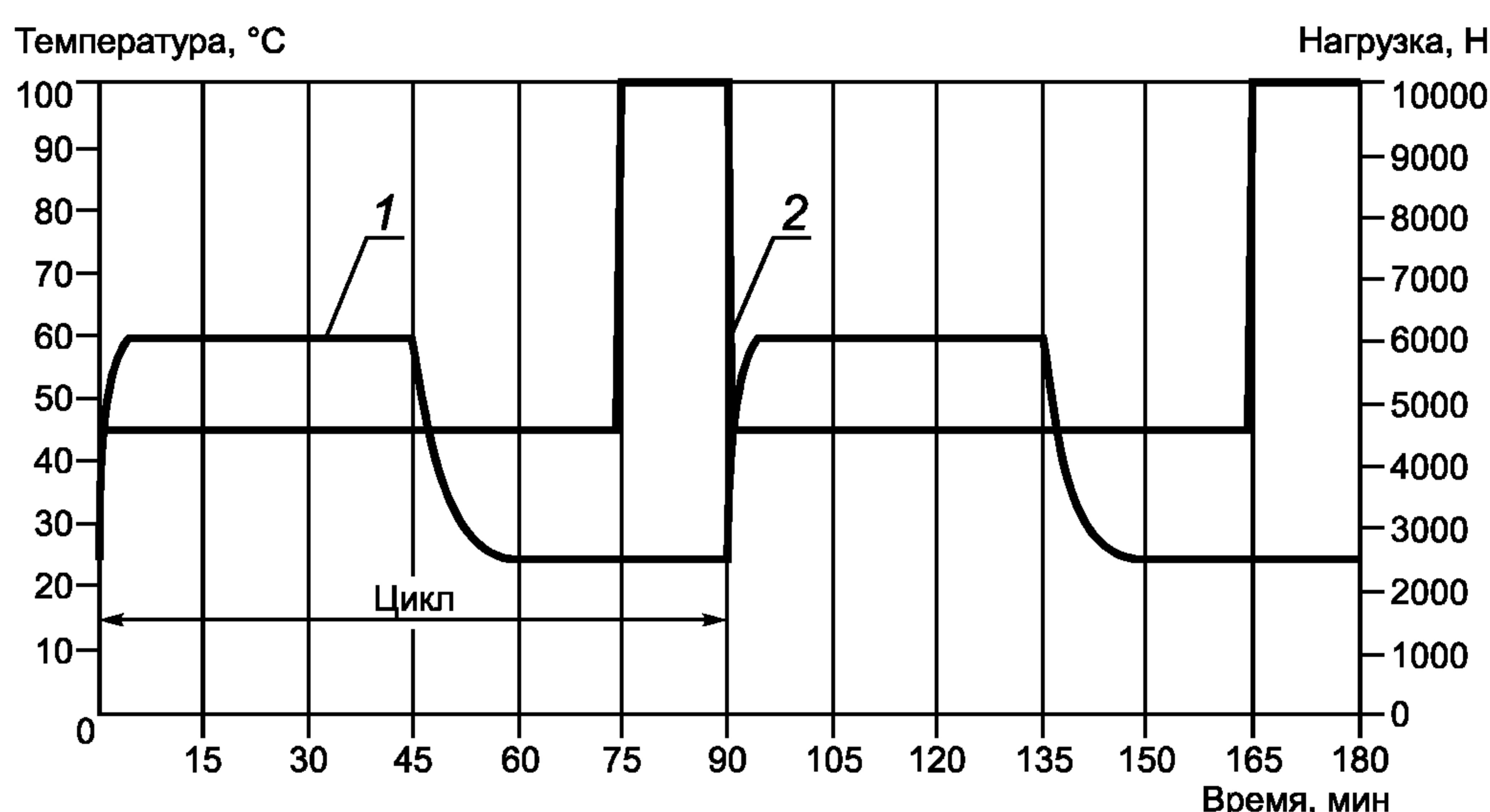
1 — температура; 2 — механическая нагрузка
