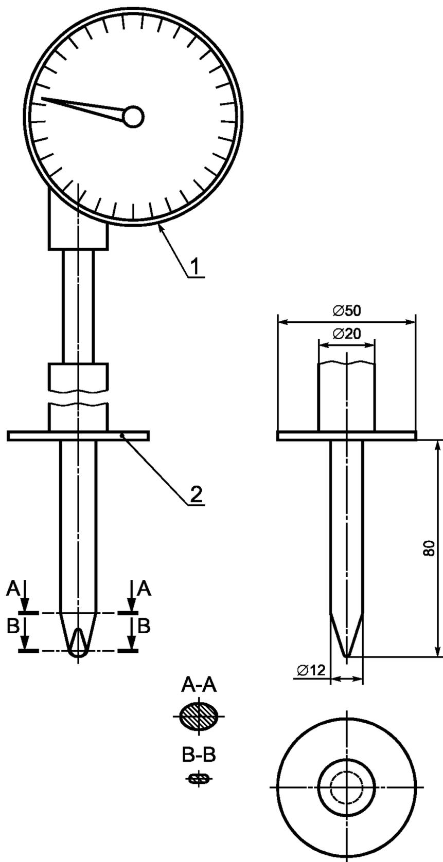
1 — инструмент для измерения силы; 2 — ограничитель
