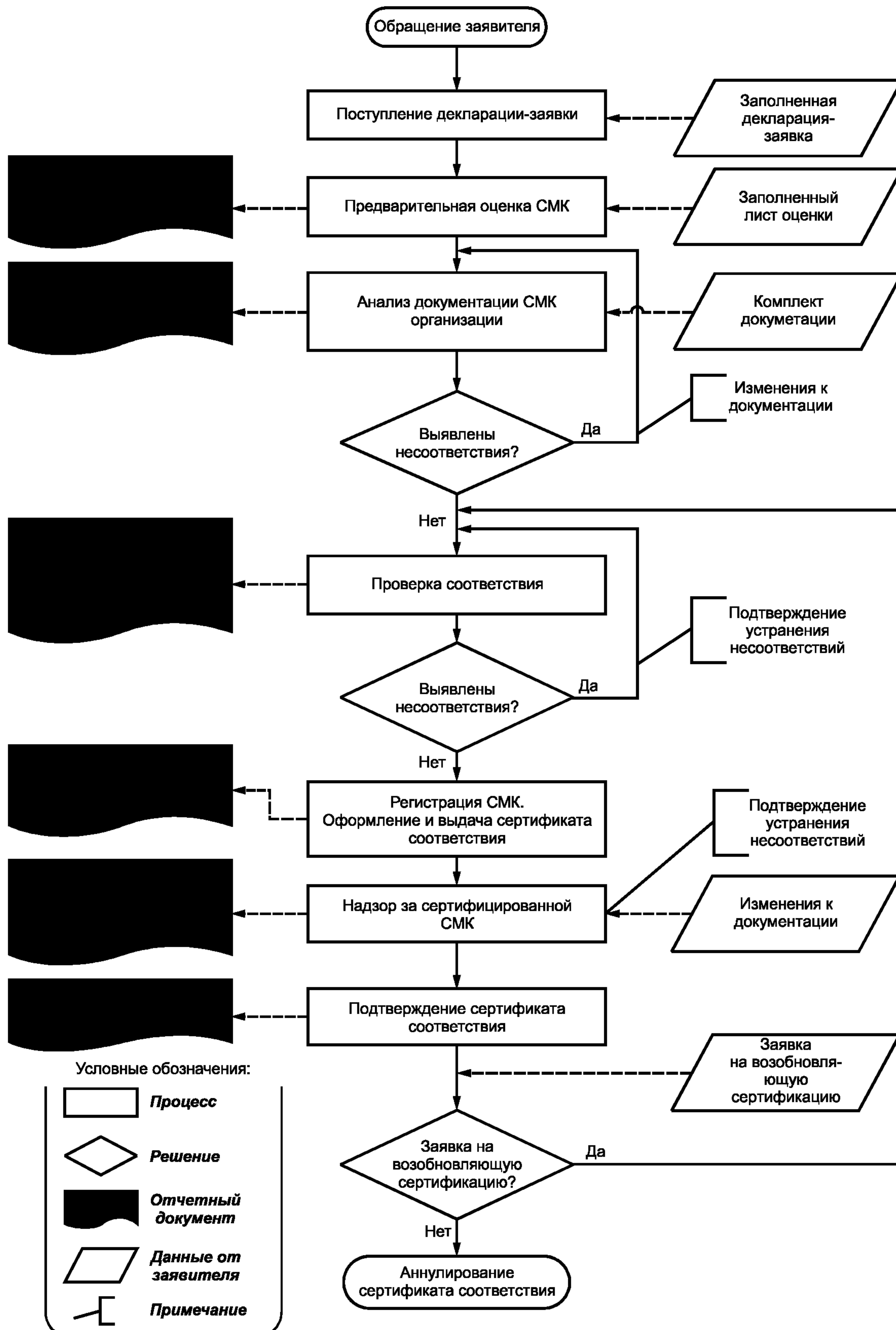
Рисунок 2 — Блок-схема сертификации СМК организаций автомобильной отрасли
