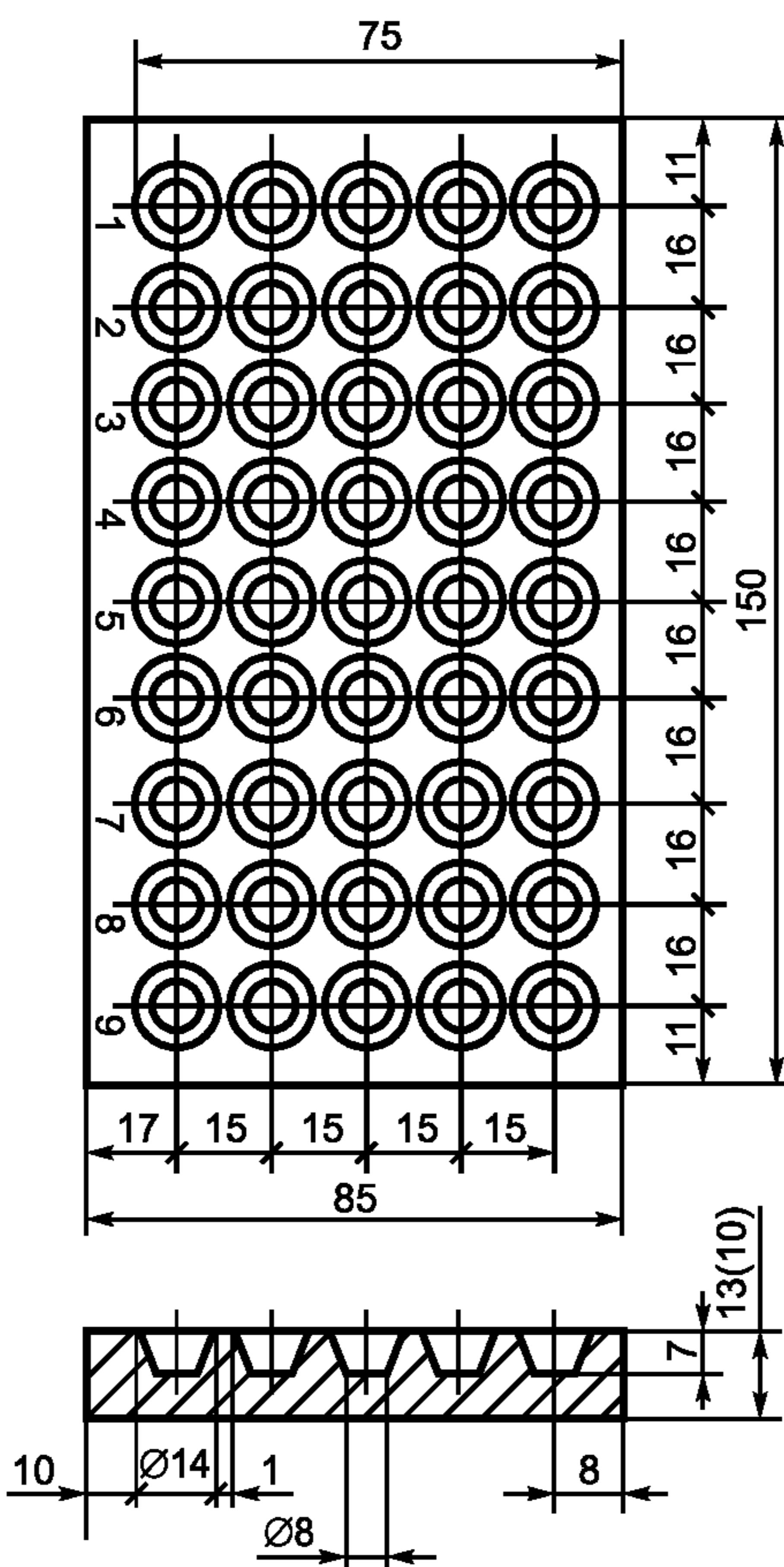
Рисунок 1 — Блок луночных микроаквариумов
