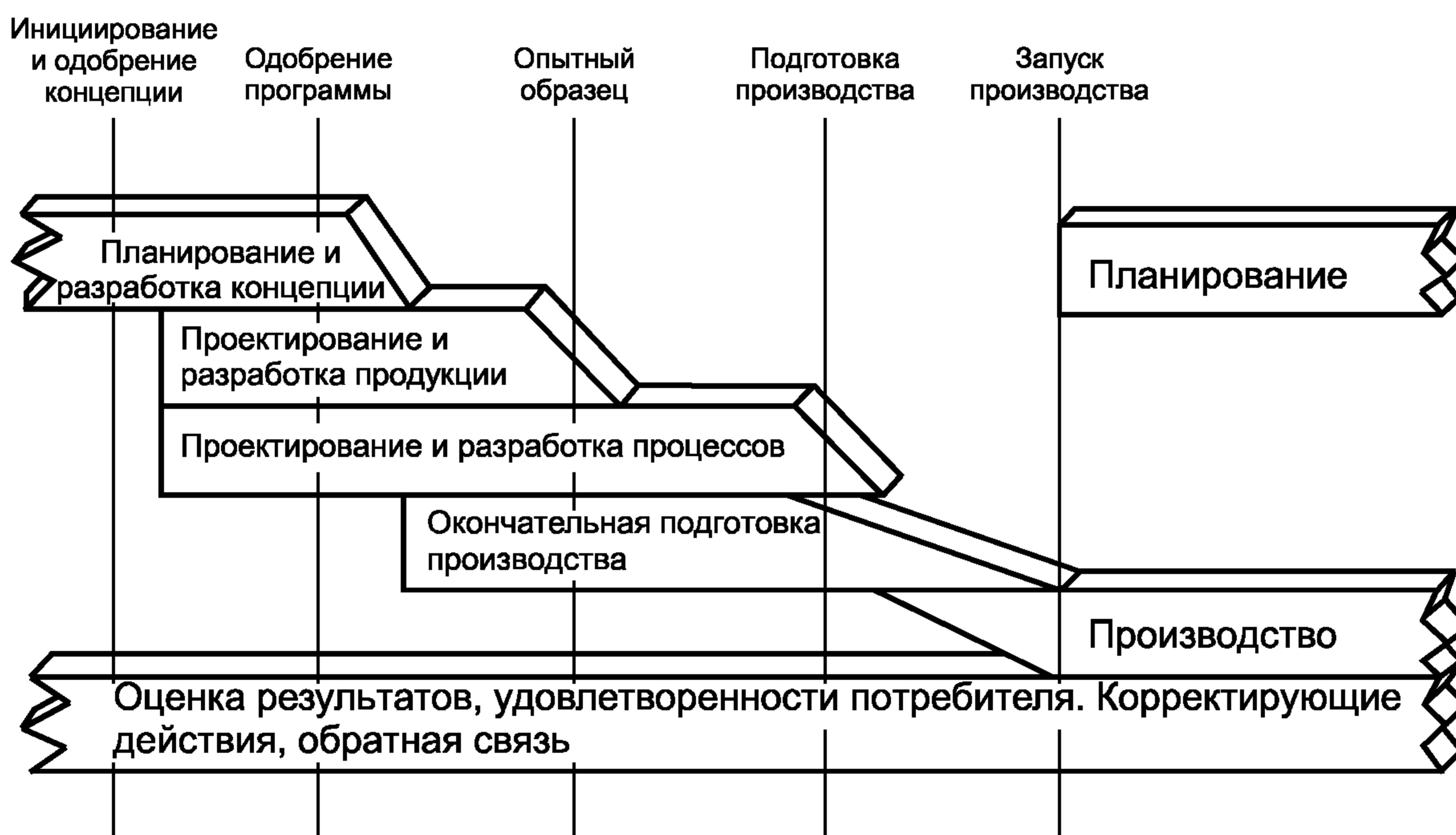
Рисунок 1 — Типовой временной график APQP-процесса
