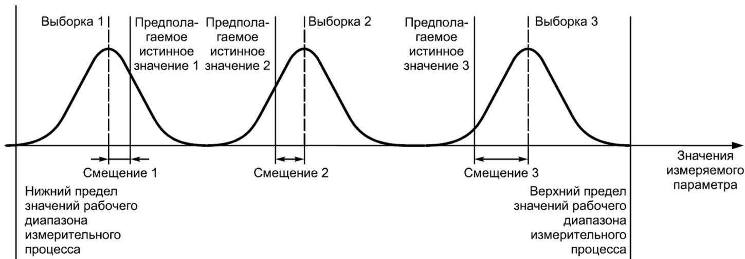
Рисунок 3 — Линейность смещения измерительного процесса
