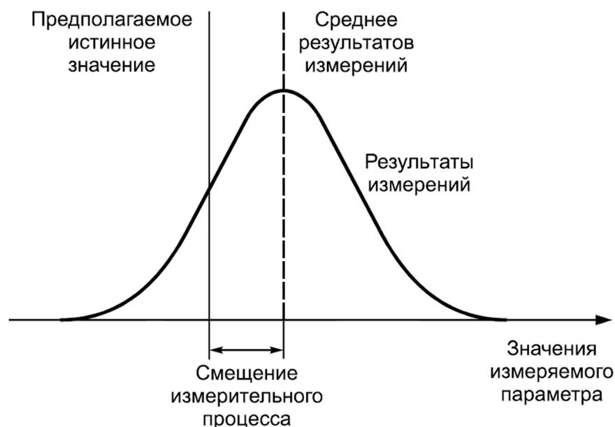
Рисунок 2 — Смещение измерительного процесса
