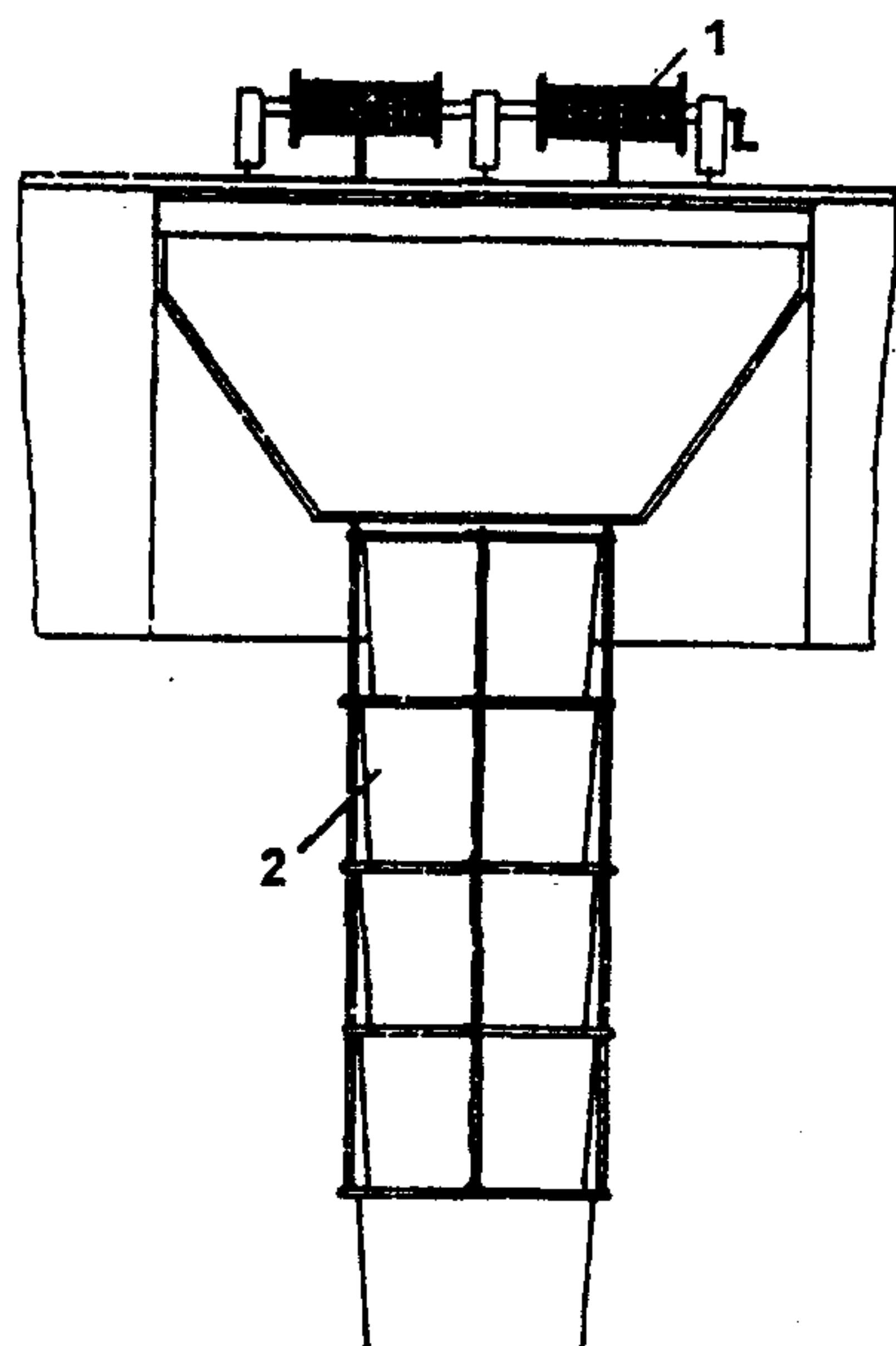
Использование такого бункера позволяет исключить загрязнение воды взмученным грунтом и нанесение этим ущерба ихтиофауне водоема и обеспечивает качественную обратную засыпку трубопровода в подводной траншее. Бункеры аналогичной конструкции могут применяться на малых и средних переходах, где предусмотрена засыпка с плавсредств.
