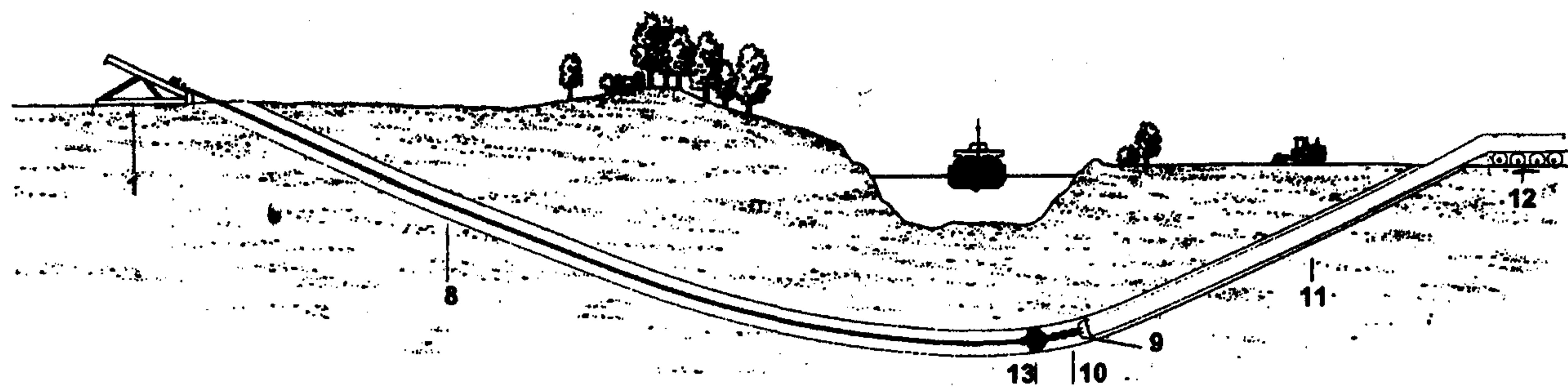
Протаскивание осуществляется через оставляемые в скважине обсадные трубы. Это определяется геологическими характеристиками и процессами в пройденных при бурении грунтах, а также транспортируемым продуктом (газ, нефть, конденсат и др.).
