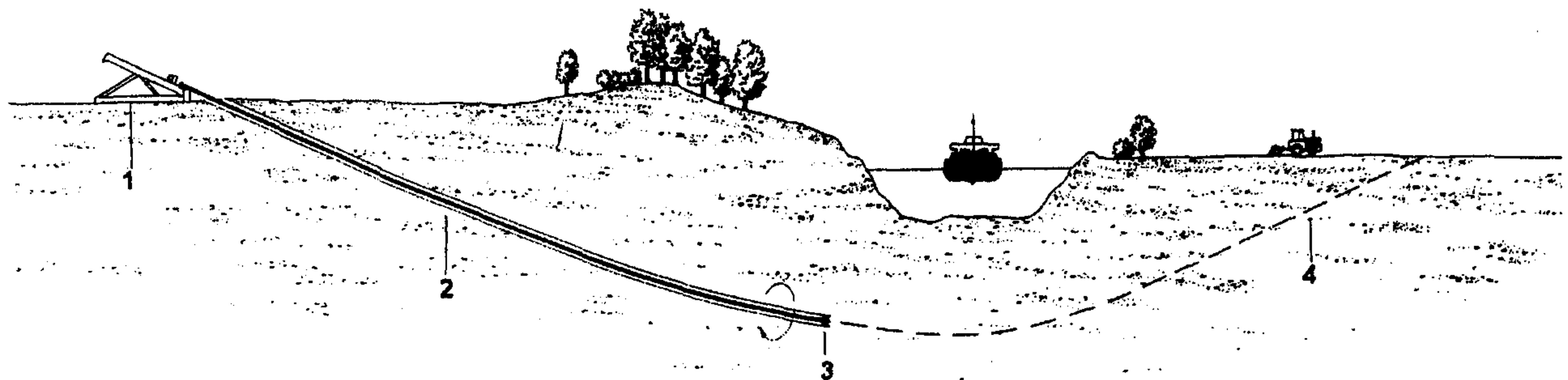
На первом этапе осуществляется бурение скважины малого диаметра для обеспечения точного профиля прокладки подводного трубопровода.
