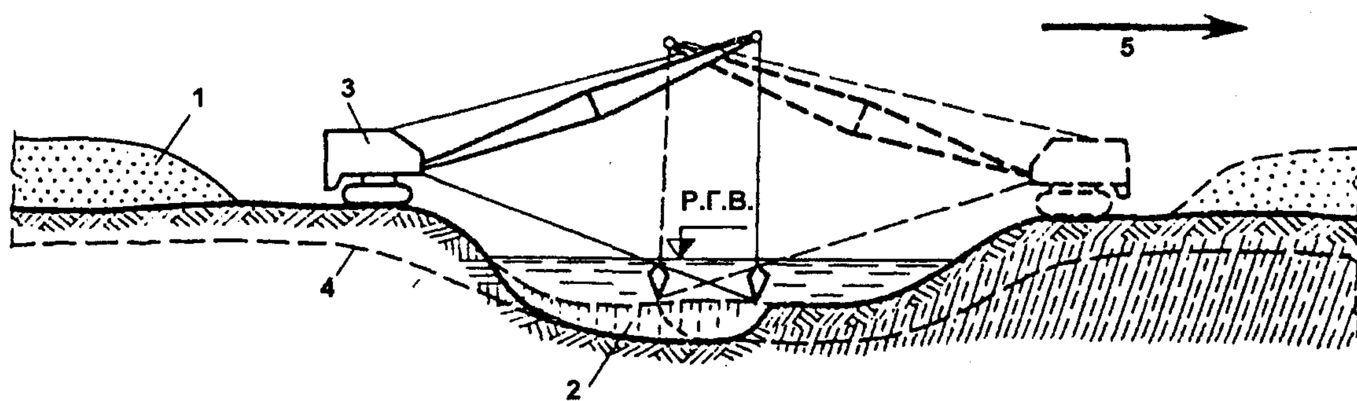
Схема 3 - болотным экскаватором
