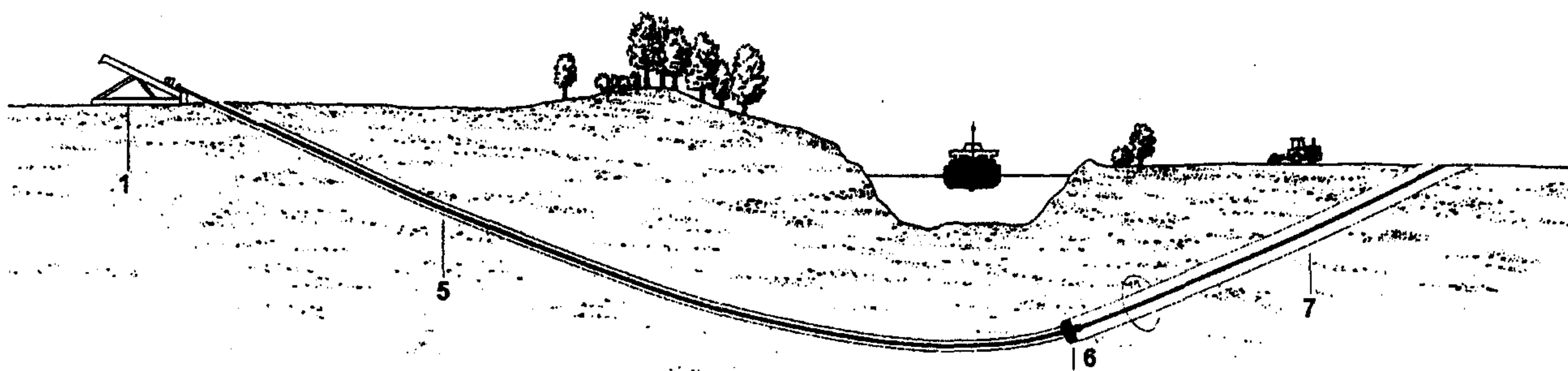
Расширение пробуренной на первом этапе скважины осуществляется бурением расширительными головками для достижения диаметра, превышающего диаметр укладываемого подводного трубопровода на 200 мм.
