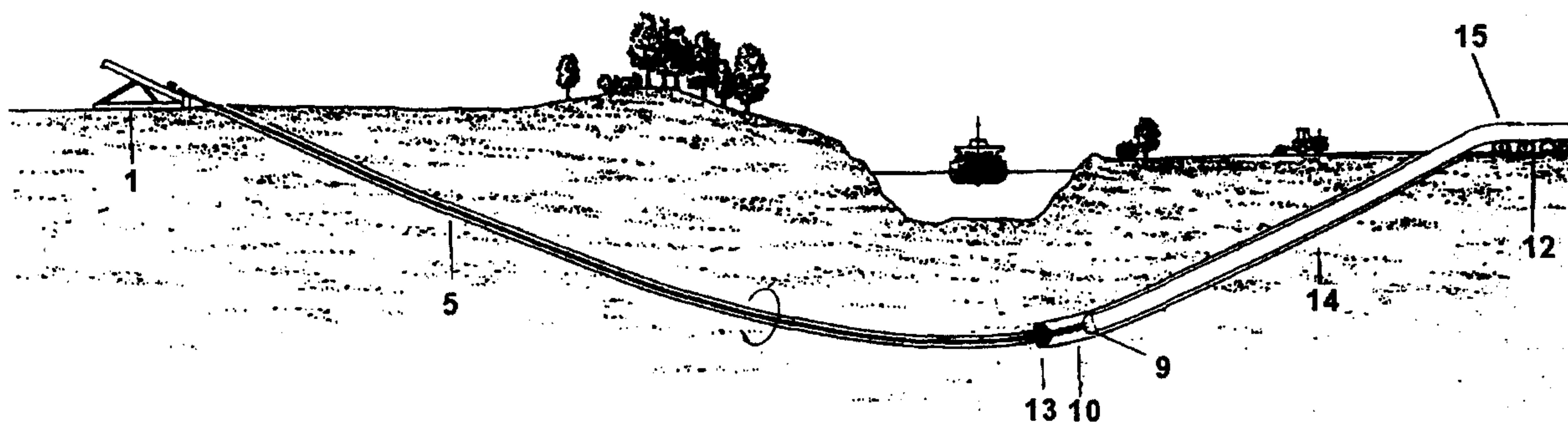
Прокладка может осуществляться и одновременно с расширением скважины. В этом случае после выхода установленной буровой колонны (схема этапа 1) на поверхность к ней присоединяется расширяющее скважину устройство. Между ним и трубопроводом крепится вертлюг для протаскивания.
