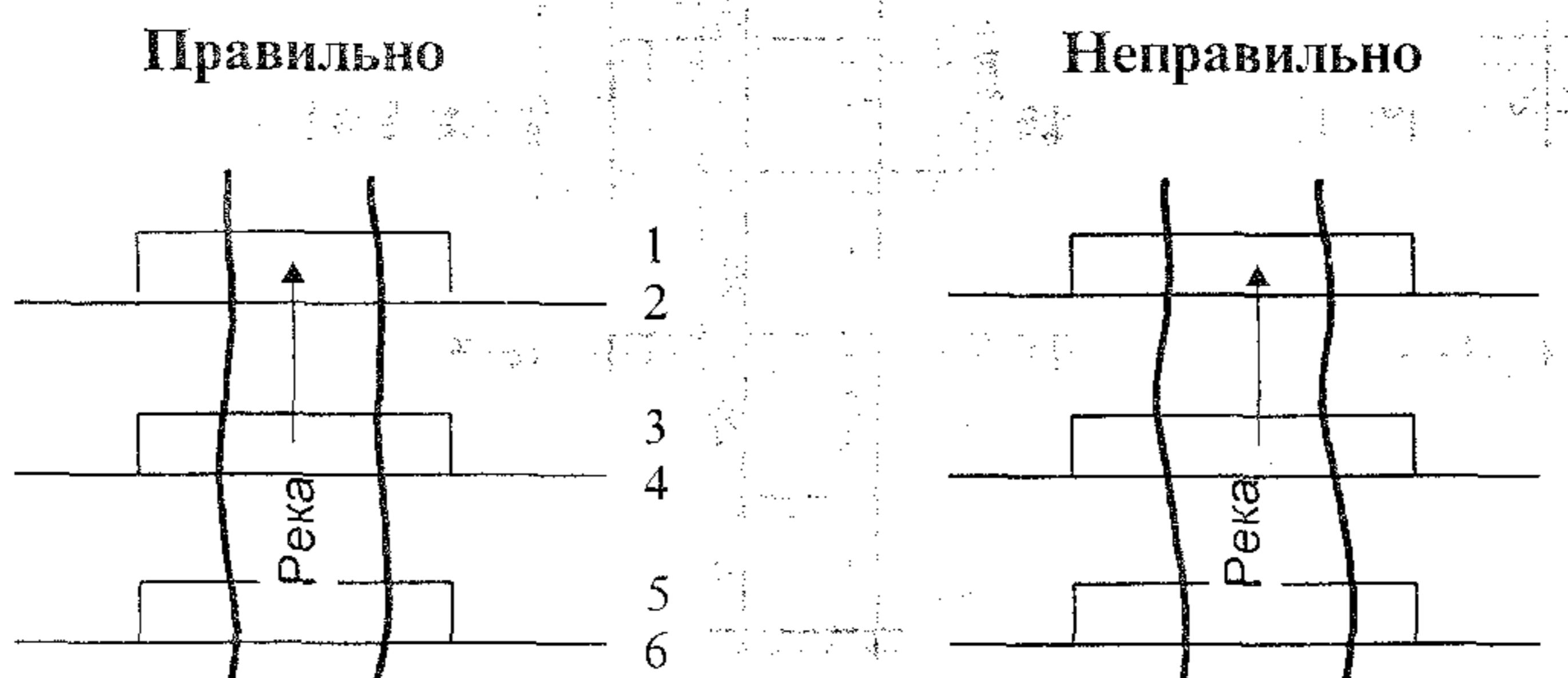
На схеме указаны расположения подводных переходов с основными и резервными нитками на одном участке реки: 1,2,3,4,5,6 - очередьность разработки траншей.
