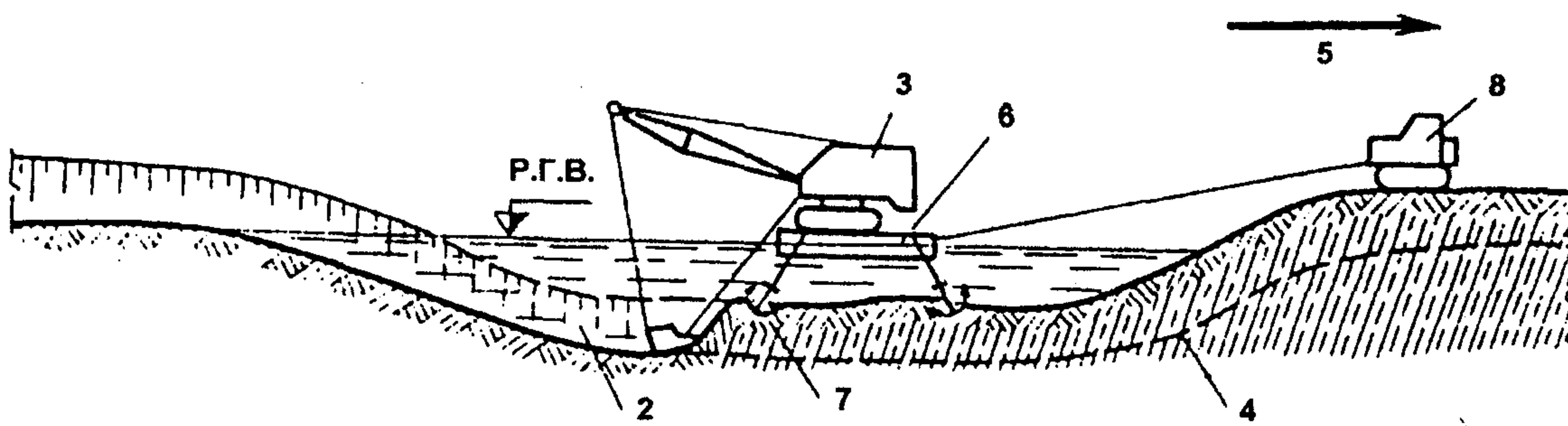
Схема 2 - экскаватором при глубине воды 0,5-2 м
