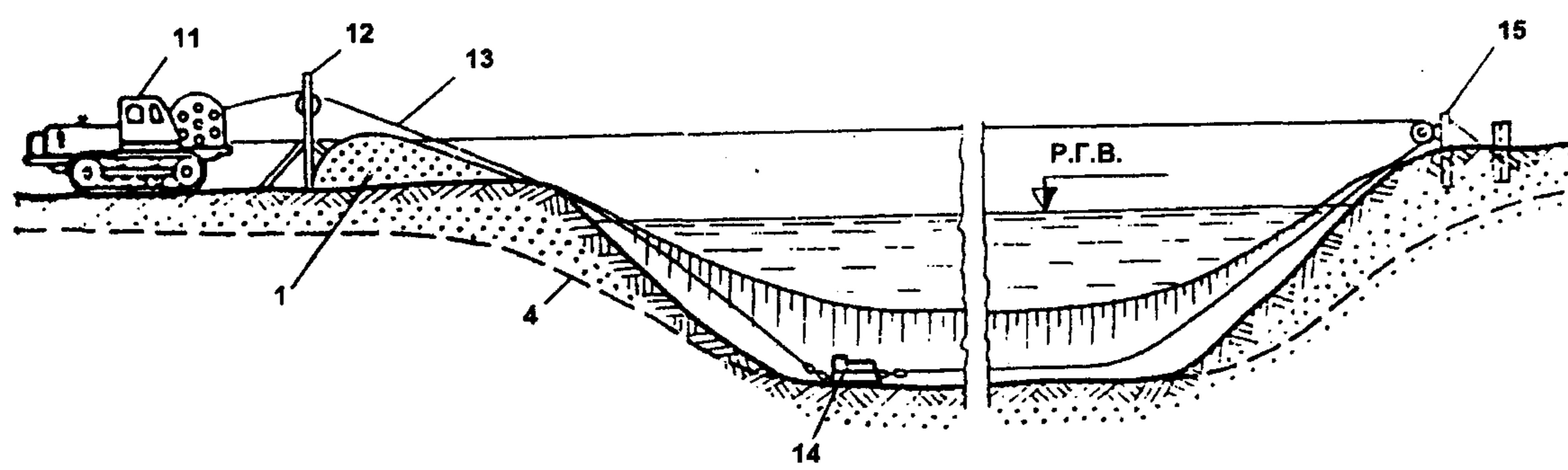
На схемах 1-6: 1 - отвал грунта; 2 - подводная траншея; 3 - экскаватор; 4 - проектное дно траншеи; 5 - направление разработки; 6 - понтоны; 7 - якорь; 8 - трактор; 9 - слани; 10 - спаренный ковш; 11 - трактор с однобарабанной лебедкой; 12 - головная опора; 13 - тяговый трос; 14 - скреперный ковш; 15 - хвостовая опора.
