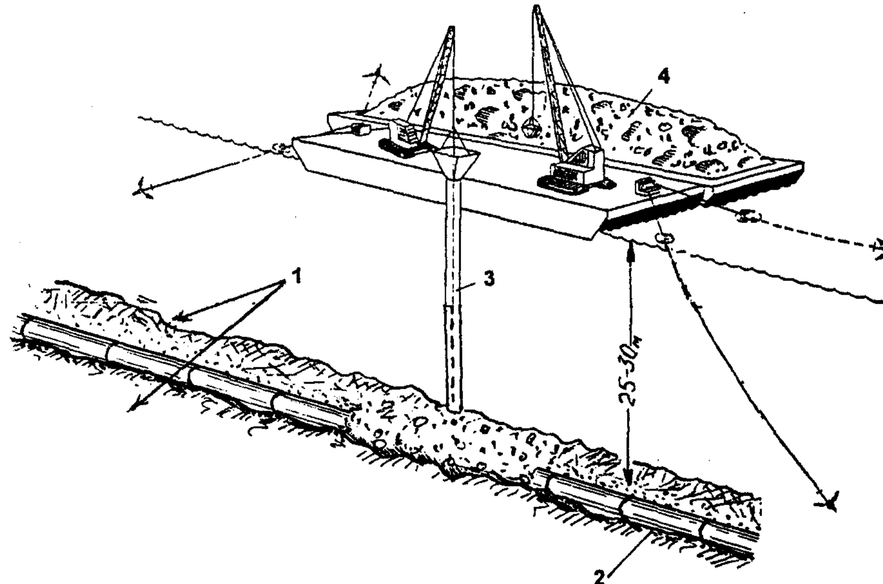
Обратная засыпка подводного трубопровода через направляющую трубу:
