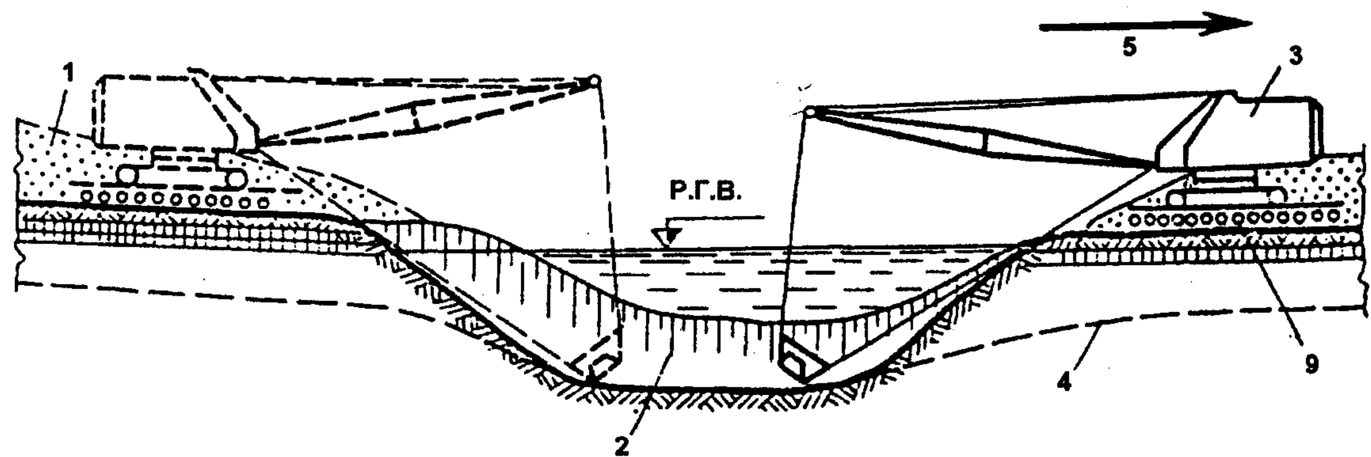
Схема 5 - двумя экскаваторами-драглайнами со спаренными ковшами
