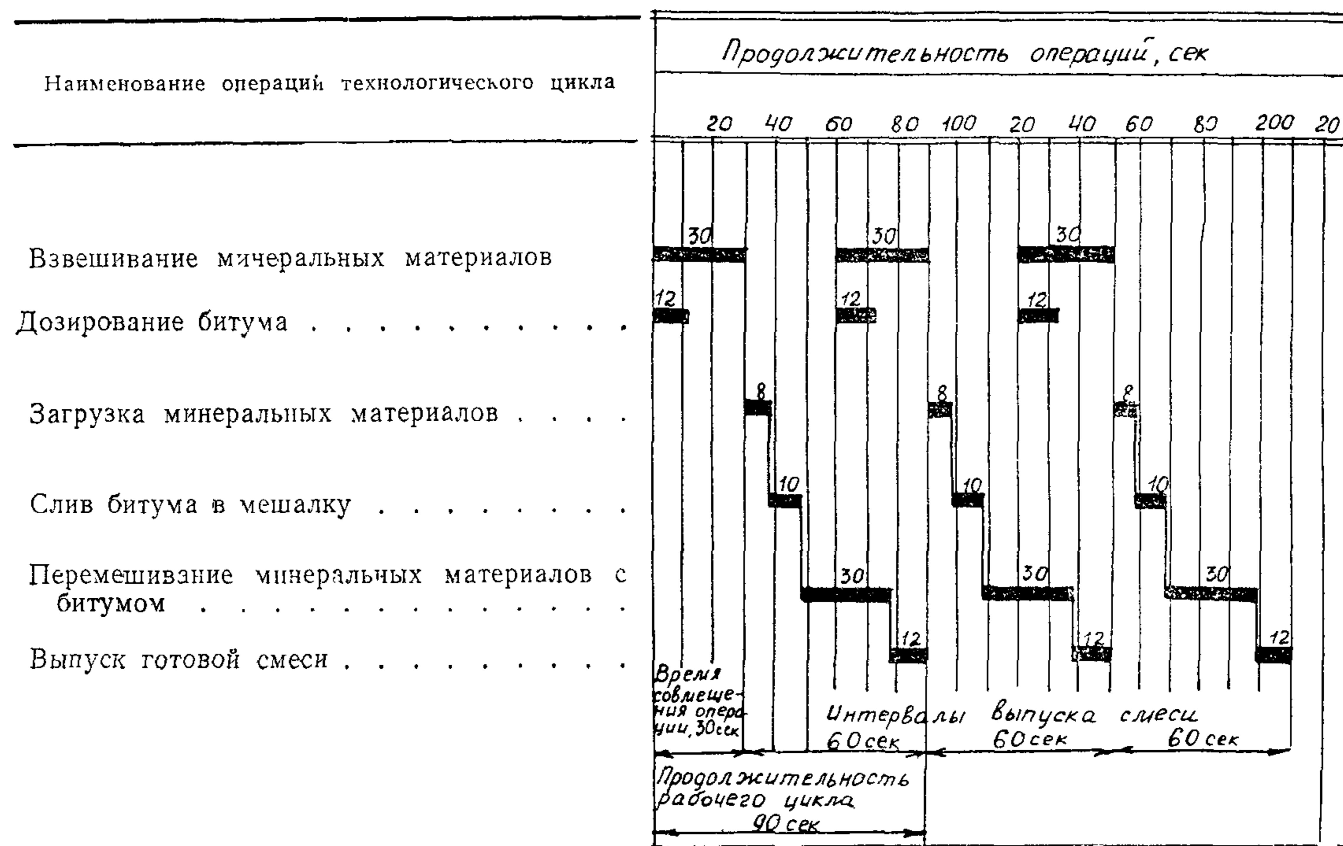
Количество замесов за 8-часовую смену при коэффициенте использования смесителя по времени  $K_v = 0,9$  равно  $\frac{8 \times 3600 \times 0,9}{60} = 432$ .
